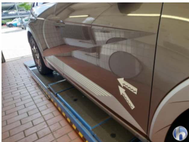
1. Tür Vorne - Rechts 2 Dellen - Sanft Instandsetzen
