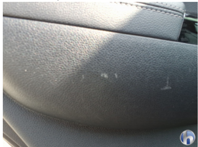
15. Verkleidung Kratzer - Smart Repair
