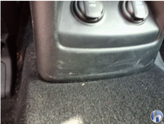
15. Verkleidung Kratzer - Smart Repair
