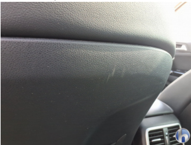
15. Verkleidung Kratzer - Smart Repair
