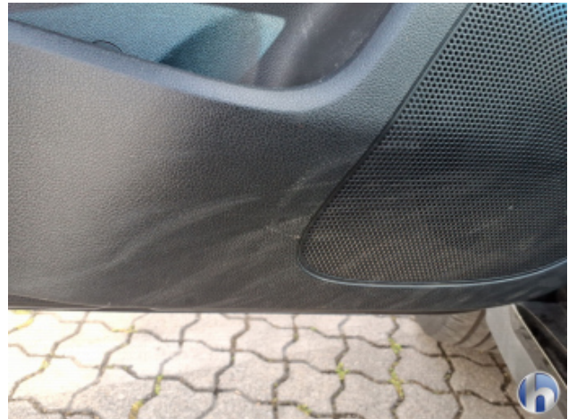
15. Verkleidung Kratzer - Smart Repair
