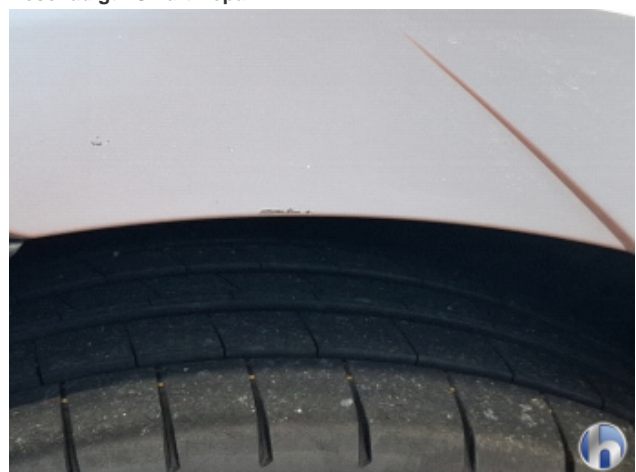
4. Seitenwand - Hinten - Rechts Abschürfung - Smart Repair
