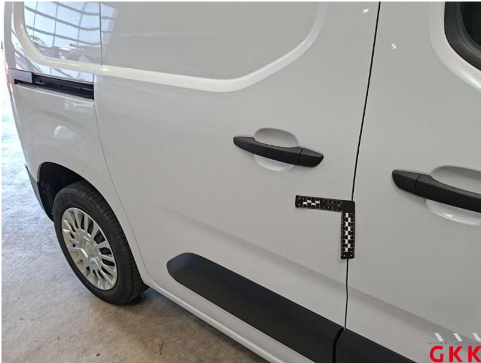
Bild 41. Schiebetür rechts, verkratzt, lackieren
