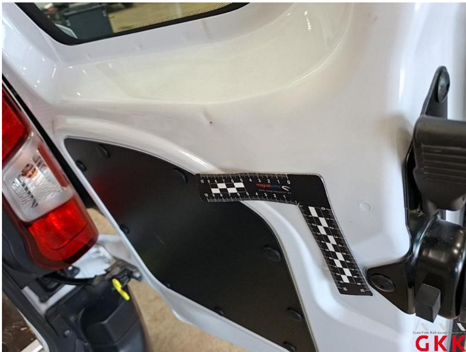
Bild 32. Hecktür rechts, innen, beschädigt, Smartrepair
