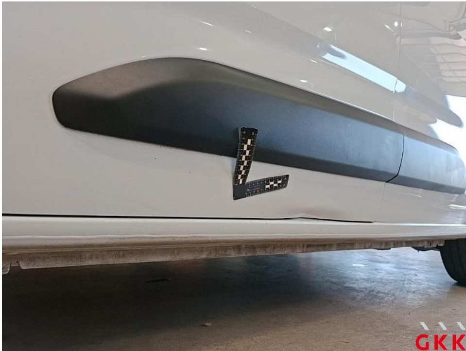
Bild 25. Tür vorne links, beschädigt, instand setzen - lackieren
