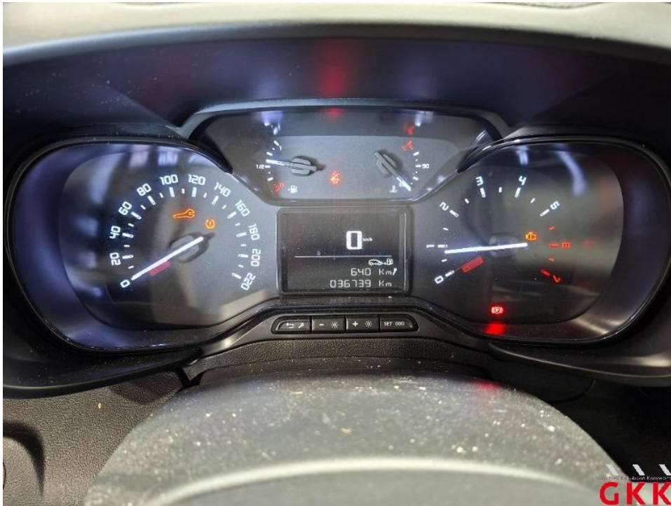
Bild 15. Kombiinstrument, Motorkontrollleuchte, aktiv, prüfen
