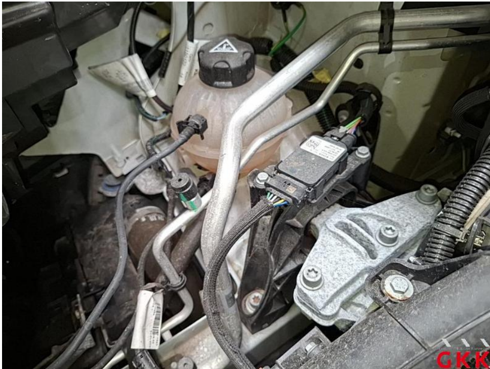
Bild 17. Kühlsystem, Kühlmittelstand, unter Minimum, prüfen
