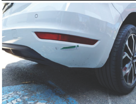
Stoßfänger / Hinten / Abgewetzt
