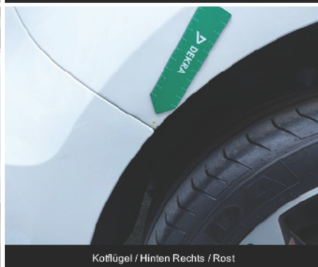
Kotflügel / Hinten Rechts / Rost
