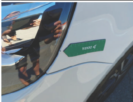
Kotflügel / Vorne Links / Steinschlag
