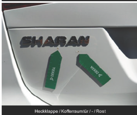
Heckklappe / Kofferraumtür / - / Rost
