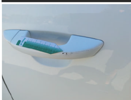
Türgriff Außen / Hinten Links / Kratzer
