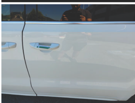
Türgriff Außen / Hinten Links / Kratzer
