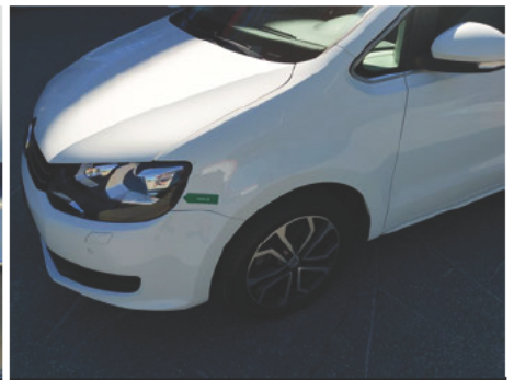
Kotflügel / Vorne Links / Steinschlag
