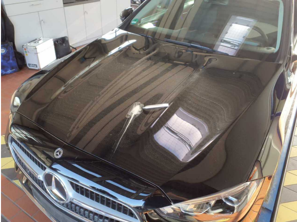
Beschädigung #1: Motorhaube: Motorhaube (Umwelteinflüsse) - Lackmangel - aufbereiten
