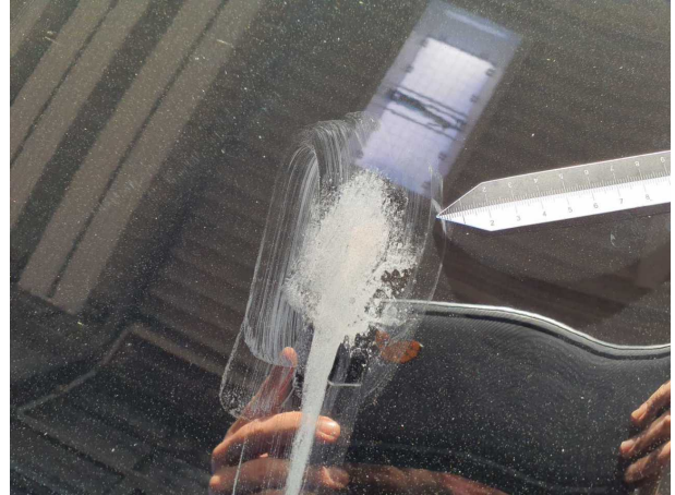
Beschädigung #1: Motorhaube: Motorhaube (Umwelteinflüsse) - Lackmangel - aufbereiten
