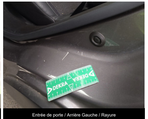
Entrée de porte / Arrière Gauche / Rayure
