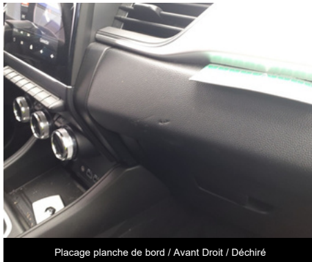
Placage planche de bord / Avant Droit / Déchiré
