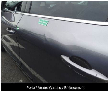
Porte / Arrière Gauche / Enfoncement
