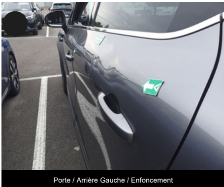
Porte / Arrière Gauche / Enfoncement
