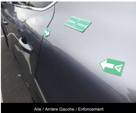
Aile / Arrière Gauche / Enfoncement
