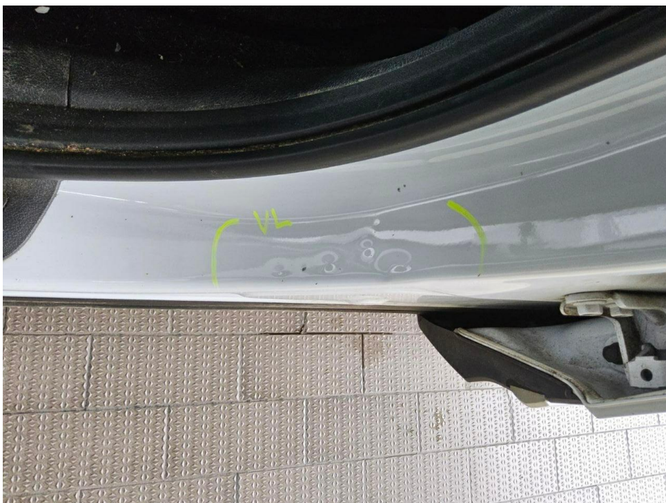
Bild 20 : Tür vorne links Einstieg, mehrfach eingedellt, instandsetzen und lackieren mit Lackaufbau
