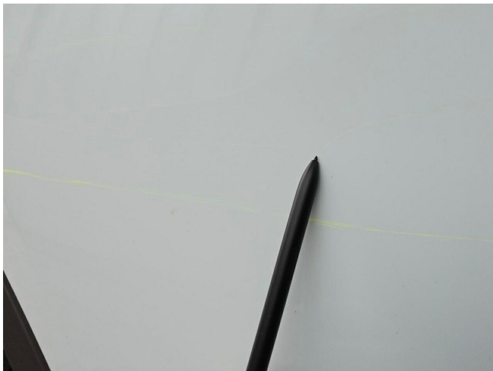
Bild 26 : Tür hinten rechts Lackierung, zerkratzt, lackieren
