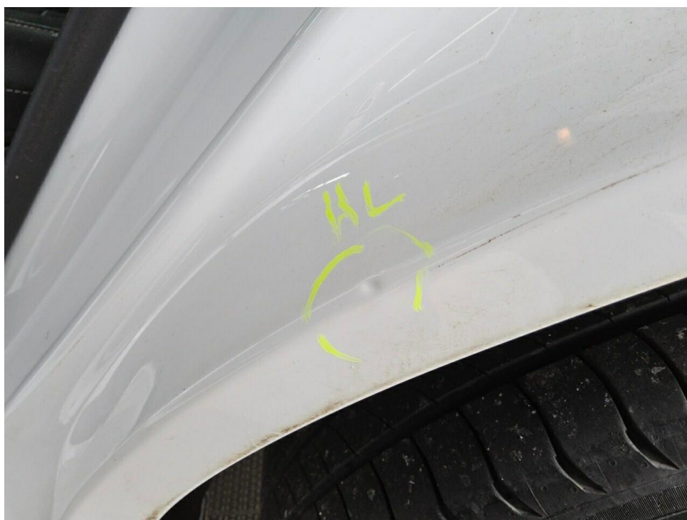
Bild 22 : Tür hinten links Einstieg, eingedellt, drücken
