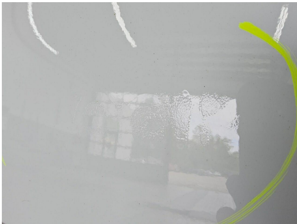
Bild 30 : Heckklappe Lackierung, fleckig, lackieren
