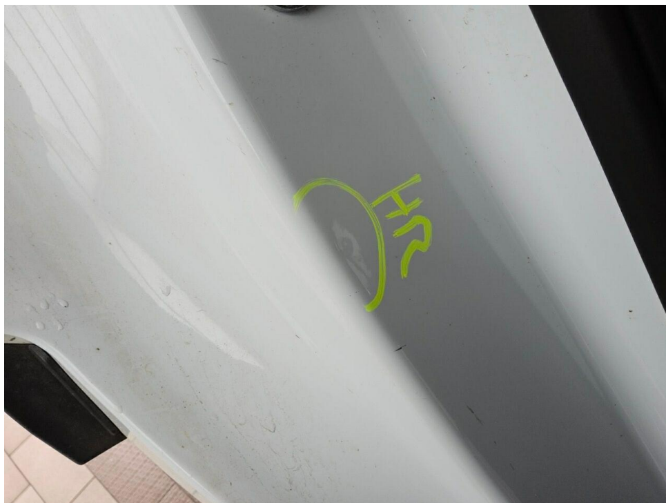
Bild 23 : Tür hinten rechts Einstieg, eingedellt, Gebrauchsspur
