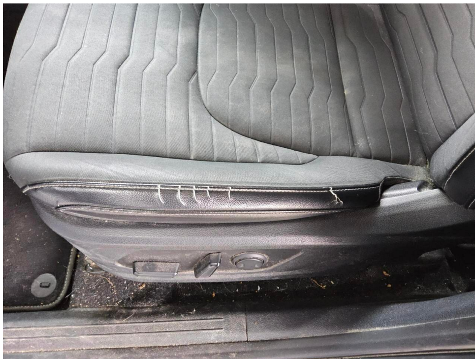
Bild 17 : Sitz vorne links Sitzbezug, gerissen, erneuern
