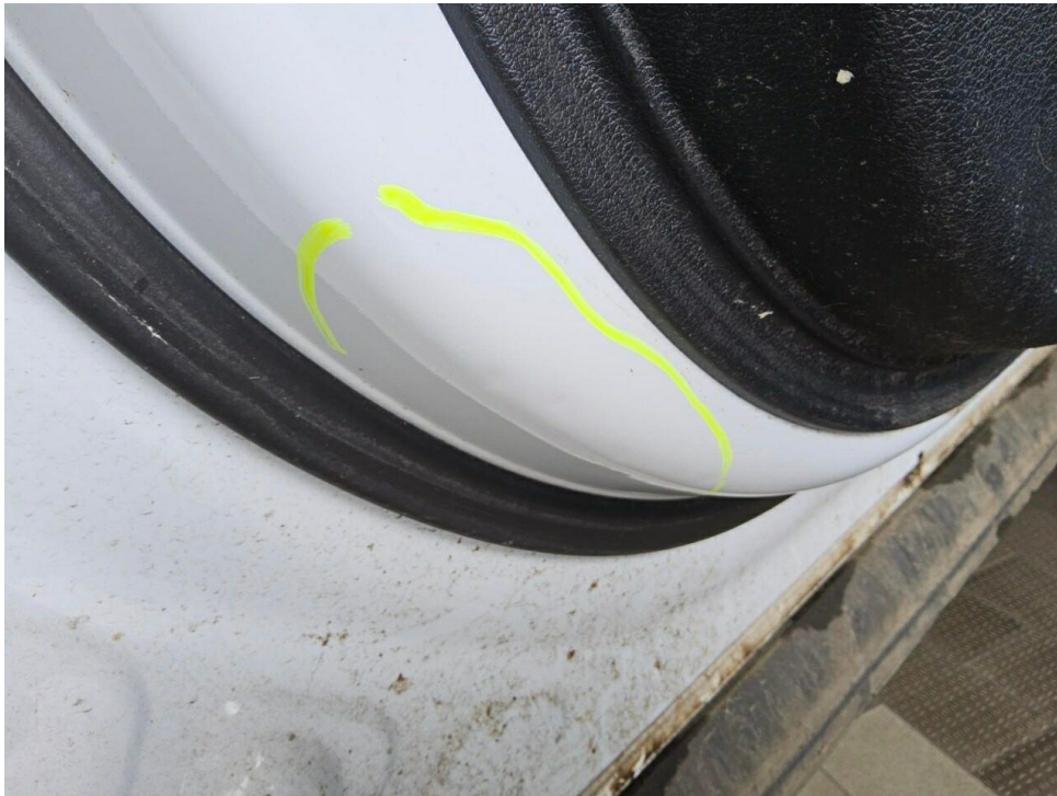
Bild 19 : Tür vorne links Einstieg, mehrfach eingedellt, instandsetzen und lackieren mit Lackaufbau
