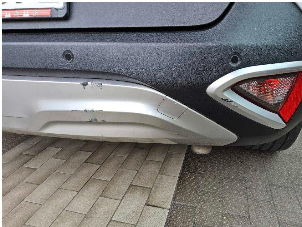
Bild 10 : Stoßfänger hinten rechts unterhalb eingekerbt
