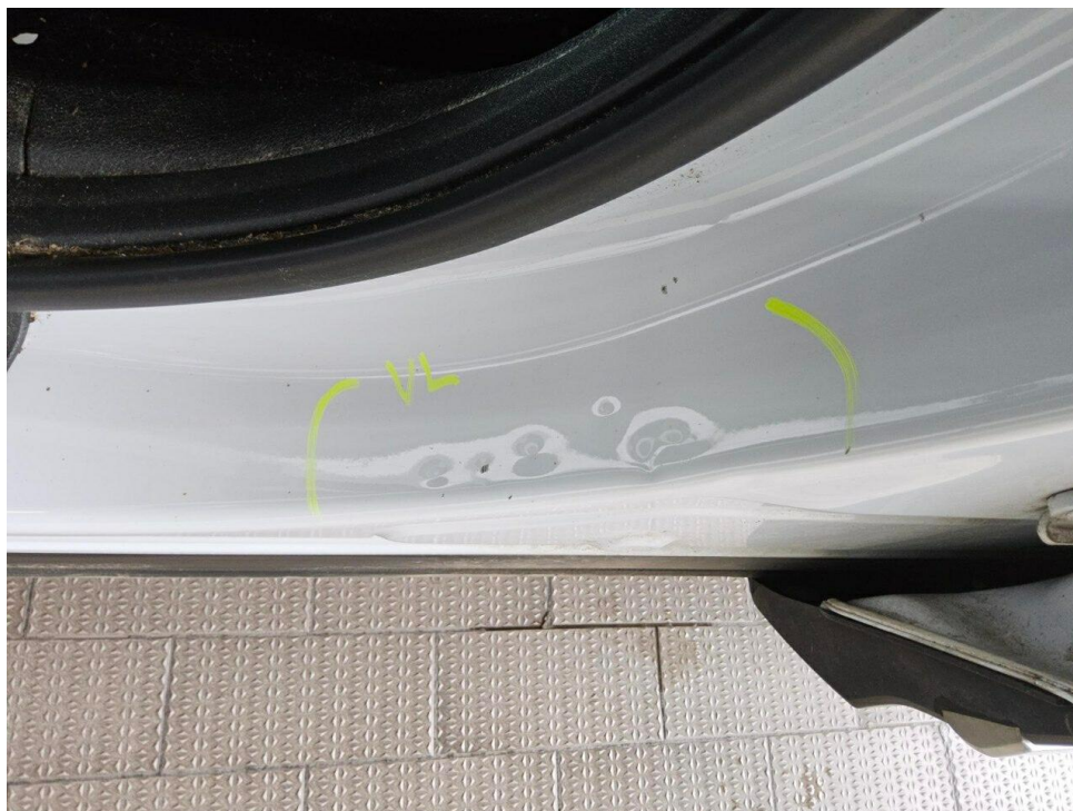
Bild 21 : Tür vorne links Einstieg, mehrfach eingedellt, instandsetzen und lackieren mit Lackaufbau
