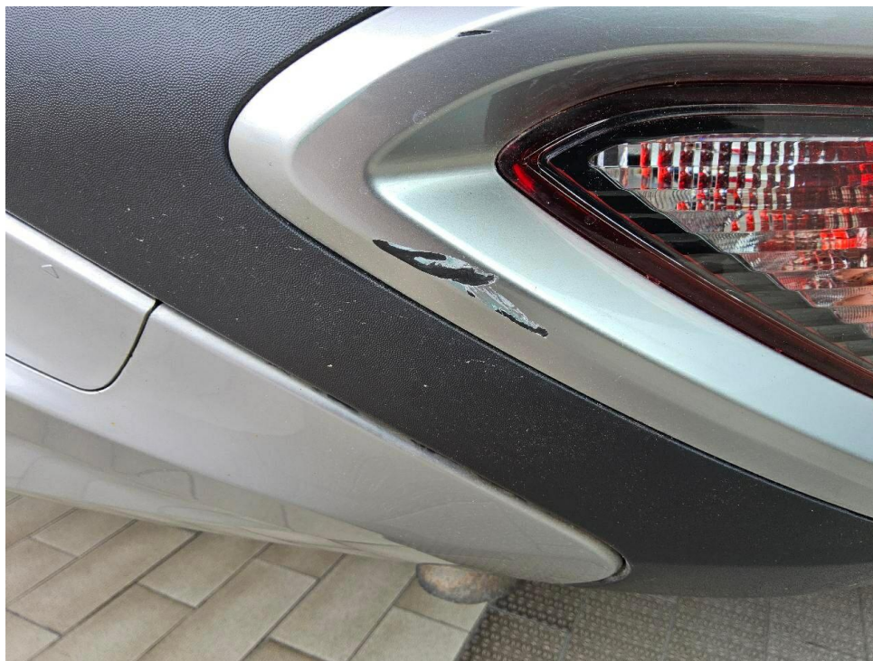
Bild 12 : Stoßfänger hinten rechts unterhalb eingekerbt
