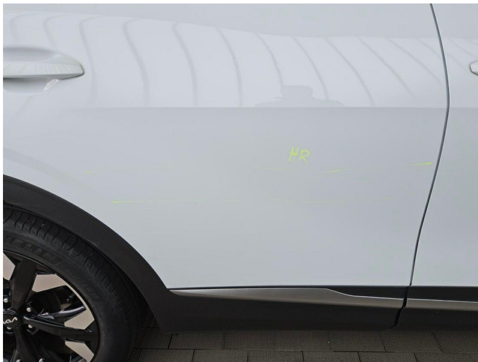
Bild 24 : Tür hinten rechts Lackierung, zerkratzt, lackieren
