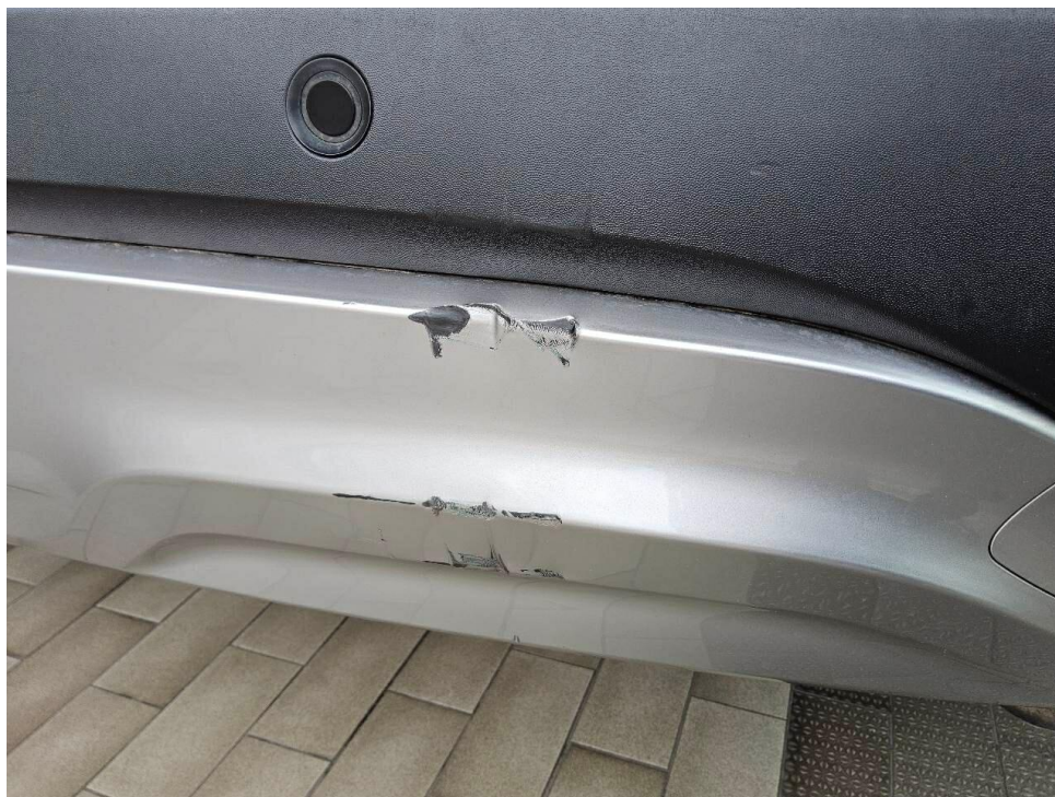
Bild 11 : Stoßfänger hinten rechts unterhalb eingekerbt
