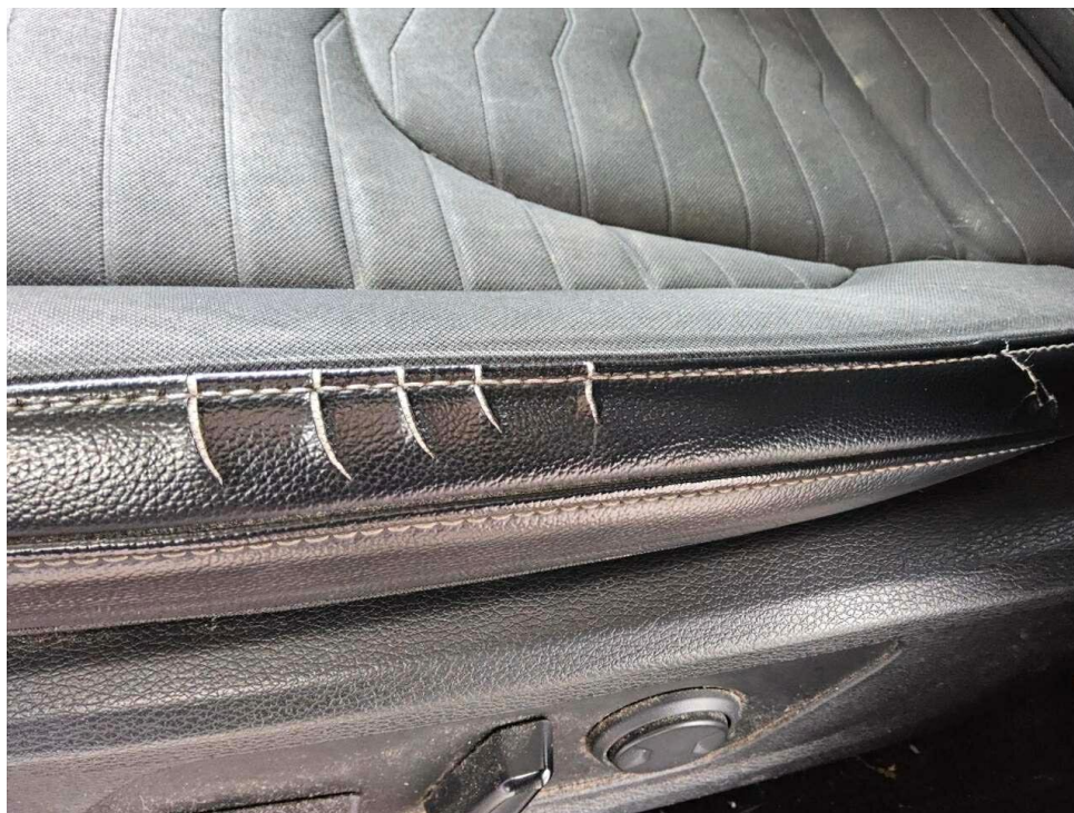
Bild 18 : Sitz vorne links Sitzbezug, gerissen, erneuern
