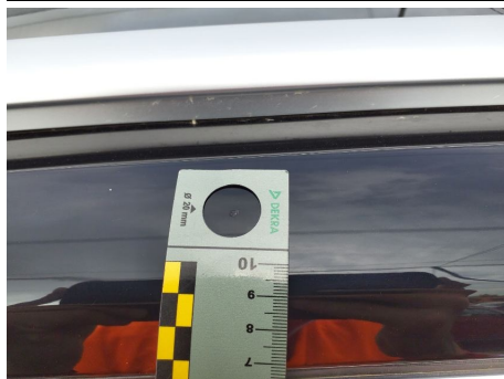
Montante tetto / Sinistro / Graffio
