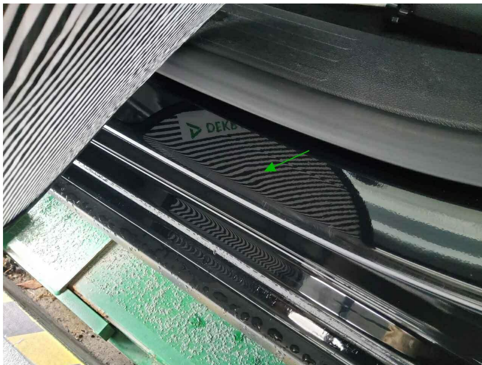
Bild 18 : Türeinstieg vorne links, zerkratzt und eingedellt
