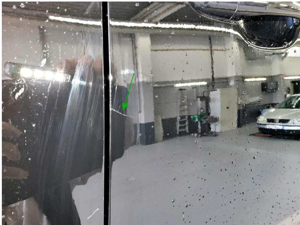
Bild 20 : Tür hinten links, zerkratzt
