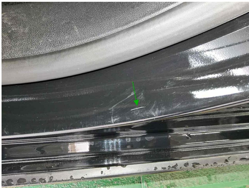
Bild 17 : Türeinstieg vorne links, zerkratzt
