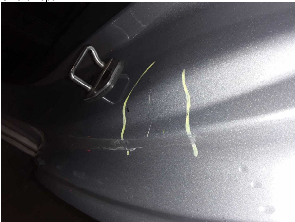
Beschädigung #3: Seitenwand links: Einstieg - verkratzt / verschürft - Smart Repair
