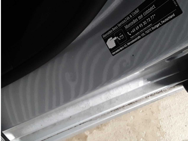
Beschädigung #2: Schweller links: Einstieg (vorne) - Delle(n) - Smart Repair
