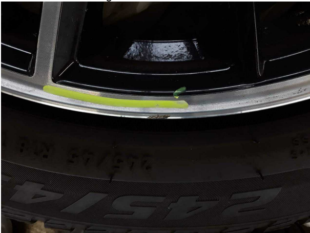
Beschädigung #1: 2.Radsatz: 2 Leichtmetallfelgen - verkratzt / verschürft - kein Abzug
