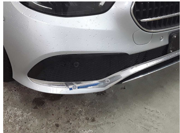
Damage #4: Front bumper: Protection strip - right side (Beschichtung löst sich) - Replace
