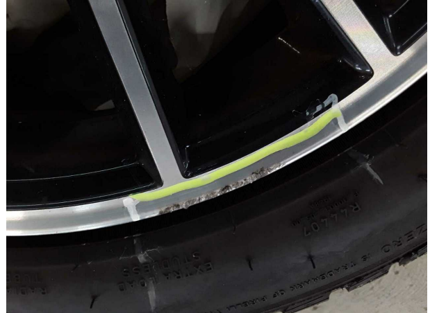
Beschädigung #1: 2.Radsatz: 2 Leichtmetallfelgen - verkratzt / verschürft - kein Abzug
