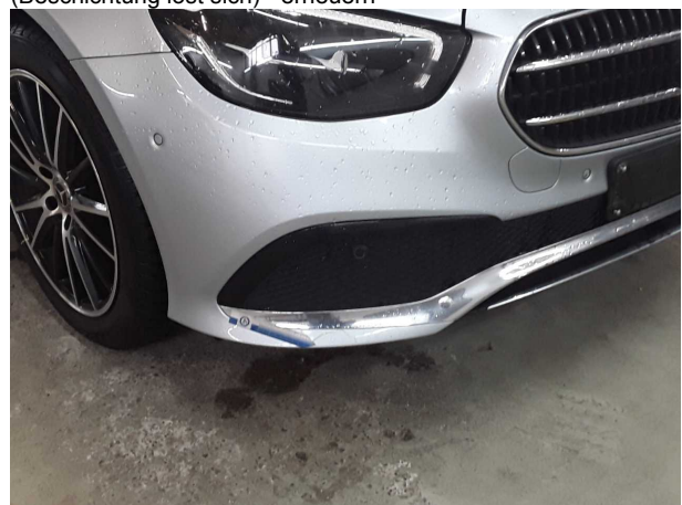
Beschädigung #5: Stoßfänger vorn: Stoßfänger vorn - verkratzt / verschürft - instandsetzen und lackieren
