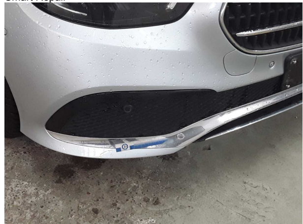
Beschädigung #4: Stoßfänger vorn: Schutzleiste rechts (Beschichtung löst sich) - erneuern
