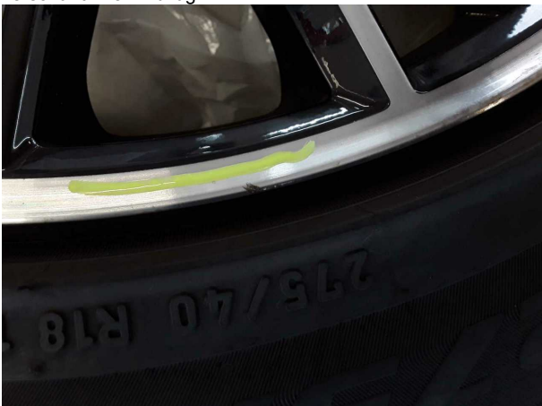
Beschädigung #1: 2.Radsatz: 2 Leichtmetallfelgen - verkratzt / verschürft - kein Abzug
