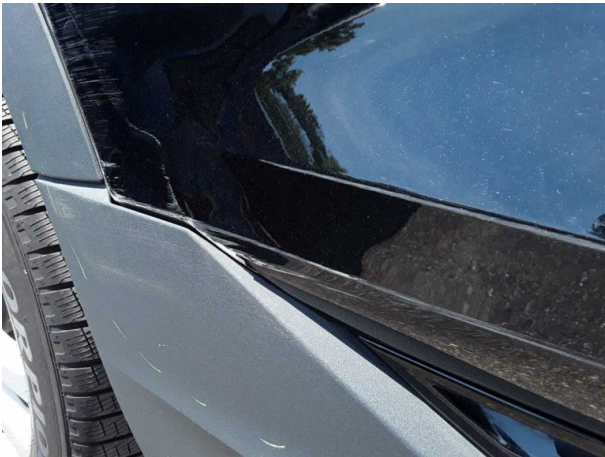
Beschädigung #7: Tür hinten rechts: Tür - verformt - erneuern
