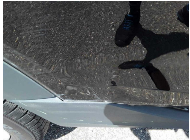
Beschädigung #7: Tür hinten rechts: Tür - verformt - erneuern
