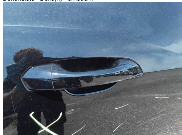
Beschädigung #4: Tür hinten rechts: Griff außen - verkratzt / verschürft - Smart Repair
