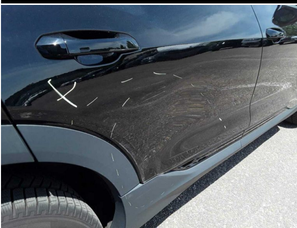
Beschädigung #7: Tür hinten rechts: Tür - verformt - erneuern
