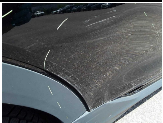
Beschädigung #7: Tür hinten rechts: Tür - verformt - erneuern
