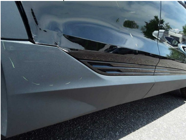
Beschädigung #5: Tür hinten rechts: Zierleiste unten - verkratzt / verschürft - erneuern
