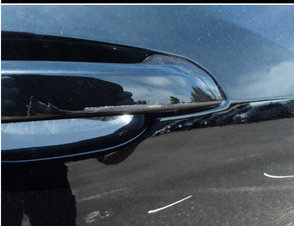
Beschädigung #4: Tür hinten rechts: Griff außen - verkratzt / verschürft - Smart Repair
