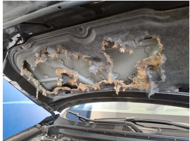
Beschädigung #1: Motorhaube: Dämmmatte - Marderschaden - erneuern
