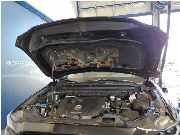
Beschädigung #1: Motorhaube: Dämmmatte - Marderschaden - erneuern
