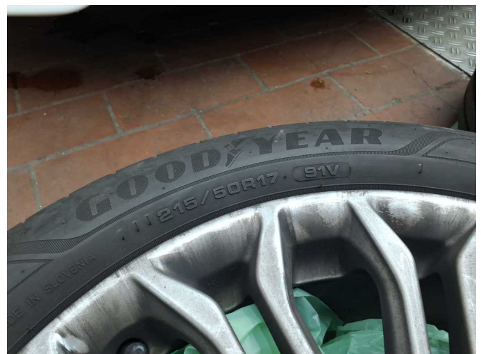
Damage 7: 2nd wheel set: 2 tyres (einseitig abgefahren) - Worn - Replace
