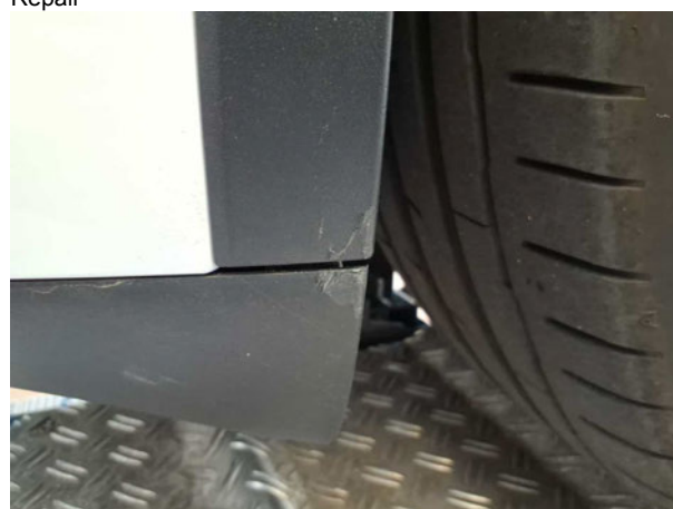
Beschädigung #3: Kotflügel links: Radhausverbreiterung - Kratzer - Wertminderung
