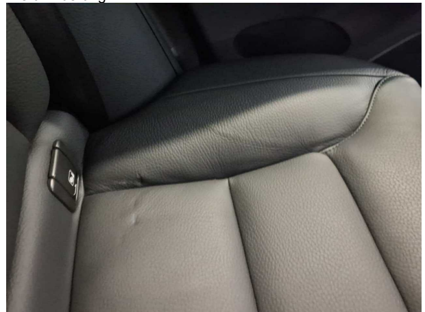
Beschädigung #4: Sitz hinten: Sitzbezug - verformt - Wertminderung
