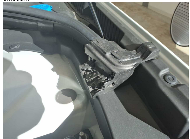
Beschädigung #1: Motor: Motorabdeckung - Marderschaden - erneuern
