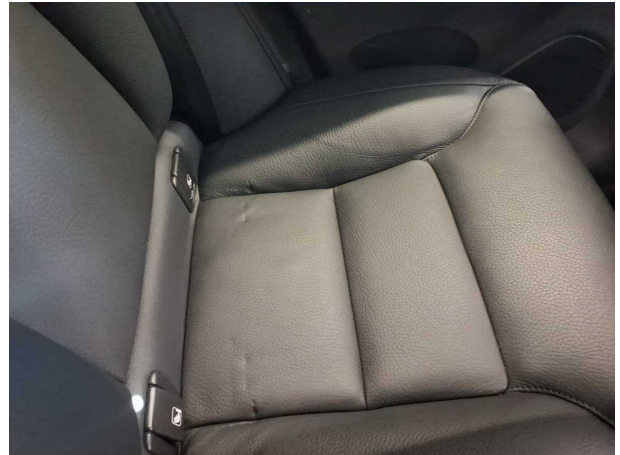
Beschädigung #4: Sitz hinten: Sitzbezug - verformt - Wertminderung
