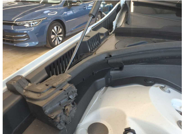
Beschädigung #1: Motor: Motorabdeckung - Marderschaden - erneuern
