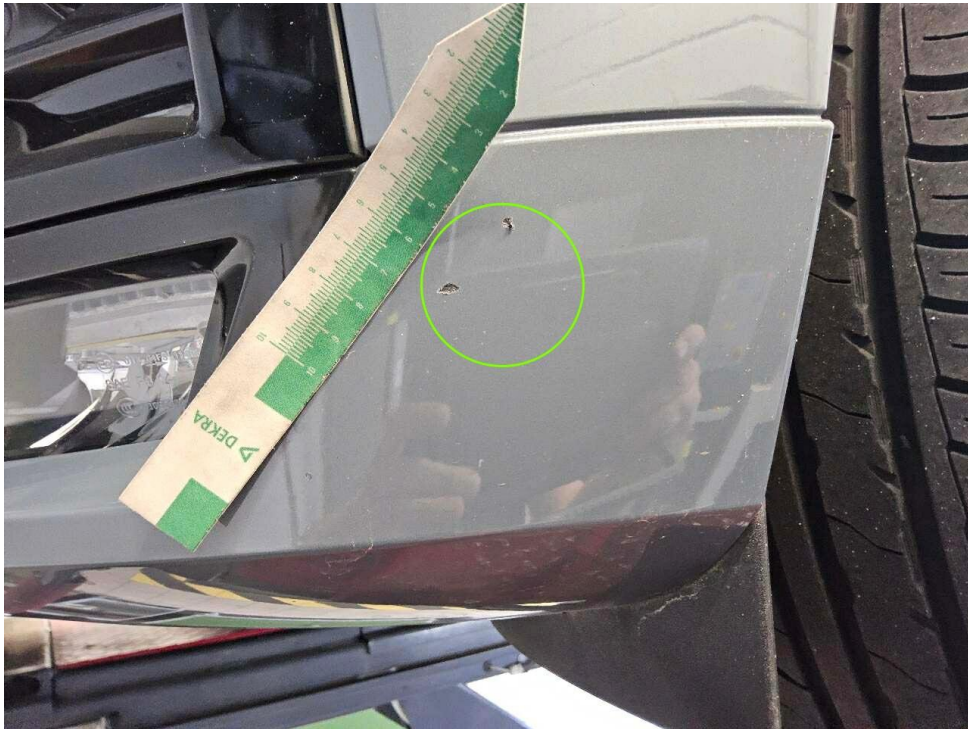
Bild 21 : Stoßfängerabdeckung vorne links,Steinschlag
