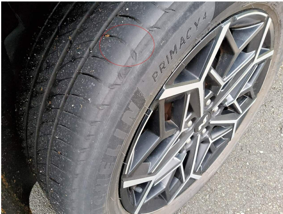
Bild 16 : 2 Reifen HA unter 3mm Profiltiefe /einseitiger Verschleiß/Achsvermessung
