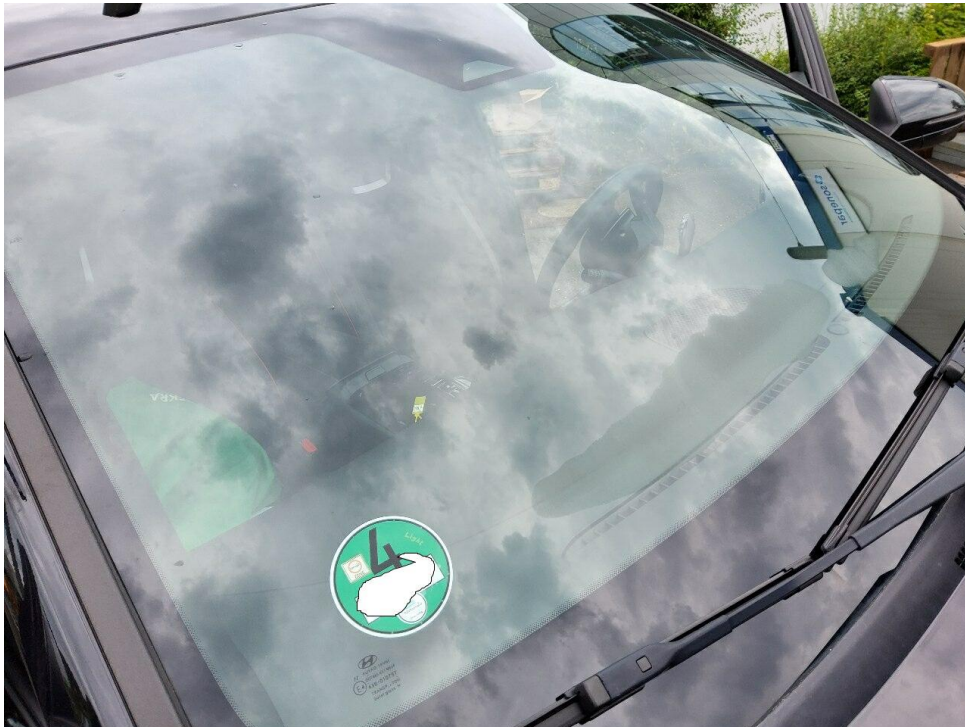
Bild 15 : Frontscheibe: Steinschlag mit Rißbildung
