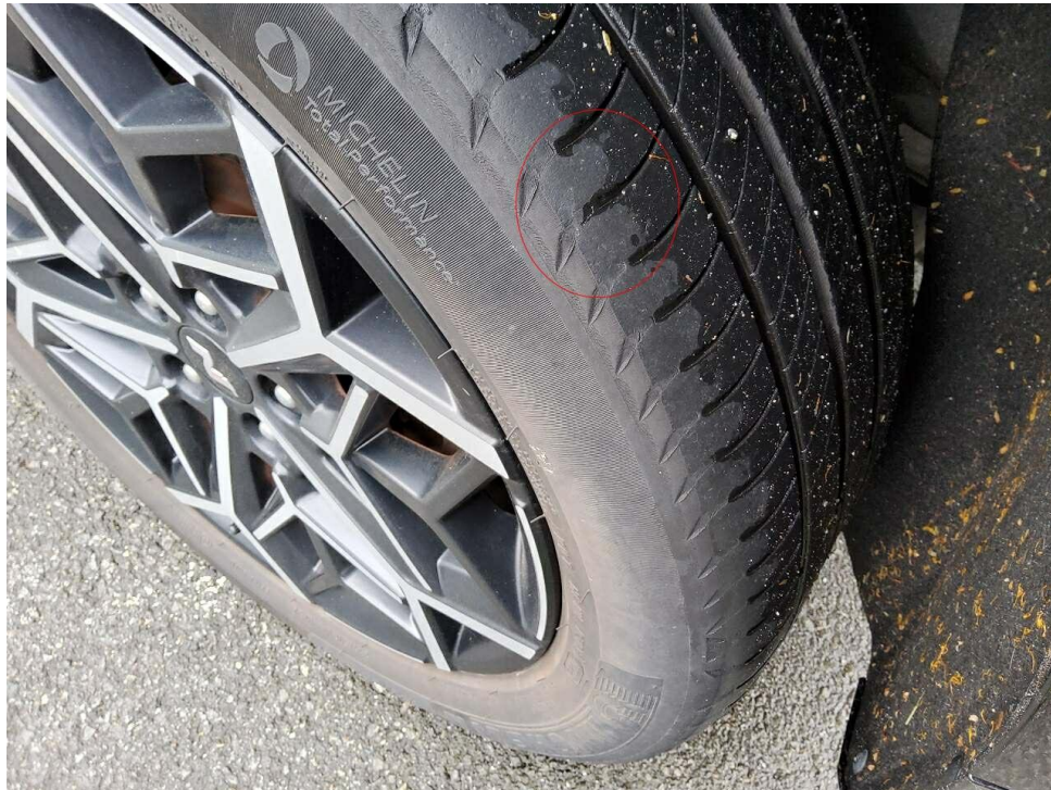
Bild 17 : 2 Reifen HA unter 3mm Profiltiefe /einseitiger Verschleiß/Achsvermessung
