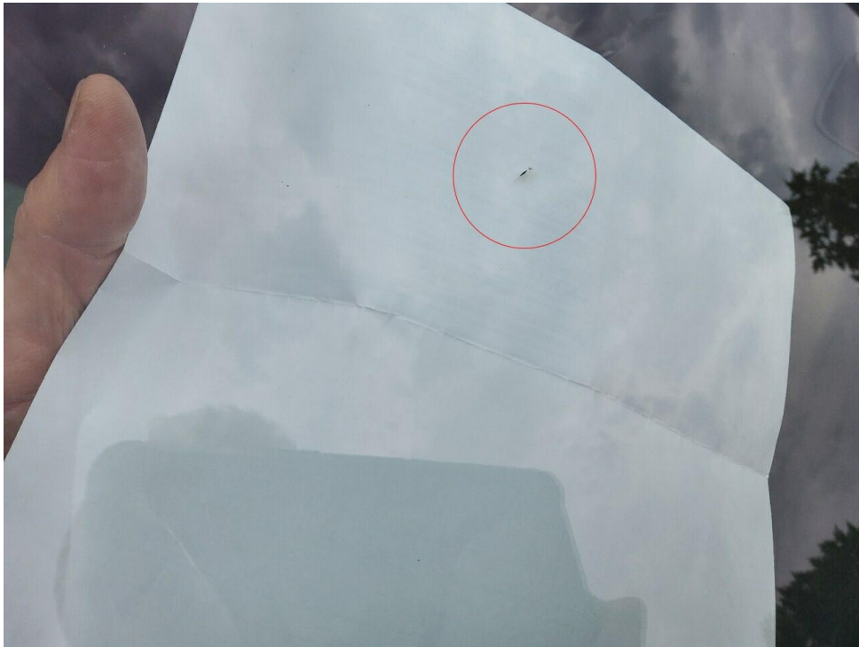
Bild 13 : Frontscheibe: Steinschlag mit Rißbildung
