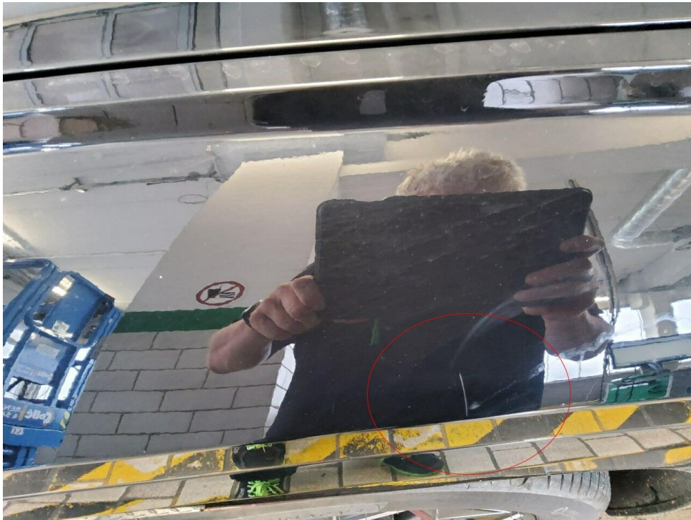
Bild 9 : Kotflügel VL verkratzt
