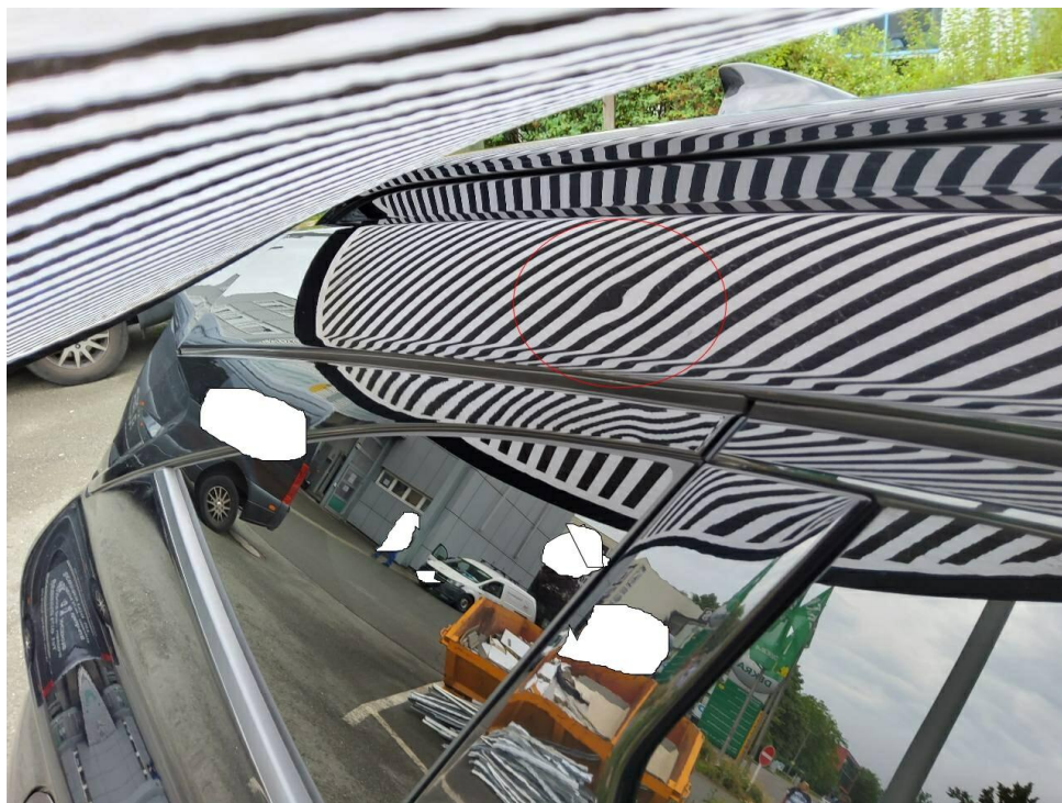
Bild 18 : Dachrahmen rechts eingedellt
