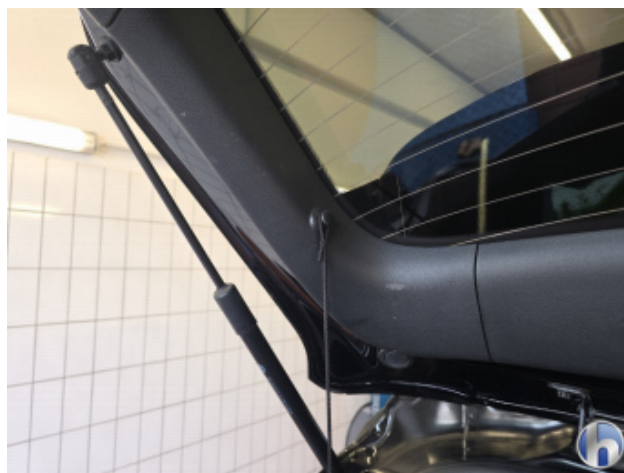
3. Hutablage Befestigung Schadhaft - Erneuern
