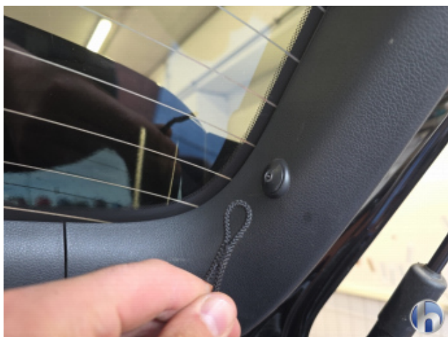
3. Hutablage Befestigung Schadhaft - Erneuern
