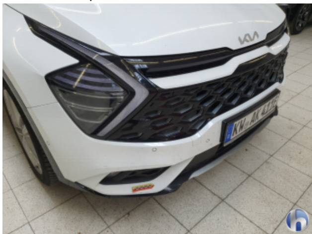
7. Stoßfänger Vorne Kratzer Tief Bis Grundierung - Smart Repair
