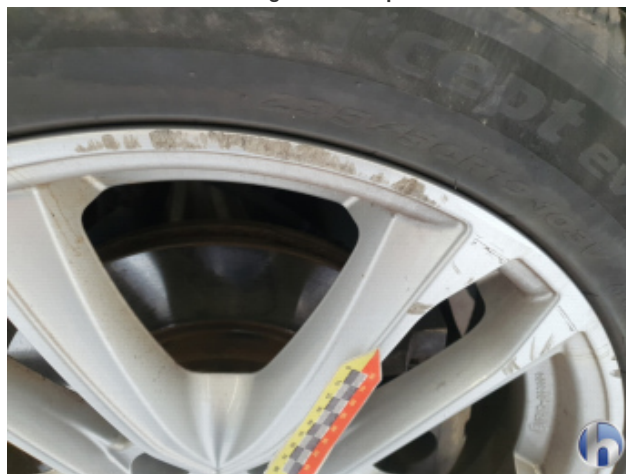
5. Felge Vorne - Rechts Kratzer - Smart Repair
