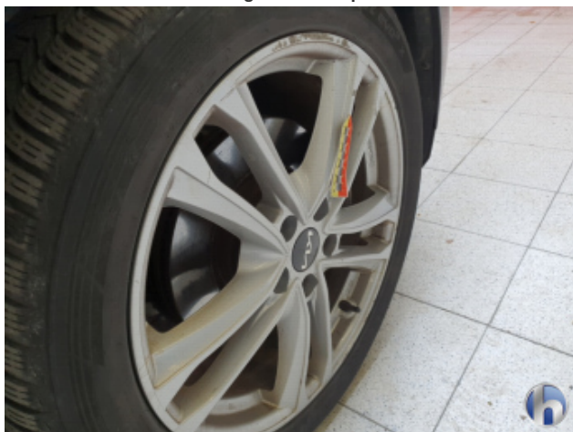
5. Felge Vorne - Rechts Kratzer - Smart Repair
