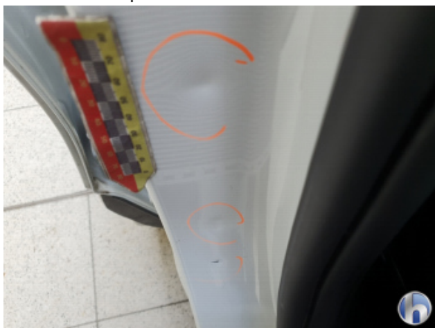
1. Türeinstieg Vorne - Rechts 2 Dellen - Smart Repair
