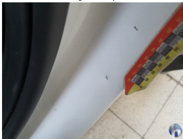
4. Türeinstieg Vorne - Links Kratzer Tief Bis Grundierung - Smart Repair
