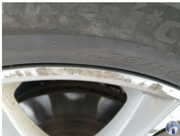
5. Felge Vorne - Rechts Kratzer - Smart Repair
