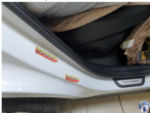
2. Türeinstieg Hinten - Rechts Kratzer Tief Bis Grundierung - Smart Repair
