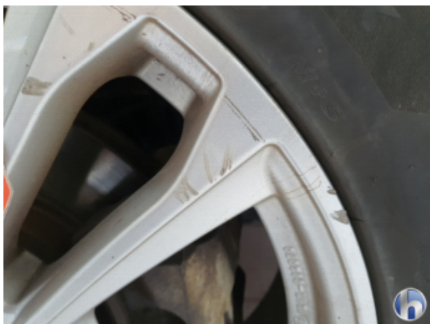
5. Felge Vorne - Rechts Kratzer - Smart Repair
