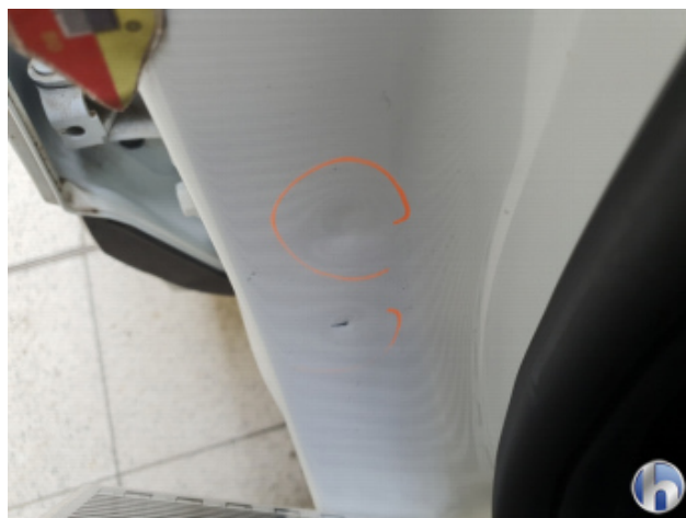
1. Türeinstieg Vorne - Rechts 2 Dellen - Smart Repair
