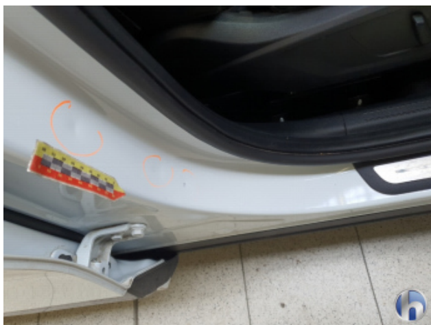
1. Türeinstieg Vorne - Rechts 2 Dellen - Smart Repair
