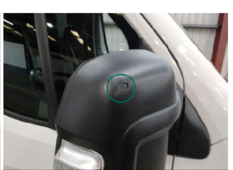
Außenspiegel elektrisch / Rechts / Gebrochen
