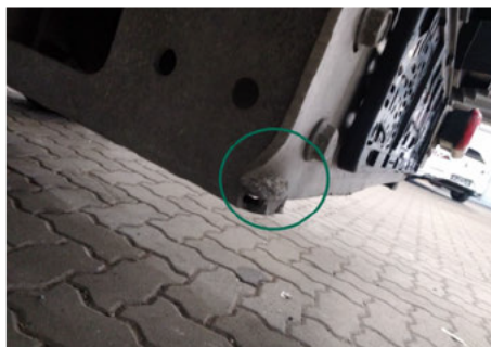
Heckblech / Hinten / Delle
