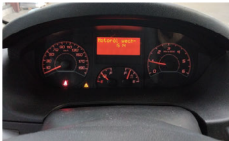
Warnleuchte Inspektion / Fehlt
