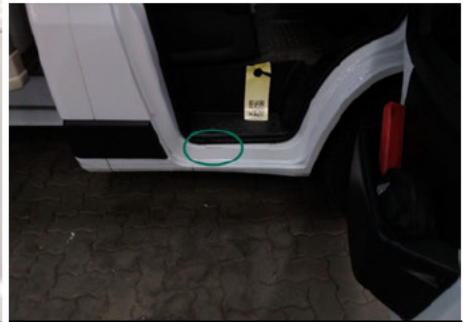
Türeinstieg / Vorne Rechts / Abgewetzt
