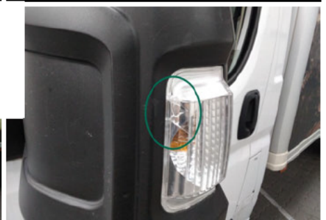
Blinker / Links / Gebrochen
