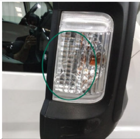
Außenspiegel elektrisch / Rechts / Gebrochen
