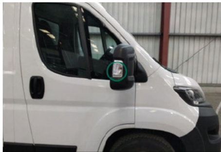
Außenspiegel elektrisch / Rechts / Gebrochen
