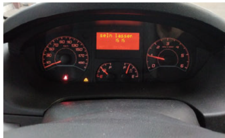
Warnleuchte Inspektion / Fehlt
