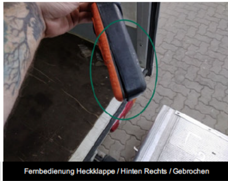
Halterung Fernbedienung / Hinten Rechts / Fehlt
