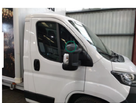
Außenspiegel elektrisch / Rechts / Gebrochen
