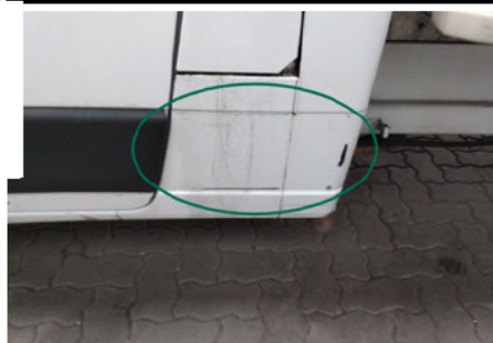
Zierleiste Seitenwand / Hinten Links / Fehlt
