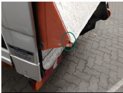
Abdeckung / Hinten Links / Gebrochen
