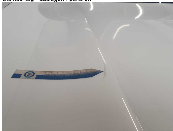
Beschädigung #2: Motorhaube: Motorhaube - Lackmangel - auslegen / polieren
