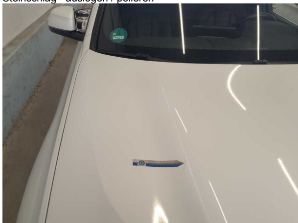
Beschädigung #2: Motorhaube: Motorhaube - Lackmangel - auslegen / polieren
