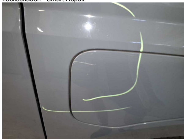
Beschädigung #4: Kraftstoffanlage: Tankdeckel - verkratzt / verschürft - Smart Repair
