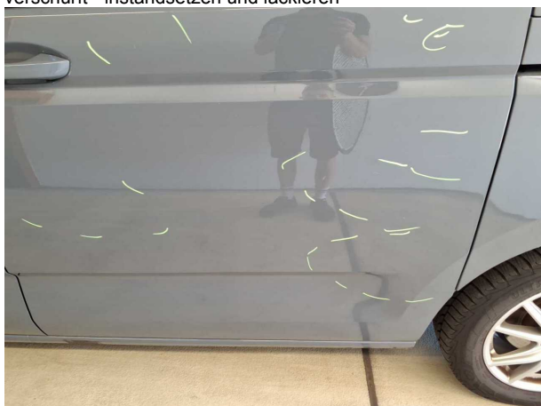
Beschädigung #10: Schiebetür links: Schiebetür mit Glasscheibe - verkratzt / verschürft - instandsetzen und lackieren
