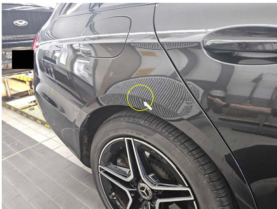
Bild 24 : Seitenteil hinten rechts, eingedellt
