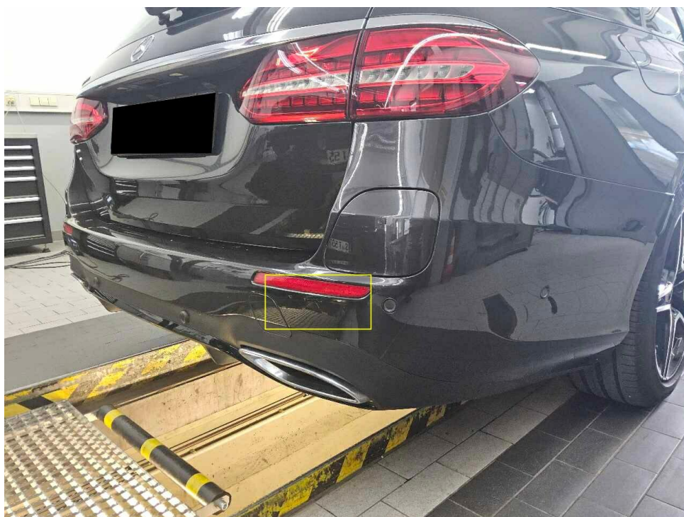
Bild 26 : Stoßfänger hinten Lackierung, zerkratzt, lackieren mit Lackaufbau
