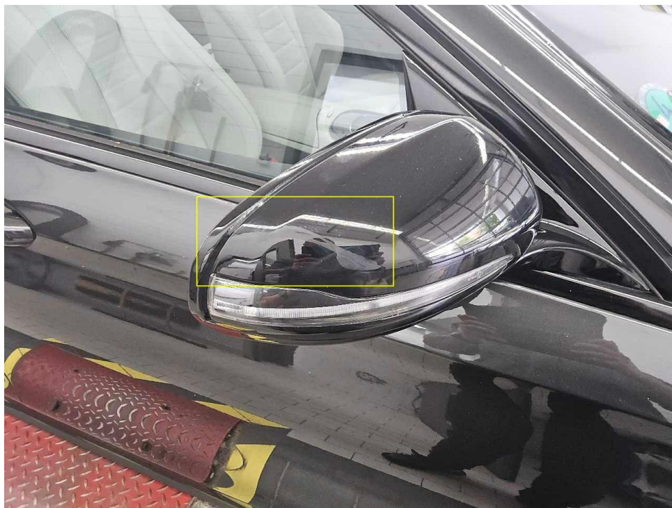
Bild 31 : Außenspiegelverkleidung rechts, Abrieb
