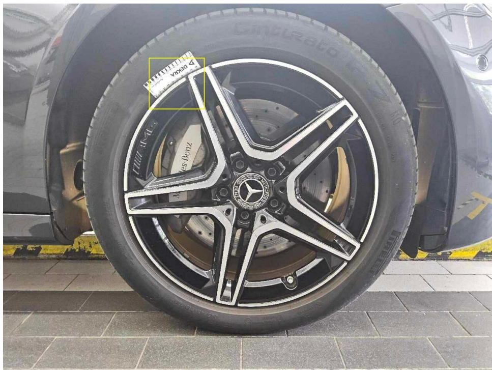
Bild 34 : Glanzgedrehte Felge (Sommer) vorne rechts, zerkratzt
