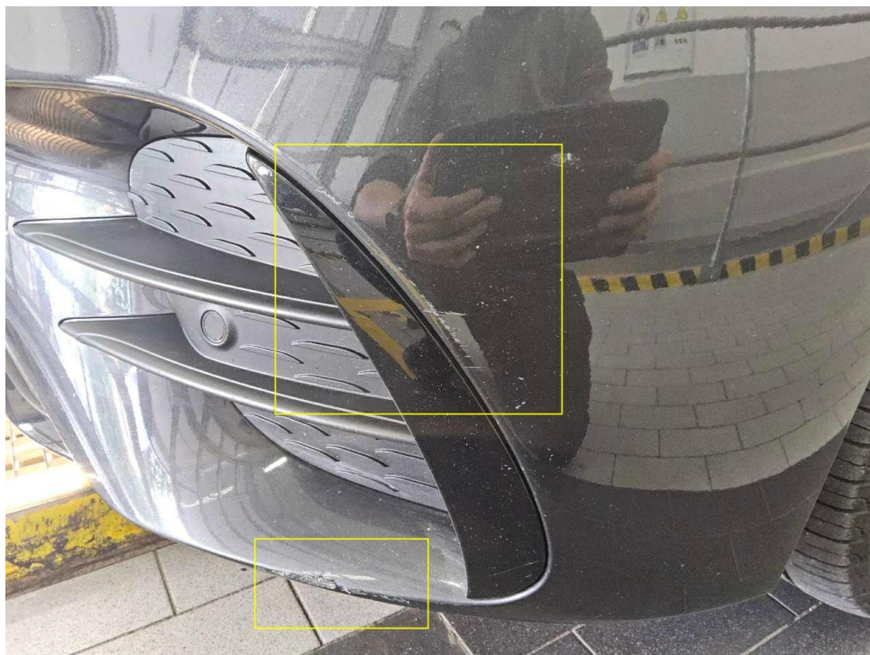
Bild 16 : Stoßfänger vorne Lackierung, zerkratzt, lackieren mit Lackaufbau
