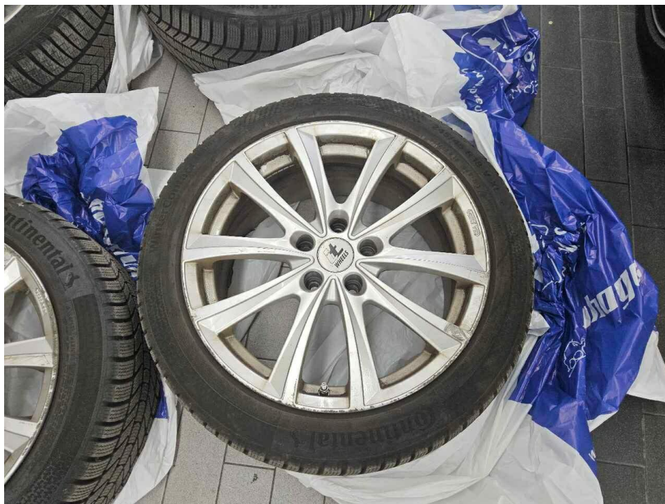
Bild 42 : Felge (Winter) vorne rechts, zerkratzt
