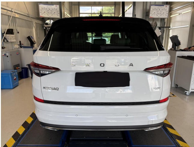
Stoßfänger hinten - zerkratzt - Lackieren
