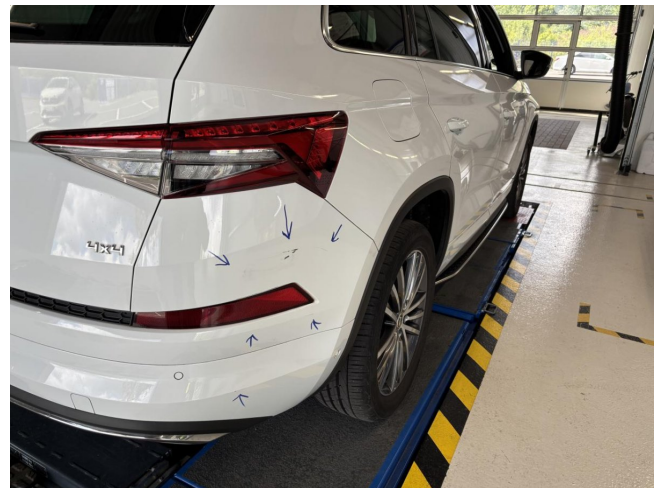
Stoßfänger hinten - zerkratzt - Lackieren
