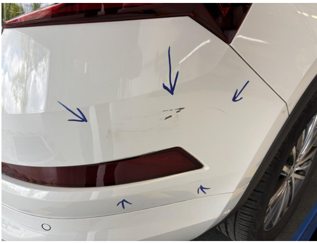
Stoßfänger hinten - zerkratzt - Lackieren
