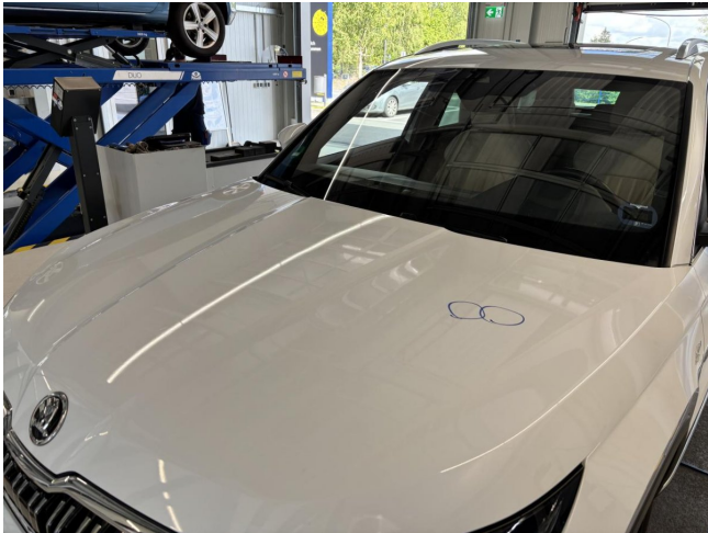
Motorhaube - Delle - kein Abzug
