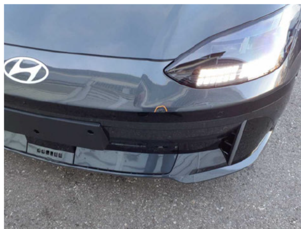
Beschädigung 1: Stossfänger vorn: Stossfänger vorn - beschädigt - instandsetzen und lackieren
