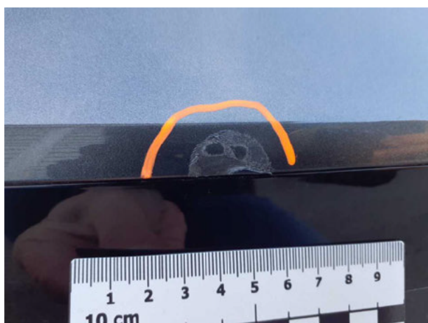
Beschädigung 1: Stossfänger vorn: Stossfänger vorn - beschädigt - instandsetzen und lackieren
