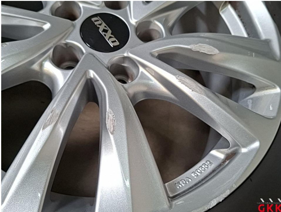
Bild 16 LM-Rad, 2 x beiliegend, beschädigt, ersetzen
