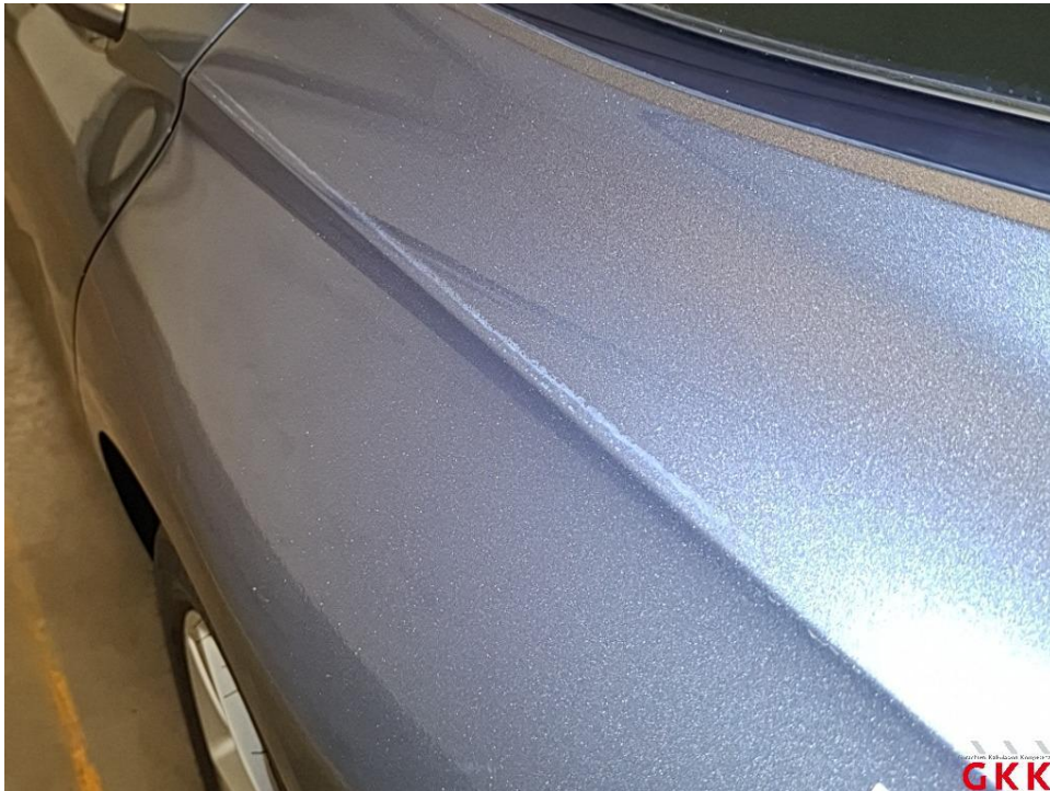
Bild 30 Seitenwand links, Reparaturmangel, lackieren
