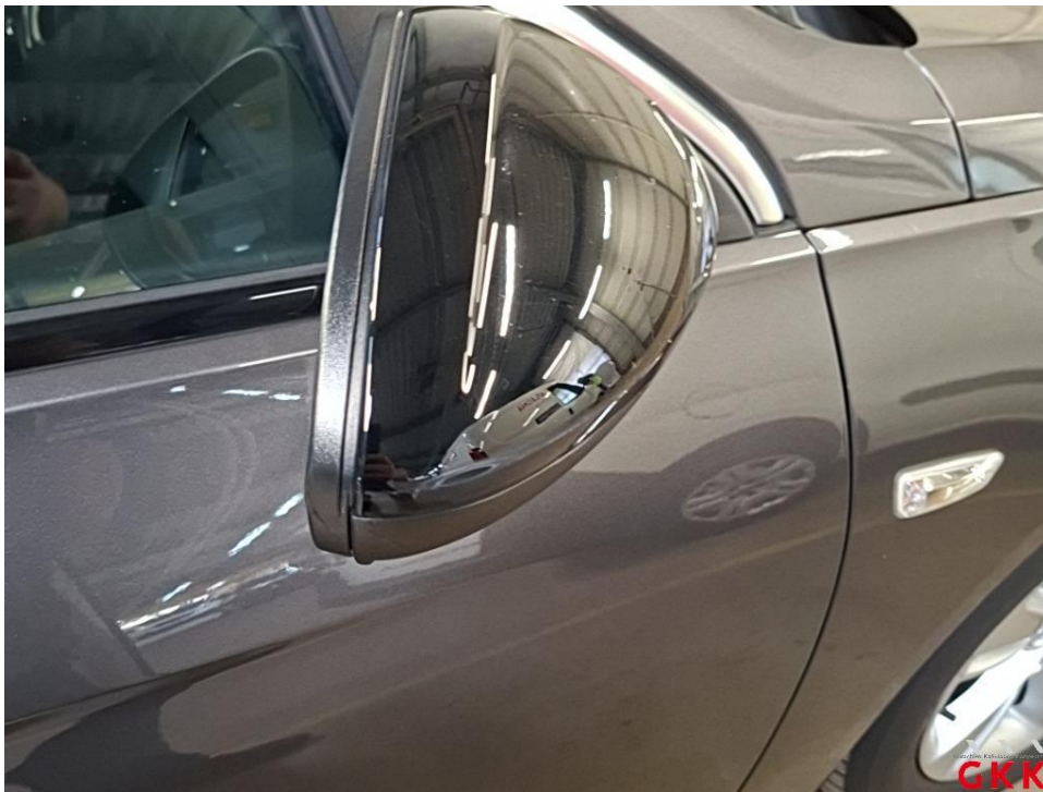
Bild 35 Spiegelgehäuse rechts, Kappe -lackiert-, beschädigt, ersetzen
