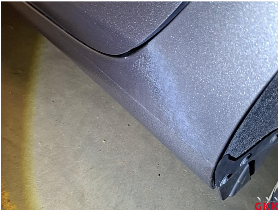
Bild 31 Seitenwand links, Reparaturmangel, lackieren
