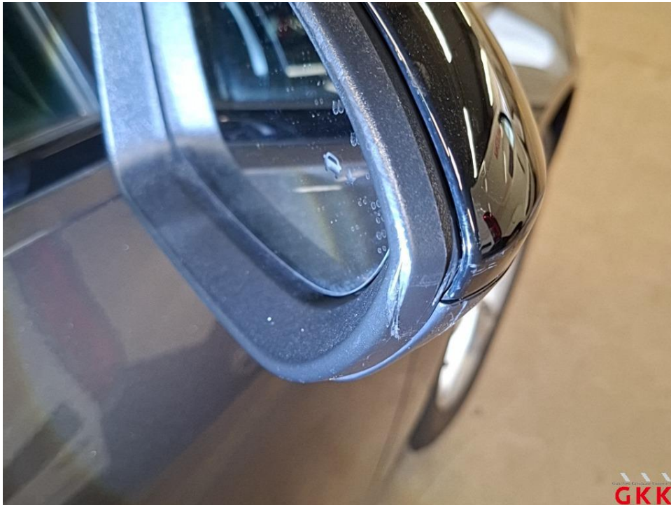
Bild 42 Spiegelgehäuse rechts, Rahmen, beschädigt, ersetzen
