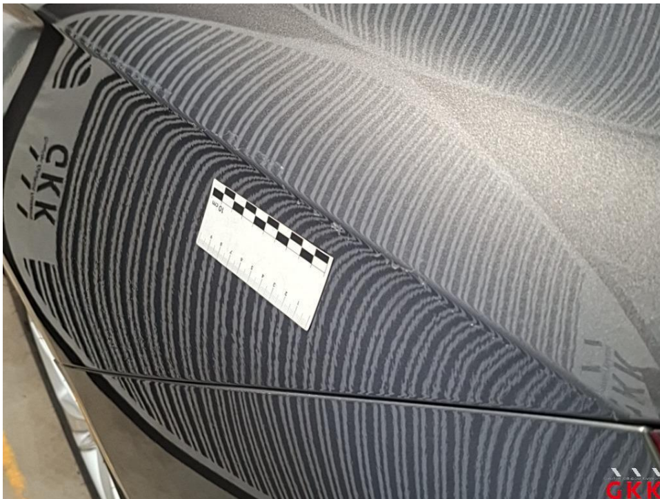
Bild 29 Seitenwand links, Reparaturmangel, lackieren
