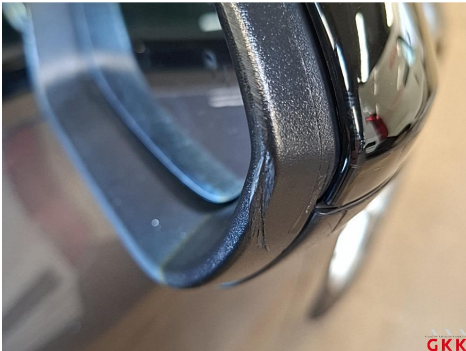
Bild 43 Spiegelgehäuse rechts, Rahmen, beschädigt, ersetzen
