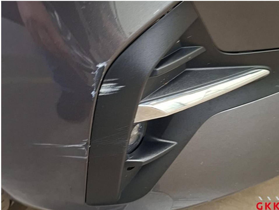
Bild 24 Nebelscheinwerfer, Blende -unlackiert-, beschädigt, ersetzen
