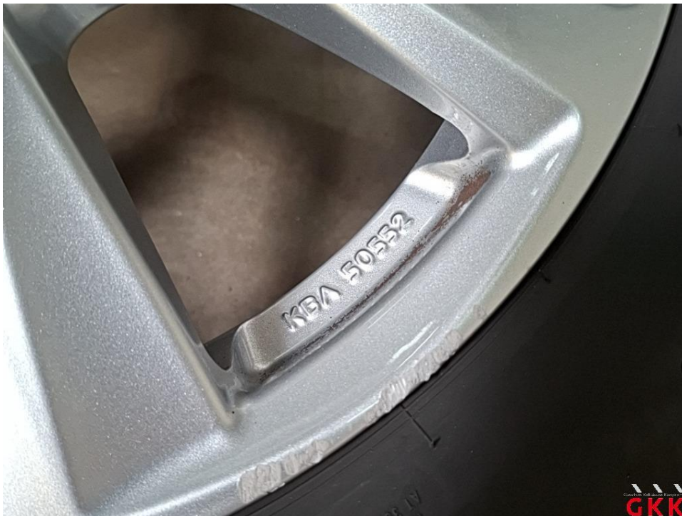
Bild 17 LM-Rad, 2 x beiliegend, beschädigt, ersetzen
