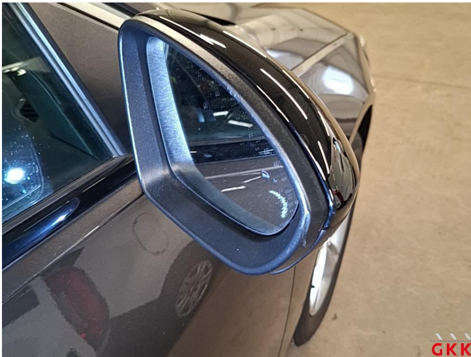
Bild 41 Spiegelgehäuse rechts, Rahmen, beschädigt, ersetzen
