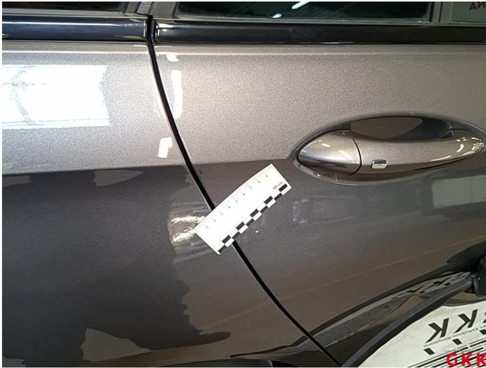
Bild 34 Tür hinten rechts, Steinschlag, auslegen, schleifen, polieren
