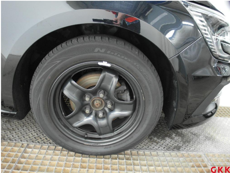
Bild 16. Radkappe(n), Satz, fehlt, ersetzen
