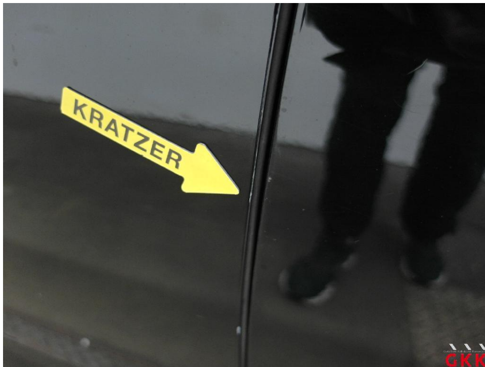
Bild 14. Tür vorne links, Kante, verkratzt, auslegen, schleifen, polieren
