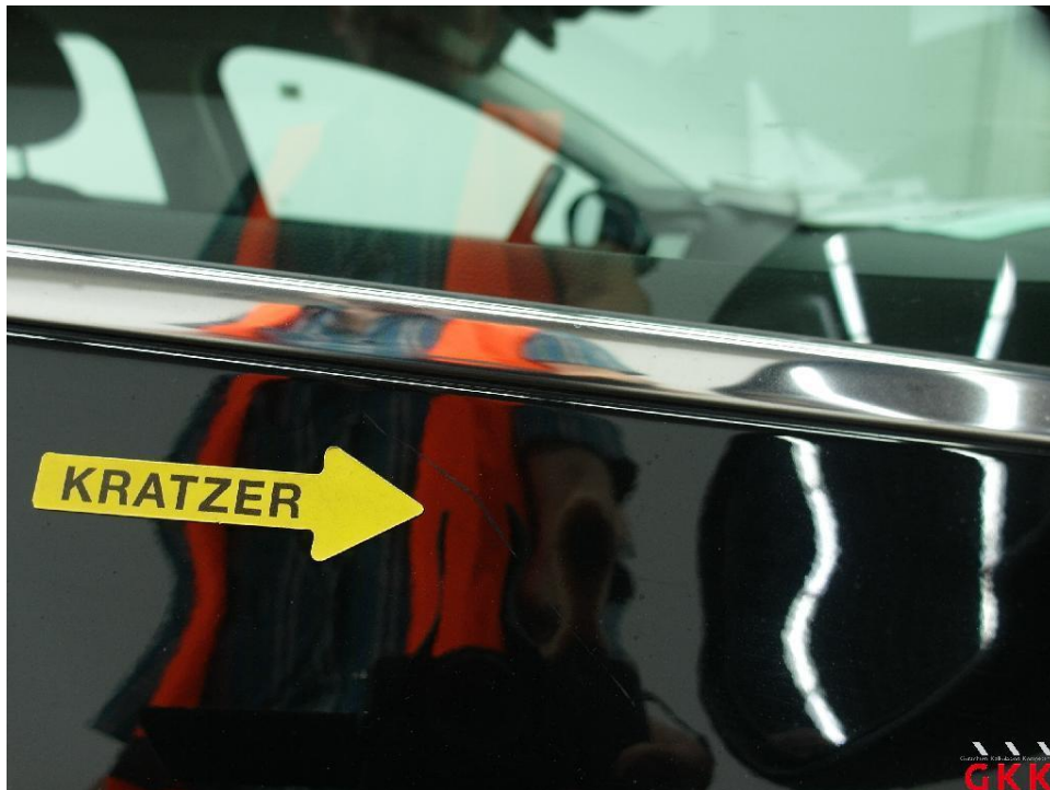
Bild 23. Tür vorne rechts, verkratzt, auslegen, schleifen, polieren
