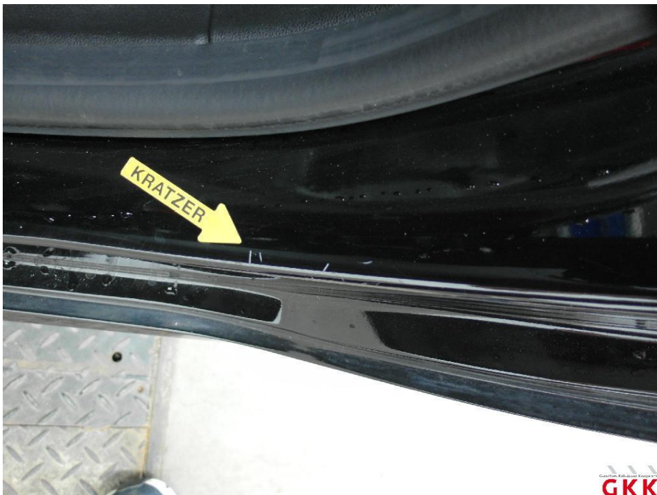
Bild 32. Tür hinten links, Einstieg, verkratzt, auslegen, schleifen, polieren
