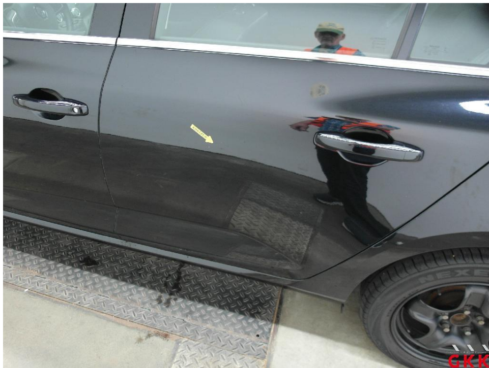
Bild 34. Tür hinten links, verkratzt, auslegen, schleifen, polieren
