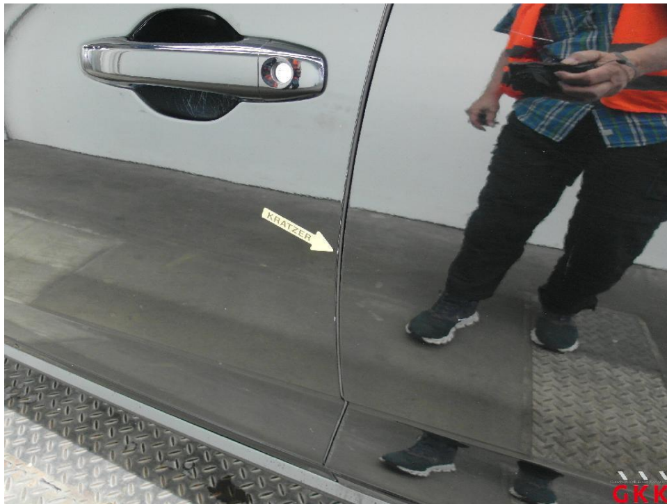
Bild 13. Tür vorne links, Kante, verkratzt, auslegen, schleifen, polieren
