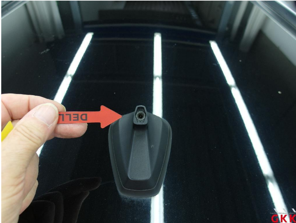
Bild 29. Antenne, Stab, fehlt, ersetzen
