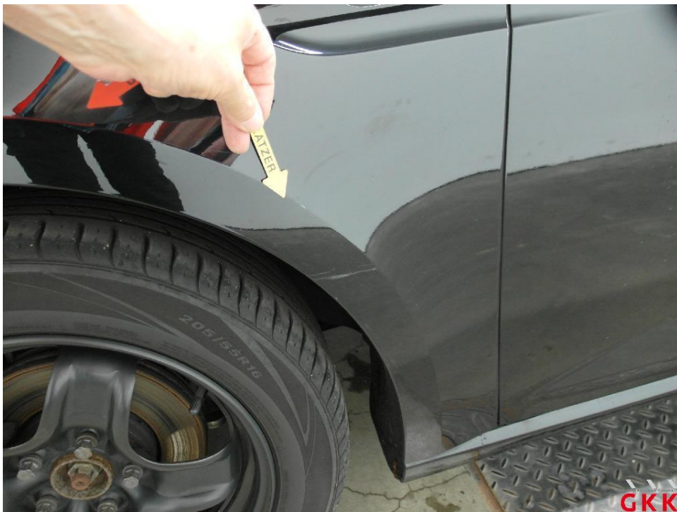
Bild 18. Kotflügel vorne links, verkratzt, auslegen, schleifen, polieren
