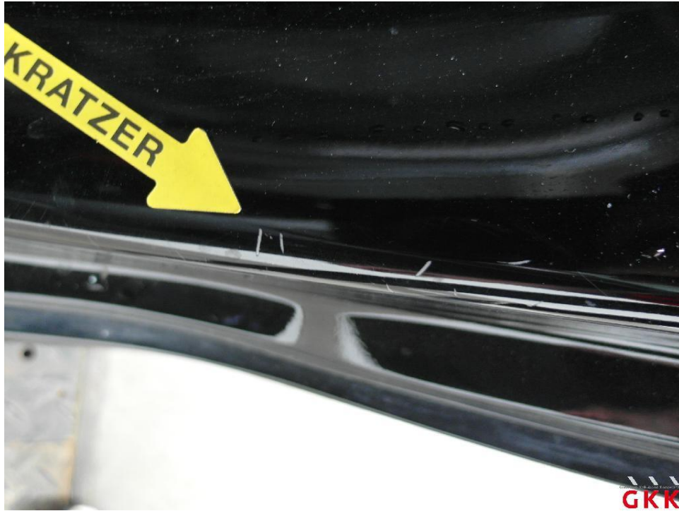
Bild 33. Tür hinten links, Einstieg, verkratzt, auslegen, schleifen, polieren
