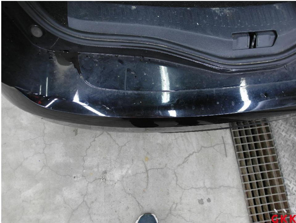
Bild 30. Stoßfänger hinten, Verkleidung oberhalb -lackiert-, verkratzt, auslegen, schleifen, polieren
