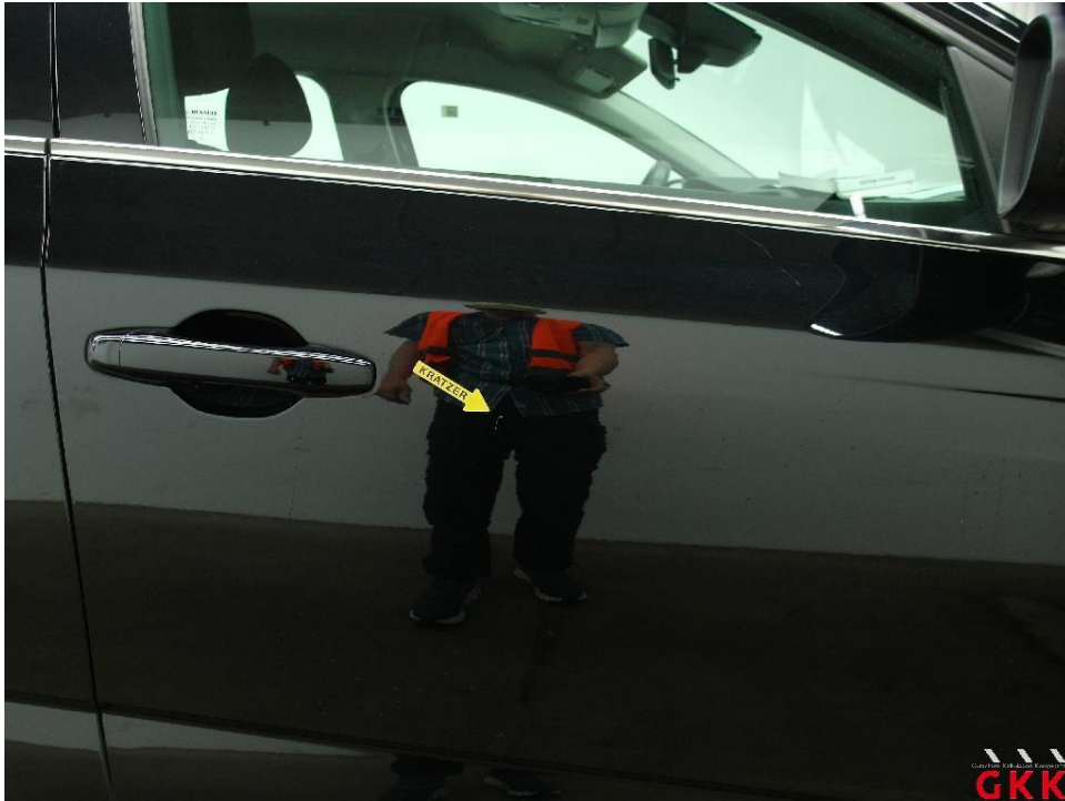
Bild 21. Tür vorne rechts, verkratzt, auslegen, schleifen, polieren
