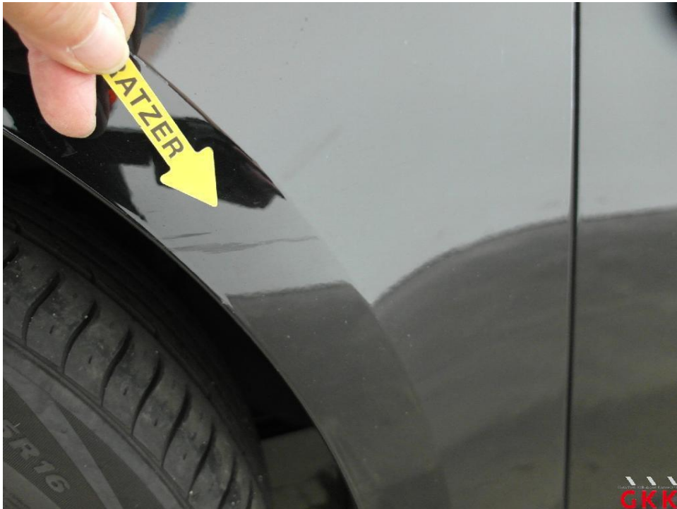
Bild 20. Kotflügel vorne links, verkratzt, auslegen, schleifen, polieren
