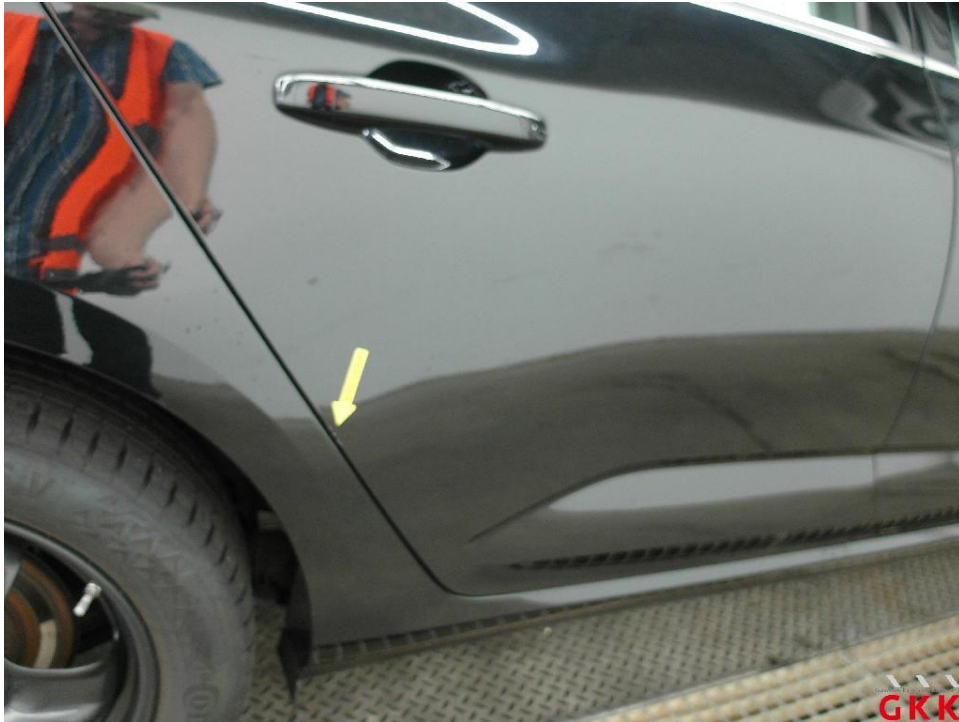
Bild 27. Tür hinten rechts, Kante, verkratzt, auslegen, schleifen, polieren
