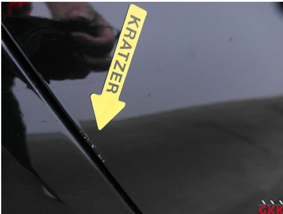
Bild 28. Tür hinten rechts, Kante, verkratzt, auslegen, schleifen, polieren
