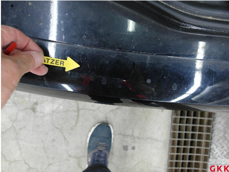
Bild 31. Stoßfänger hinten, Verkleidung oberhalb -lackiert-, verkratzt, auslegen, schleifen, polieren
