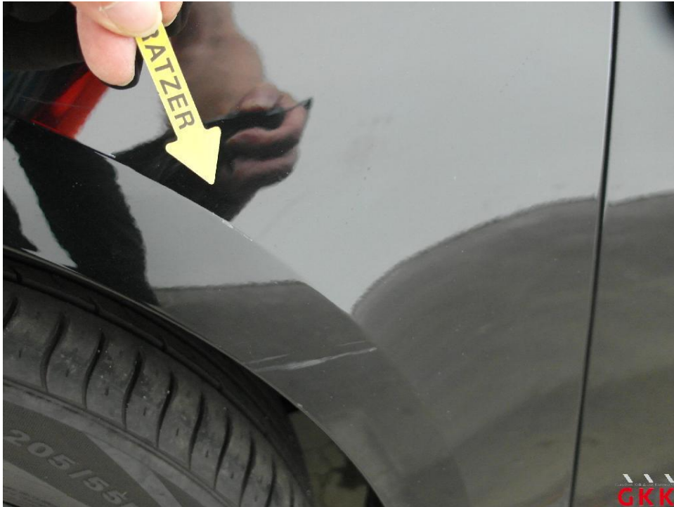
Bild 19. Kotflügel vorne links, verkratzt, auslegen, schleifen, polieren
