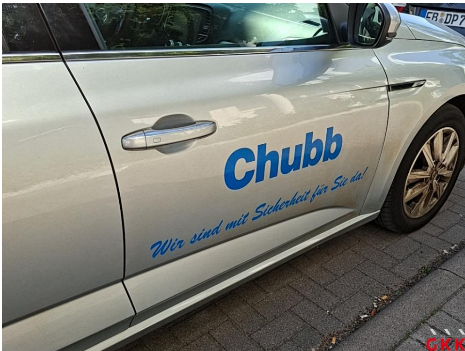
Bild 26. Tür vorne rechts, Lackierung verwittert / matt, polieren
