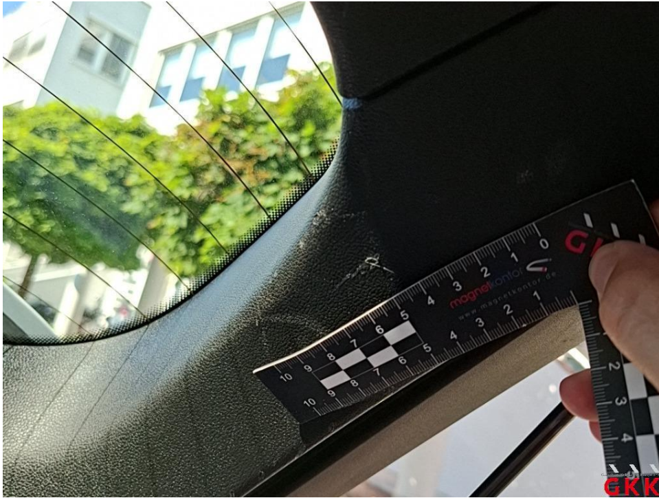
Bild 17. Heckklappe, Innenverkleidung, beschädigt, ersetzen
