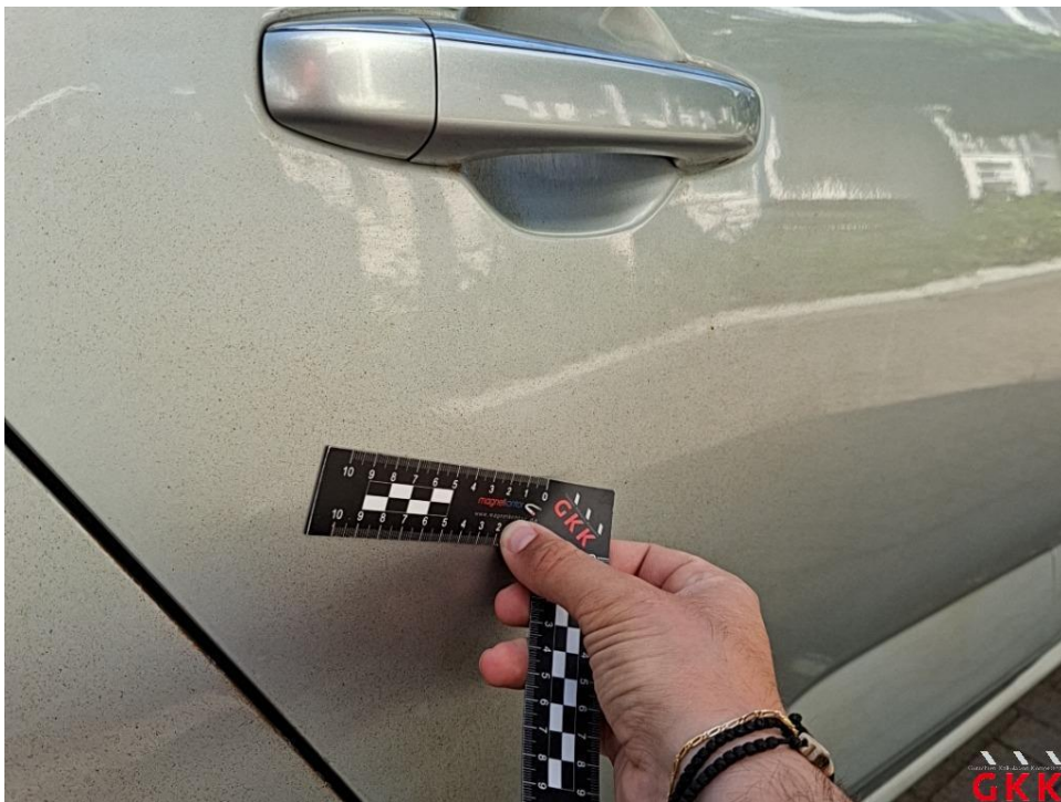
Bild 24. Tür hinten rechts, Lackierung verwittert / matt, polieren
