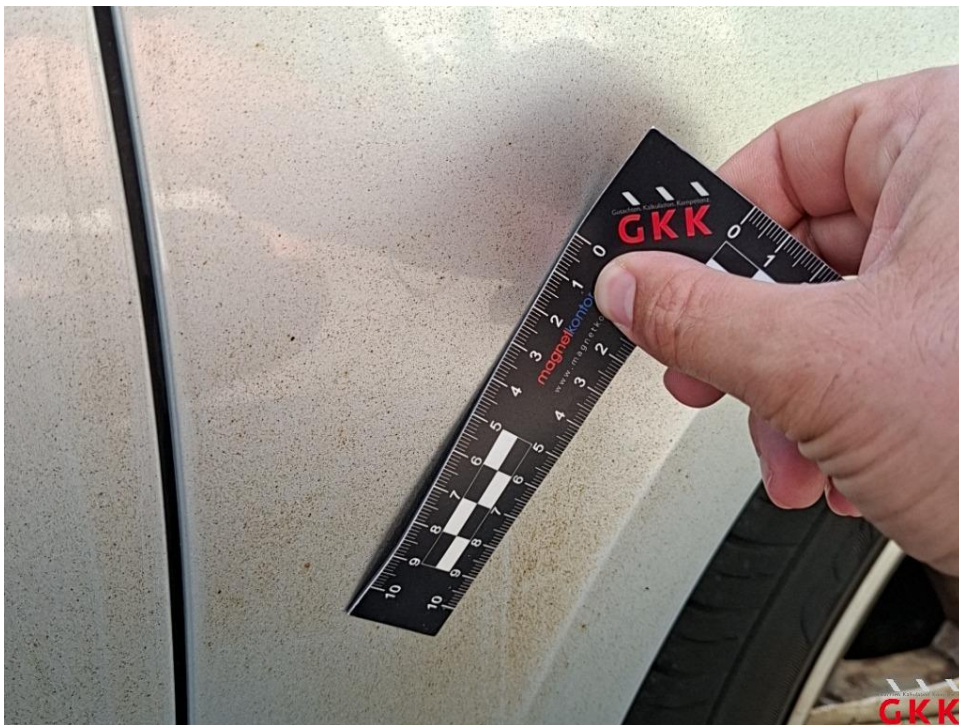
Bild 30. Kotflügel vorne rechts, Lackierung verwittert / matt, polieren
