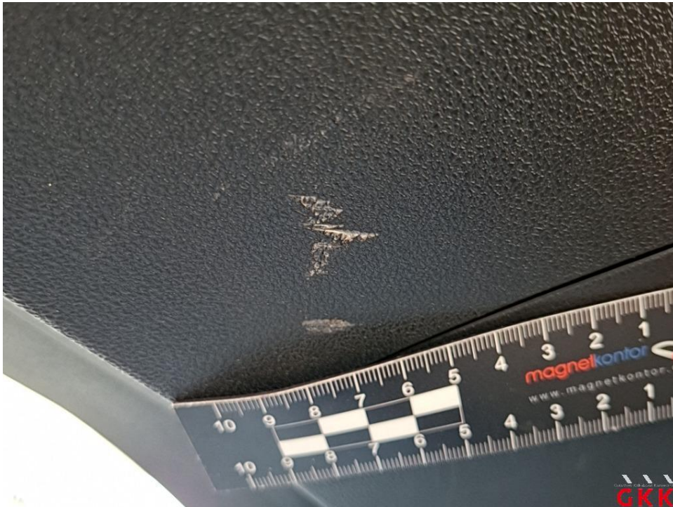
Bild 16. Heckklappe, Innenverkleidung, beschädigt, ersetzen
