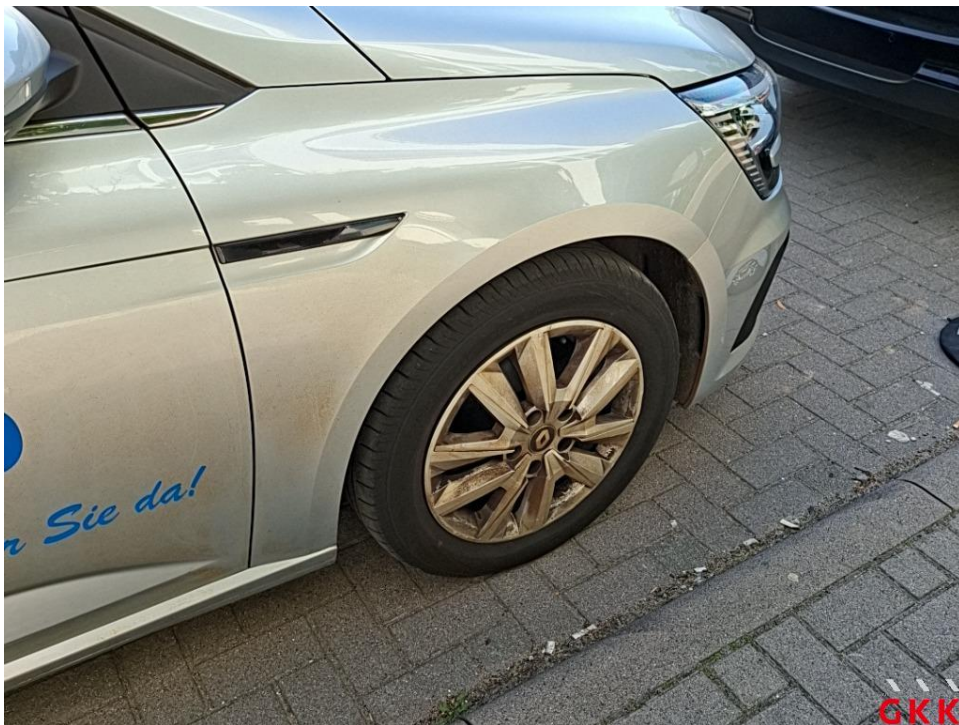
Bild 28. Kotflügel vorne rechts, Lackierung verwittert / matt, polieren
