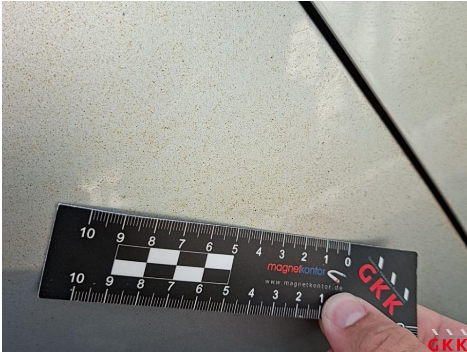
Bild 23. Seitenwand rechts, Lackierung verwittert / matt, polieren
