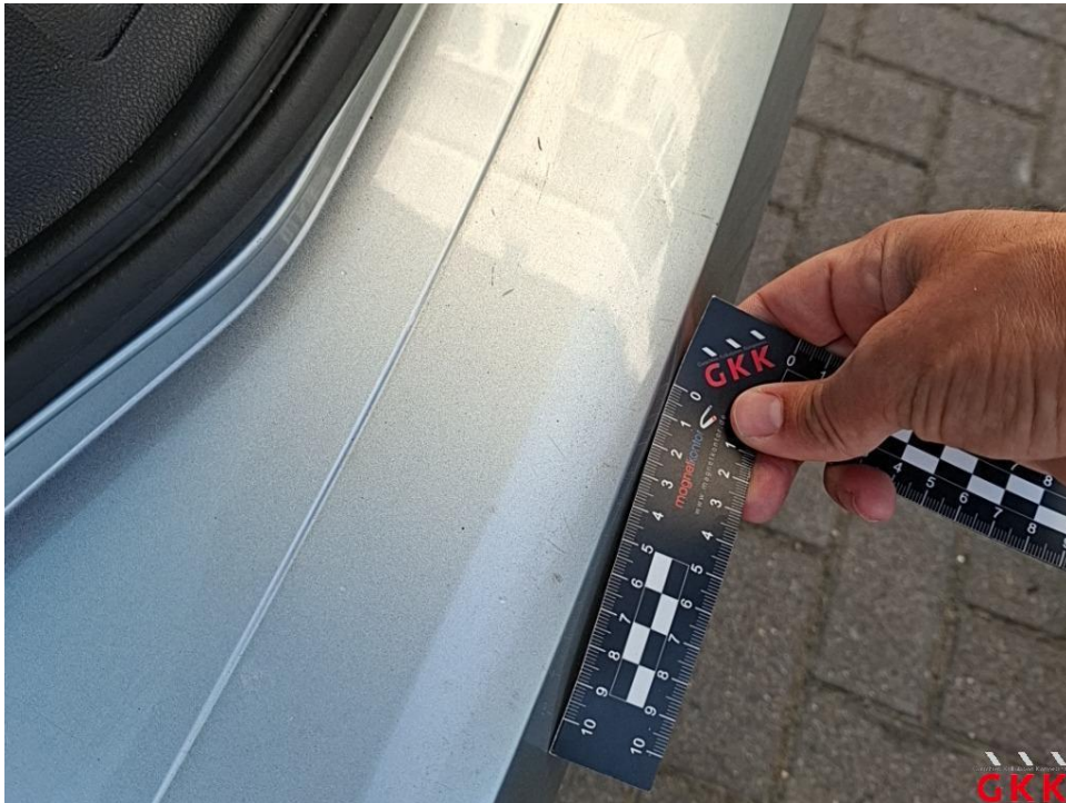
Bild 20. Stoßfänger hinten, Verkleidung -lackiert-, verkratzt, lackieren
