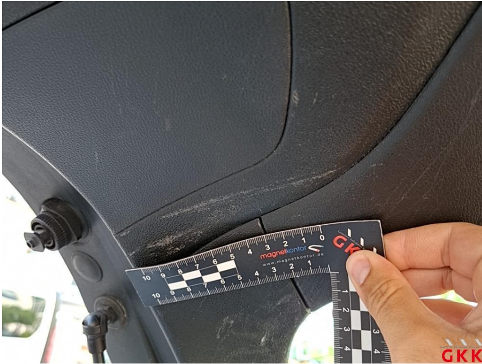
Bild 15. Heckklappe, Innenverkleidung, beschädigt, ersetzen
