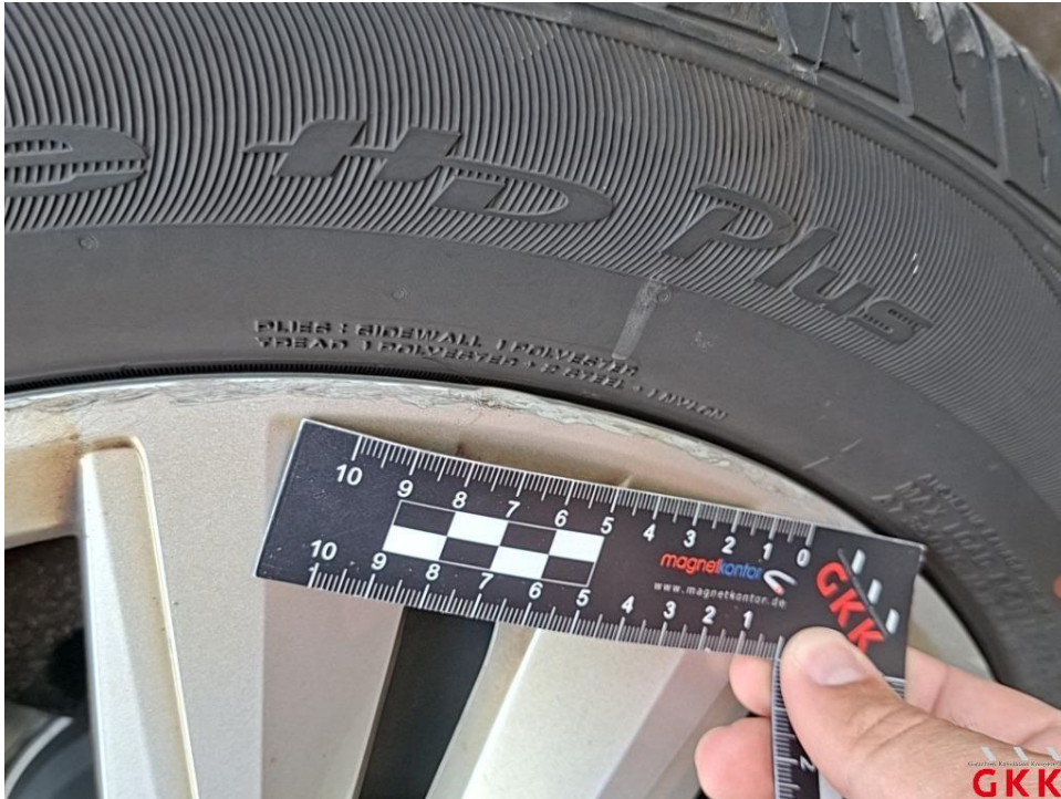
Bild 33. Radkappe(n), Satz, verkratzt, ersetzen
