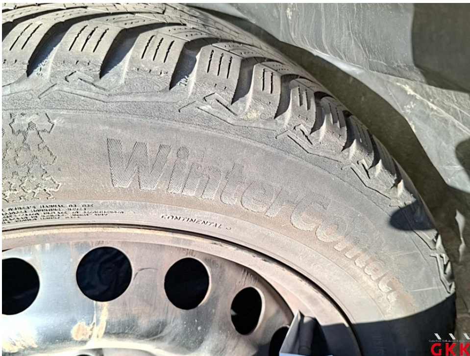
Bild 34. Reifen, 2 x beiliegend, beschädigt und überaltert, ersetzen
