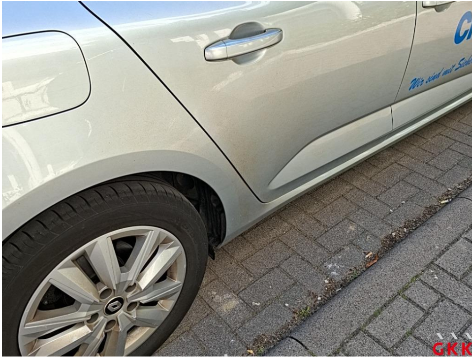
Bild 21. Seitenwand rechts, Lackierung verwittert / matt, polieren
