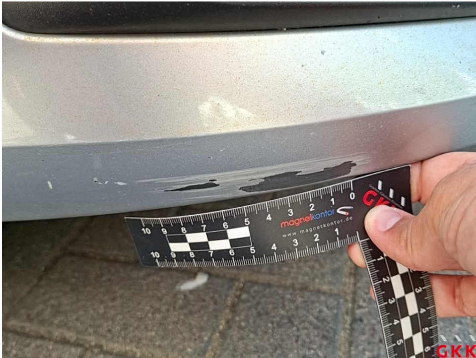
Bild 32. Stoßfänger vorne, Verkleidung -lackiert-, verkratzt, lackieren
