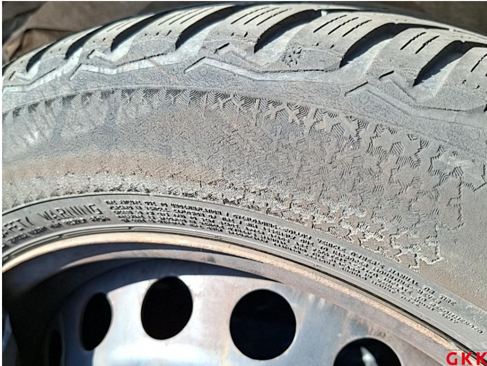
Bild 35. Reifen, 2 x beiliegend, beschädigt und überaltert, ersetzen
