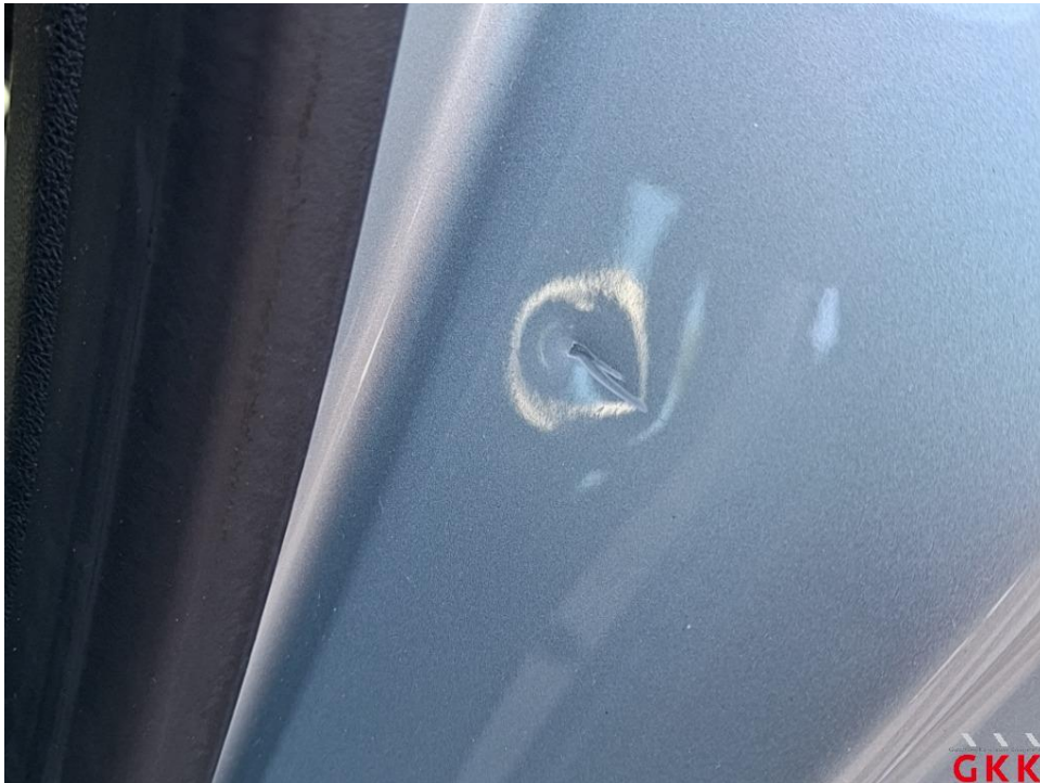
Bild 14. C- Säule links, innen, beschädigt, instand setzen - lackieren
