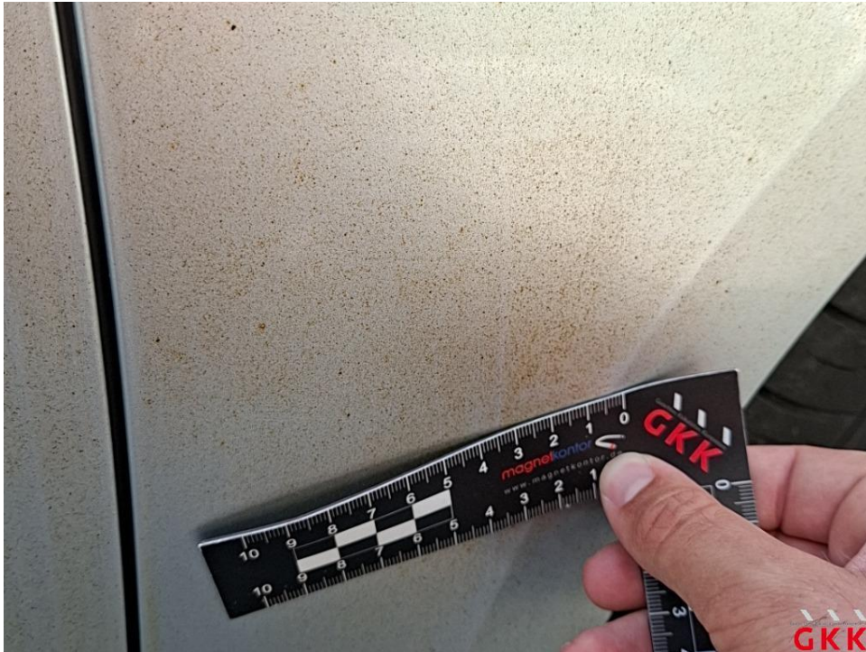
Bild 29. Kotflügel vorne rechts, Lackierung verwittert / matt, polieren
