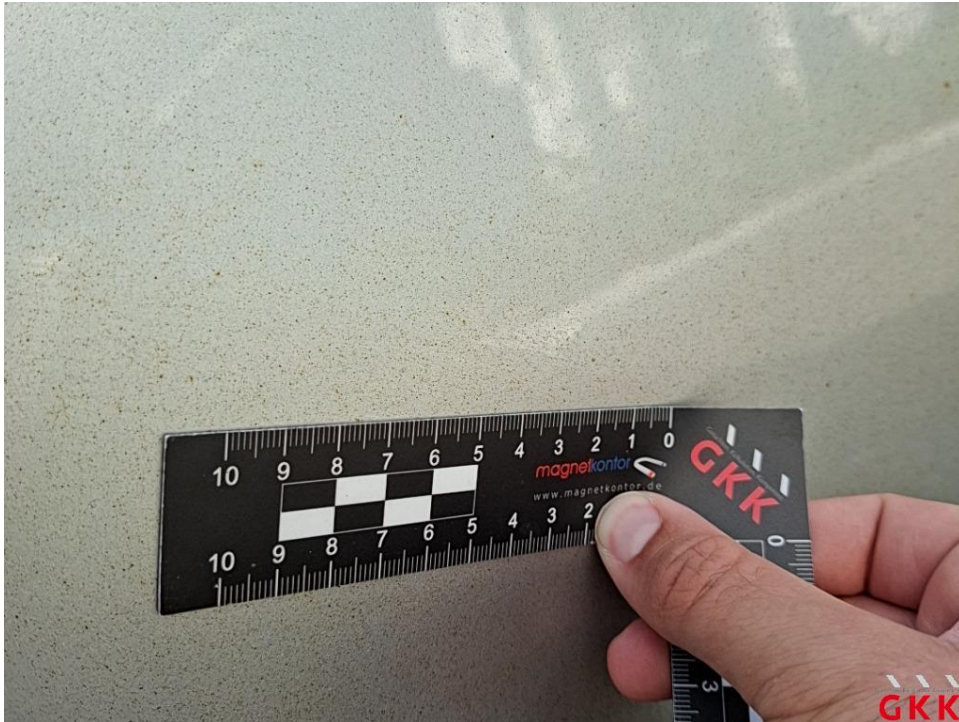
Bild 25. Tür hinten rechts, Lackierung verwittert / matt, polieren
