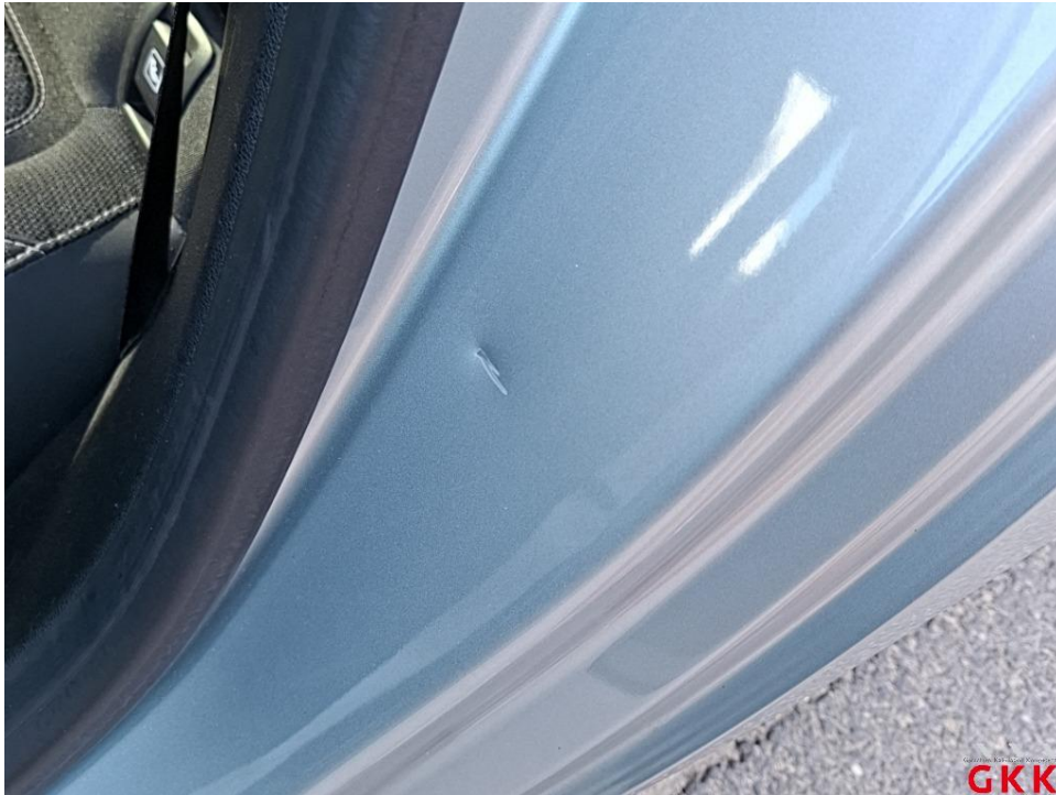
Bild 13. C- Säule links, innen, beschädigt, instand setzen - lackieren
