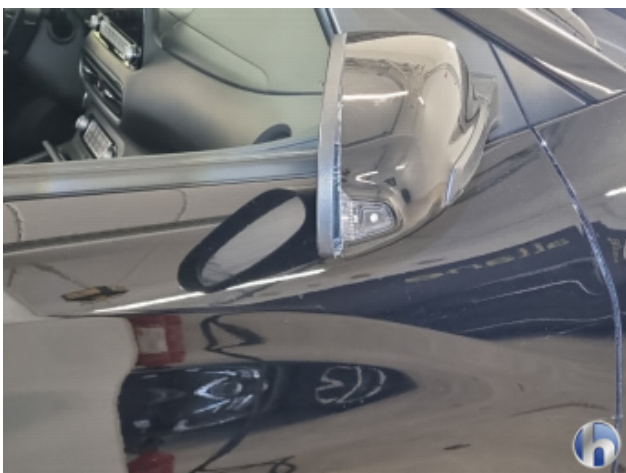
1. Außenspiegel Gehäuse - Rechts Beschädigt - Erneuern
