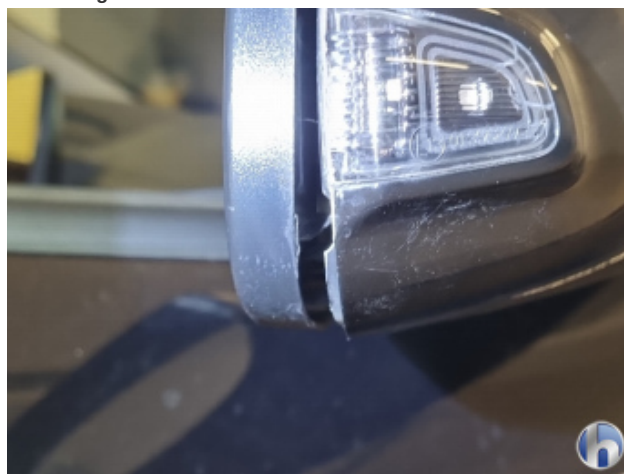
1. Außenspiegel Gehäuse - Rechts Beschädigt - Erneuern
