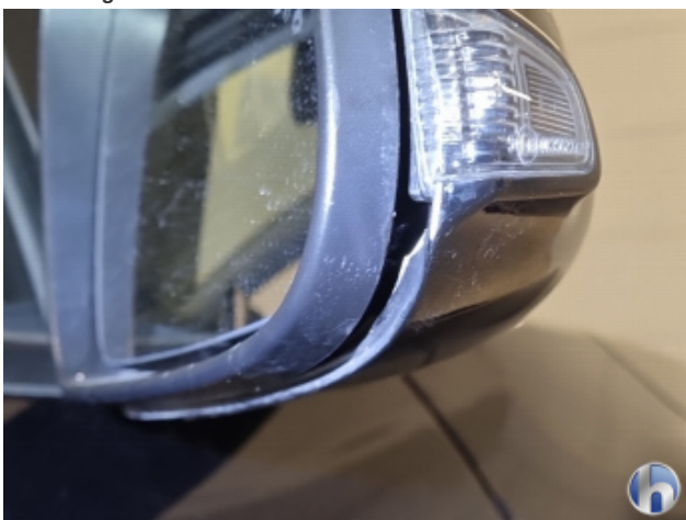
1. Außenspiegel Gehäuse - Rechts Beschädigt - Erneuern
