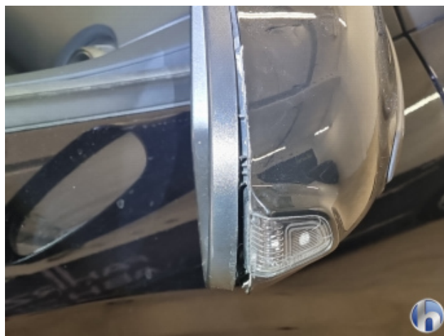
1. Außenspiegel Gehäuse - Rechts Beschädigt - Erneuern
