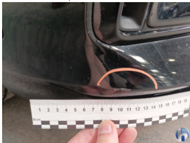
4. Stoßfänger Vorne Beschädigt - Lackieren
