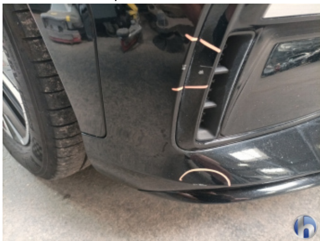
4. Stoßfänger Vorne Beschädigt - Lackieren
