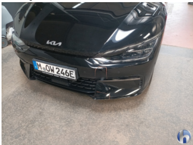
4. Stoßfänger Vorne Beschädigt - Lackieren
