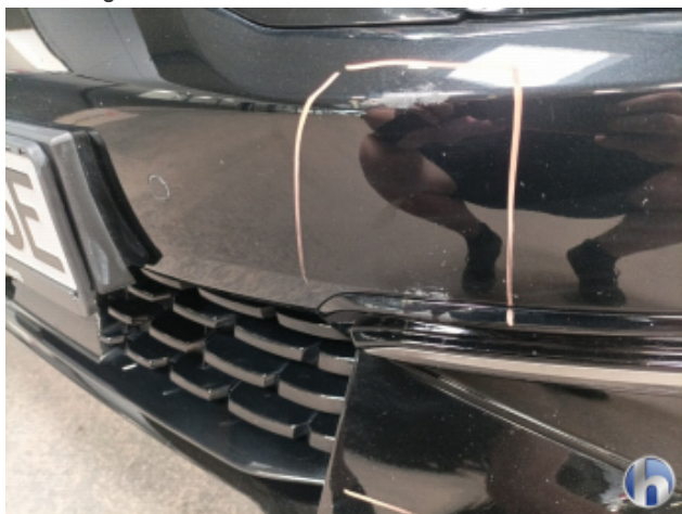
4. Stoßfänger Vorne Beschädigt - Lackieren
