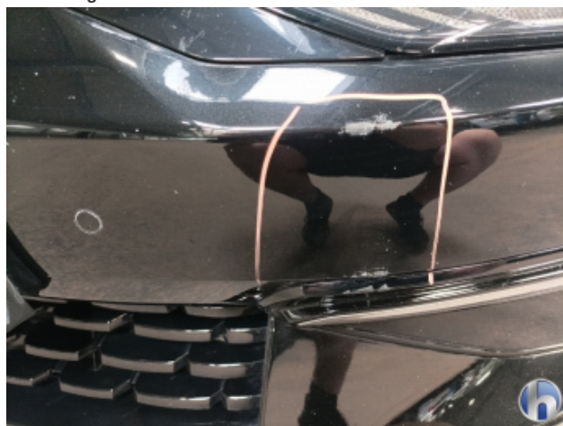
4. Stoßfänger Vorne Beschädigt - Lackieren
