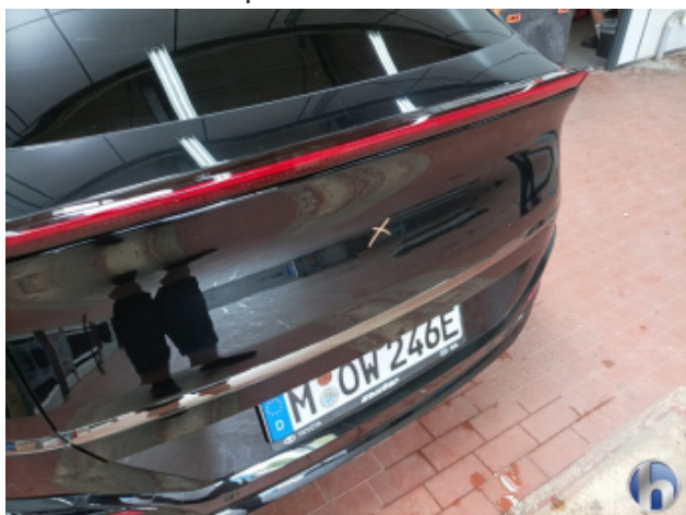
3. Heckklappe Nachlackiert - Ohne Reparatur
