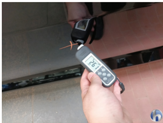
2. Tür Vorne - Links Nachlackiert - Ohne Reparatur
