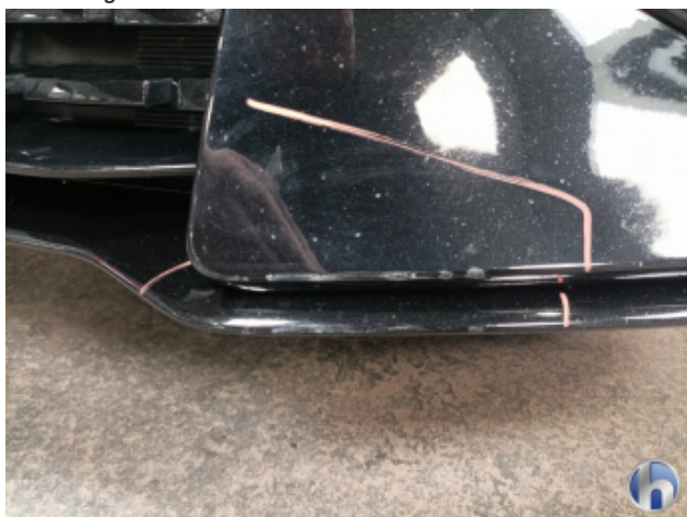
4. Stoßfänger Vorne Beschädigt - Lackieren
