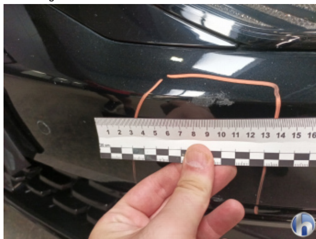
4. Stoßfänger Vorne Beschädigt - Lackieren
