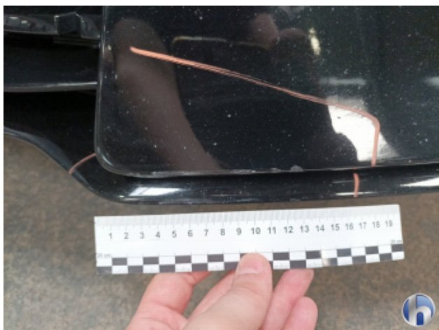
4. Stoßfänger Vorne Beschädigt - Lackieren
