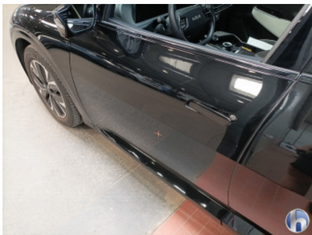
2. Tür Vorne - Links Nachlackiert - Ohne Reparatur
