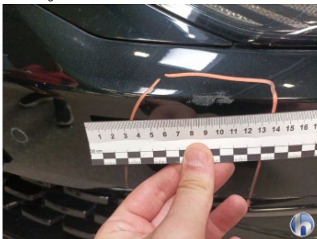
4. Stoßfänger Vorne Beschädigt - Lackieren
