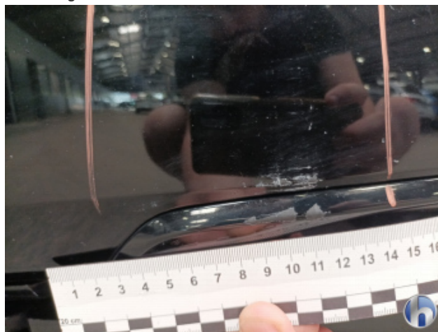
4. Stoßfänger Vorne Beschädigt - Lackieren
