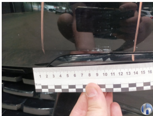
4. Stoßfänger Vorne Beschädigt - Lackieren
