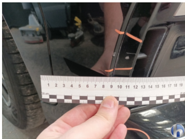
4. Stoßfänger Vorne Beschädigt - Lackieren
