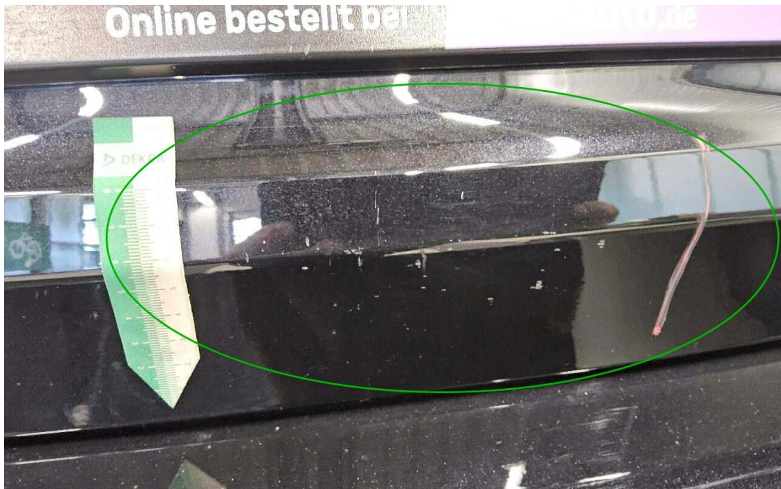
Bild 15 : Heckdeckel Lackierung, zerkratzt, lackieren mit Lackaufbau
