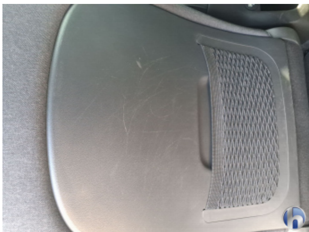
4. Sitz Innenraum links vorne Kratzer - Erneuern
