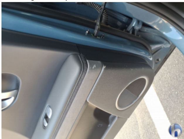
3. Verkleidung Kratzer - Erneuern
