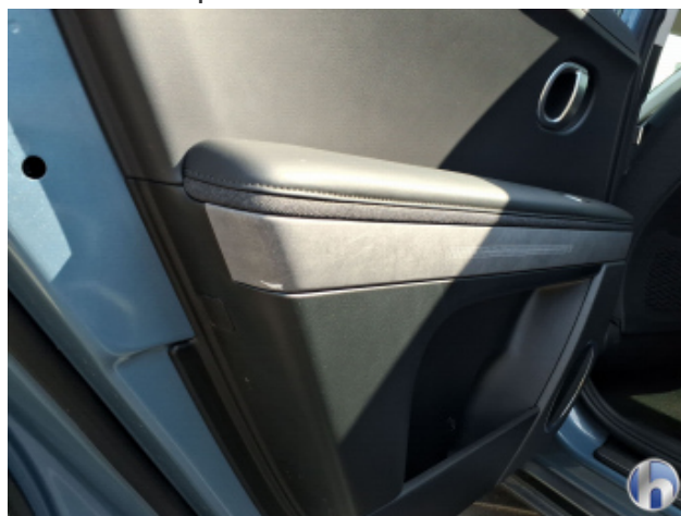
3. Verkleidung Kratzer - Erneuern
