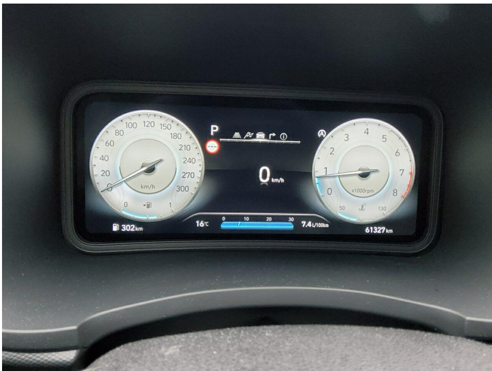
Bild 4 : Kombiinstrument (betriebsbereit) mit Km-Stand
