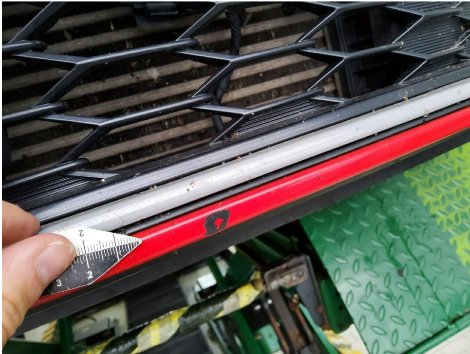
Bild 7 : Steinschläge Stoßfänger vorne
