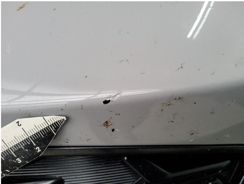
Bild 8 : Steinschläge Stoßfänger vorne
