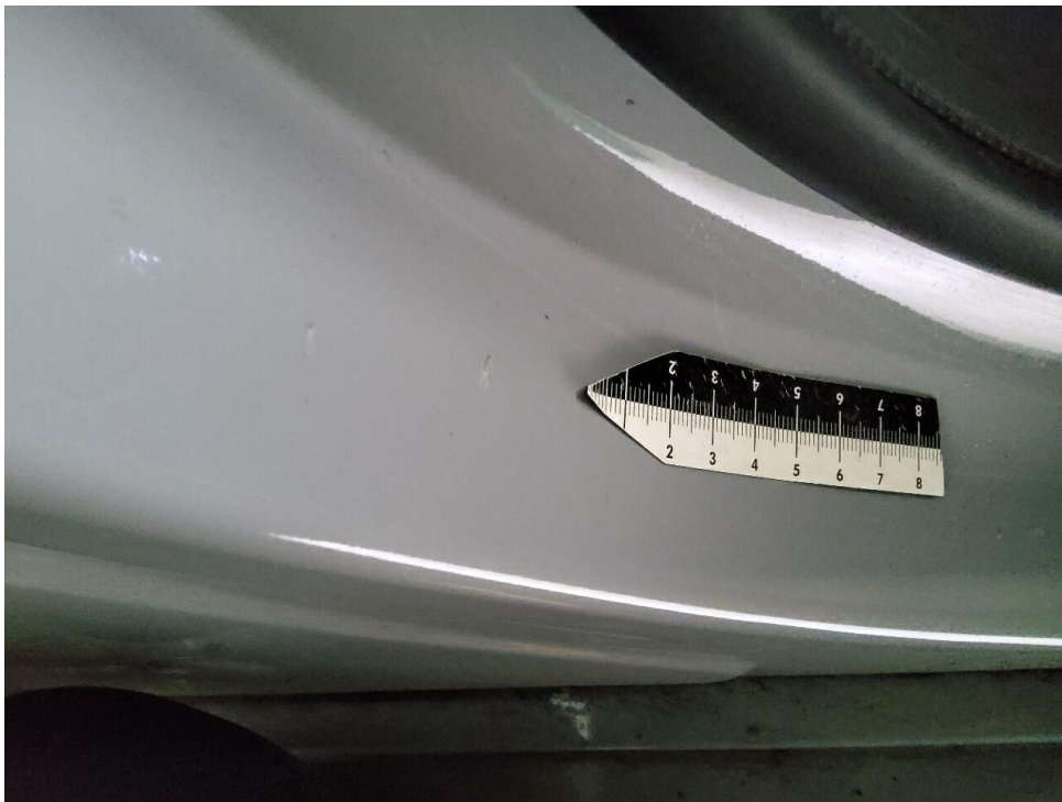
Bild 14 : Kratzer Einstieg vorne rechts
