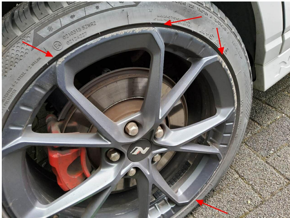
Bild 17 : Felge hinten rechts, verschrammt, lackieren mit Lackaufbau
