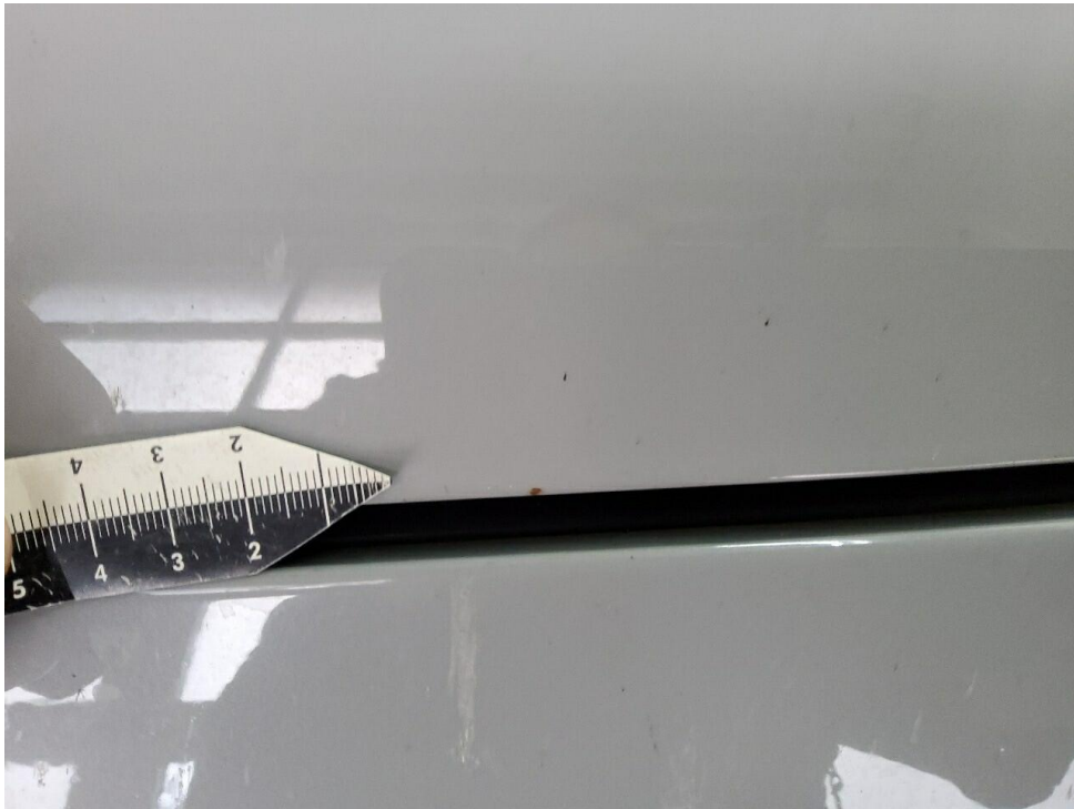
Bild 9 : Motorhaube Lackierung, Steinschlag, smart repair mit Korrosionsbildung
