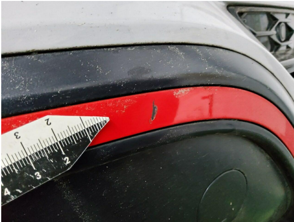
Bild 19 : Kratzer Zierleiste Stoßfänger hinten
