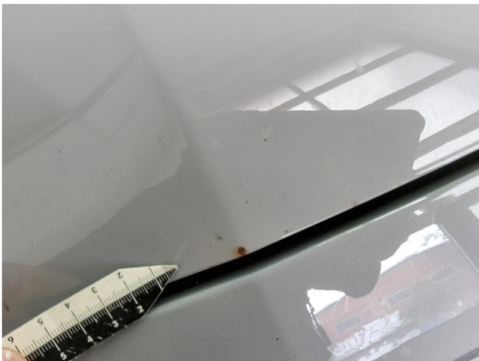
Bild 10 : Motorhaube Lackierung, Steinschlag, smart repair mit Korrosionsbildung
