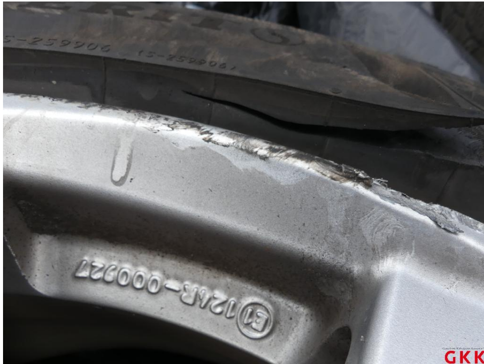
Bild 17. LM-Rad, 1 x beiliegend, beschädigt, ersetzen
