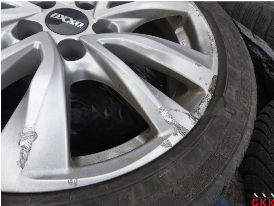
Bild 16. LM-Rad, 1 x beiliegend, beschädigt, ersetzen
