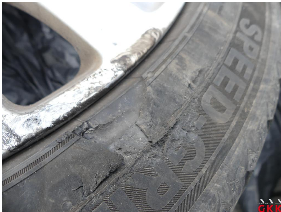
Bild 13. Reifen, 1 x beiliegend, beschädigt, ersetzen
