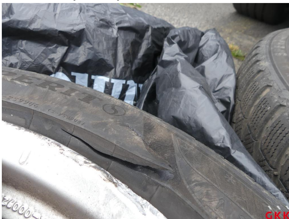
Bild 14. Reifen, 1 x beiliegend, beschädigt, ersetzen
