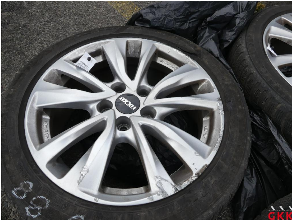
Bild 15. LM-Rad, 1 x beiliegend, beschädigt, ersetzen
