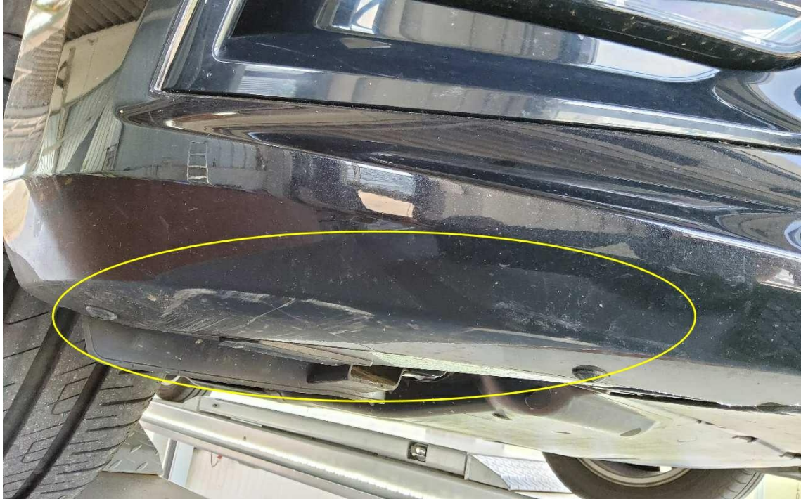
Bild 21 : Stoßfänger vorne Lackierung, verschrammt, smart repair
