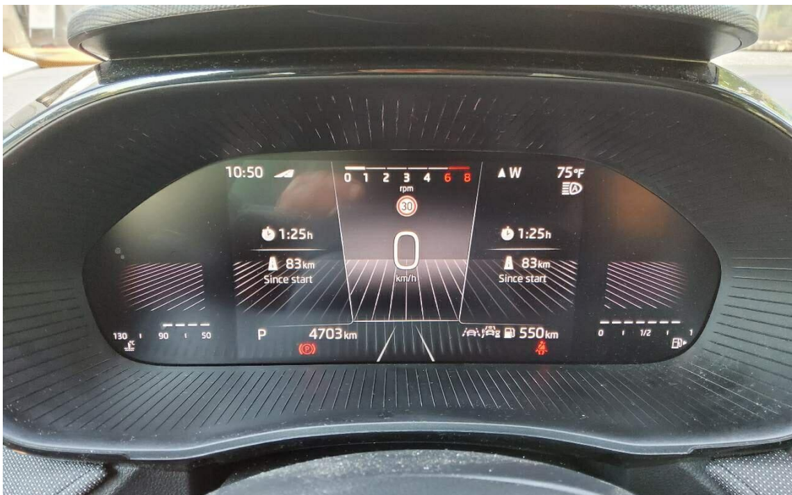
Bild 6 : Kombiinstrument (betriebsbereit) mit Km-Stand
