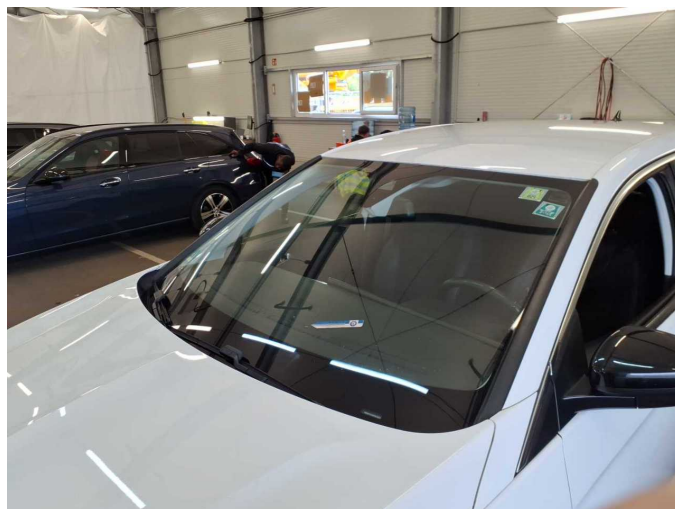
Damage 5: Vehicle glazing: Windscreen (Im Randbereich mit Rissbildung) - Stone chips - Replace
