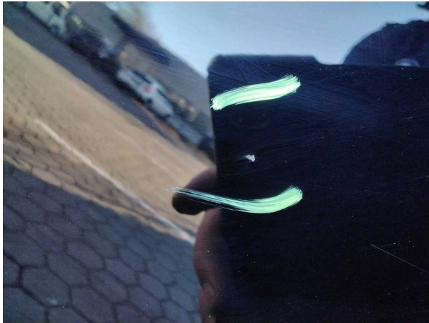
Beschädigung #6: Tür hinten links: Tür - Kratzer - lackieren
