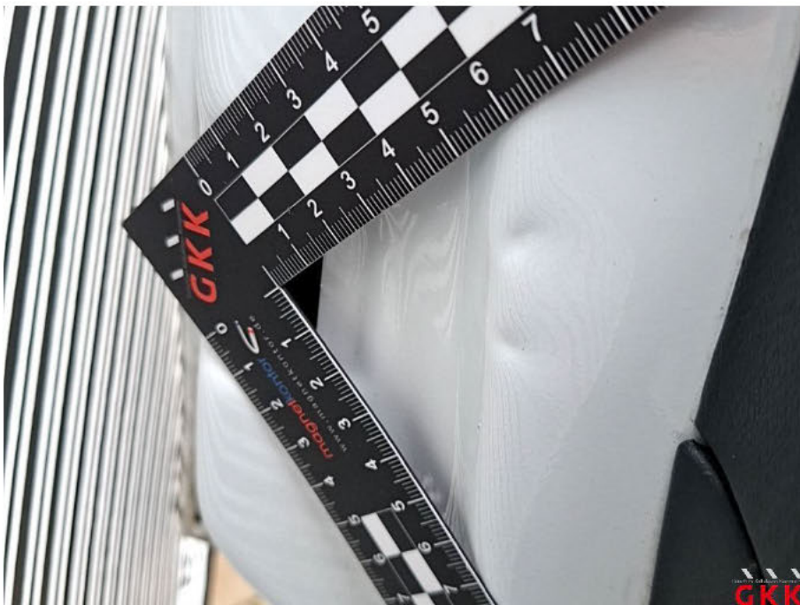
Bild 30 Tür vorne links, innen, beschädigt, instand setzen - lackieren
