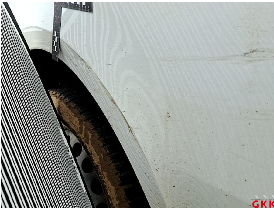
Bild 42 Seitenwand rechts, unterhalb, beschädigt, instand setzen - lackieren
