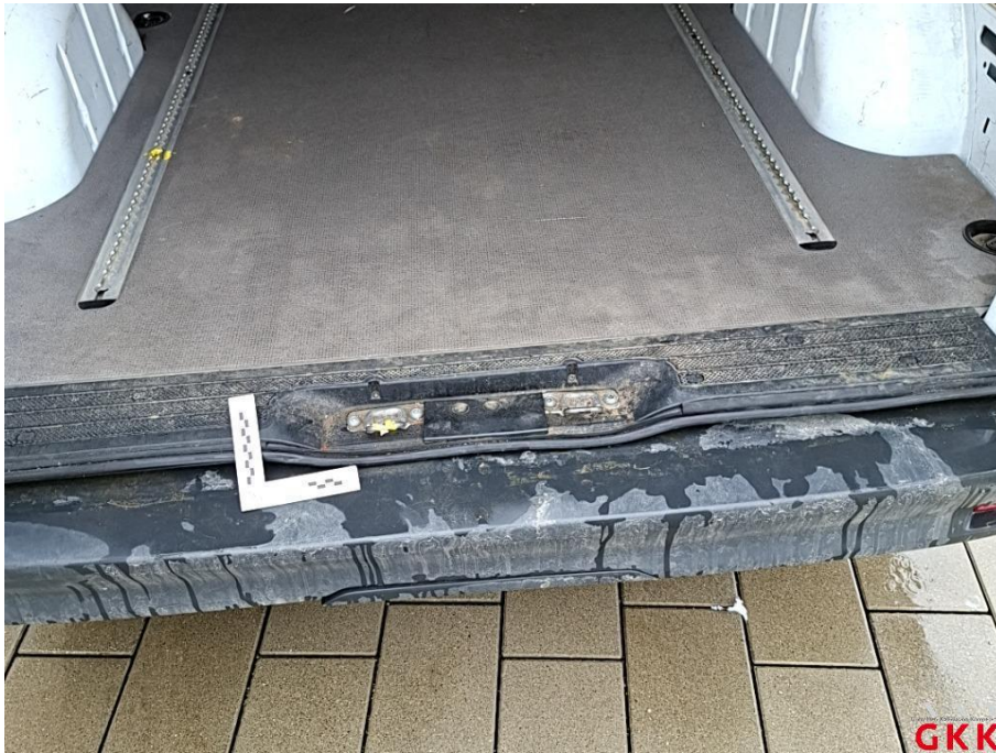
Bild 49 Laderaum, Dichtung, beschädigt, ersetzen
