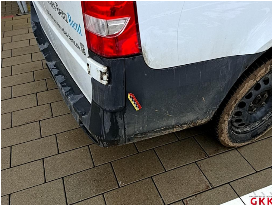
Bild 43 Stoßfänger hinten, Blende -unlackiert-, beschädigt, ersetzen
