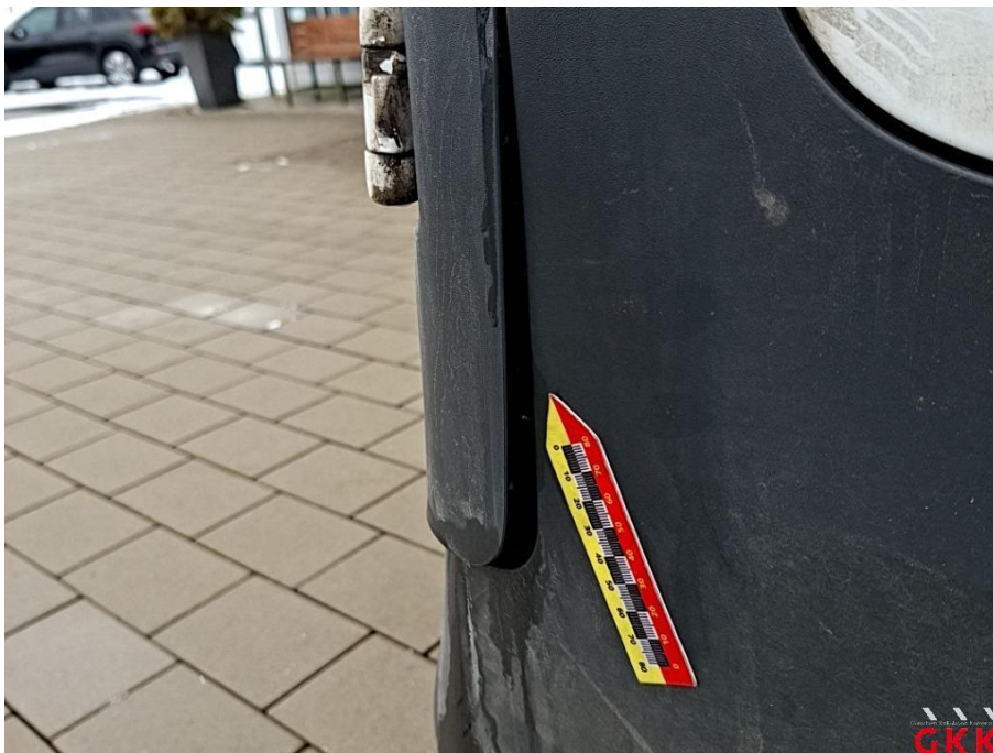
Bild 44 Stoßfänger hinten, Blende -unlackiert-, beschädigt, ersetzen
