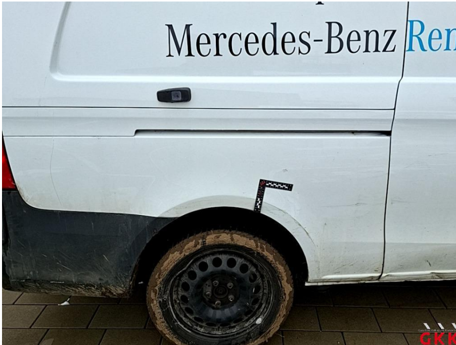
Bild 41 Seitenwand rechts, unterhalb, beschädigt, instand setzen - lackieren
