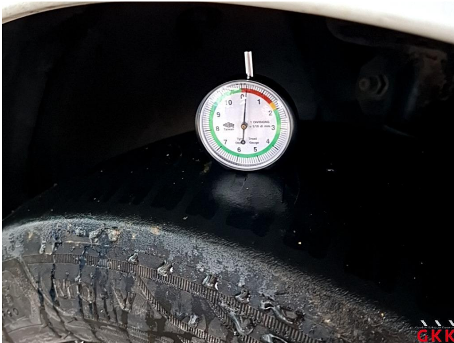
Bild 13 Reifen, vorn links und rechts, Untermaß, ersetzen
