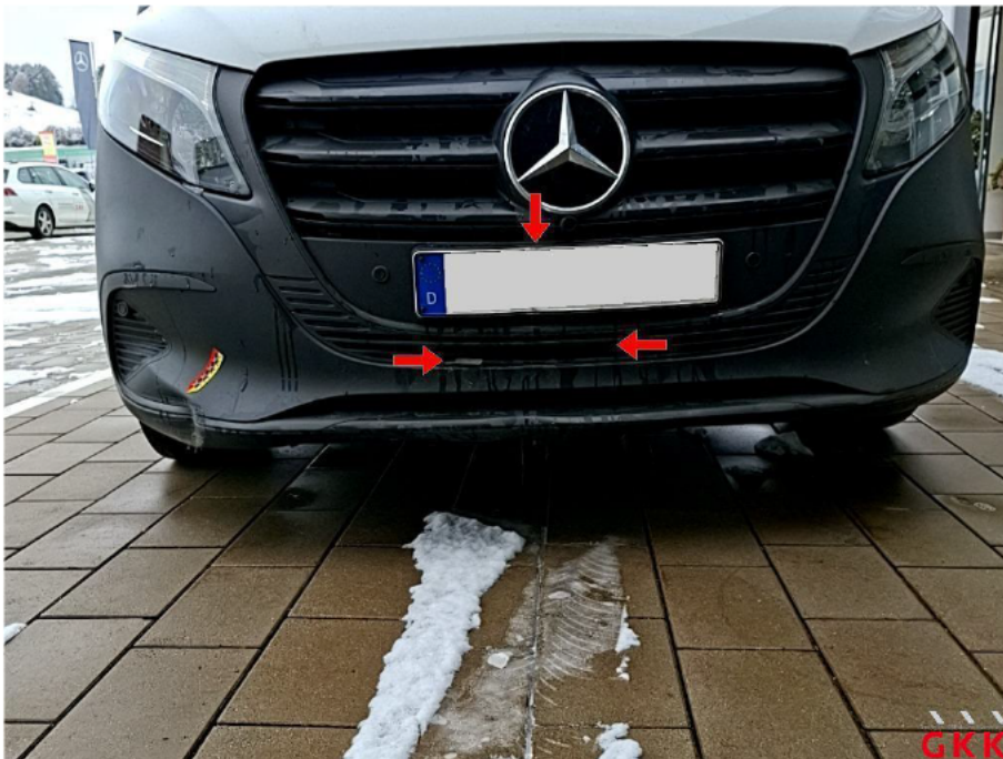
Bild 22 Fahrzeug, Front, Unfallschaden, Unfallschaden beheben
