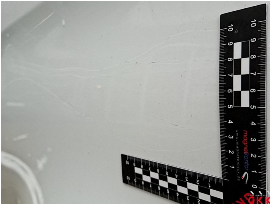
Bild 28 Seitenwand links, verkratzt, lackieren
