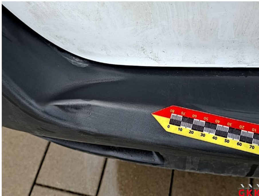
Bild 46 Stoßfänger hinten, Verkleidung -unlackiert-, beschädigt, ersetzen
