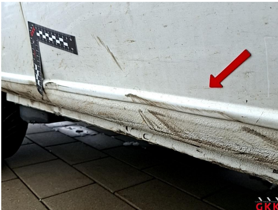
Bild 40 Schiebetür rechts, beschädigt, instand setzen - lackieren
