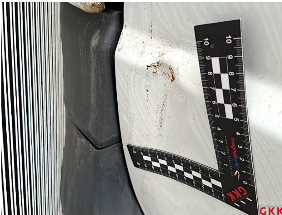
Bild 48 Hecktür links, beschädigt, instand setzen - lackieren
