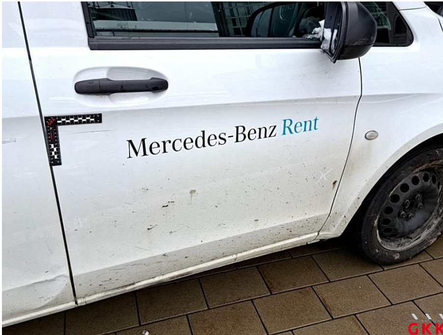
Bild 35 Tür vorne rechts, verkratzt, lackieren
