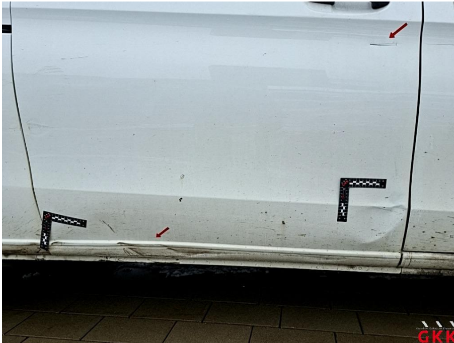
Bild 39 Schiebetür rechts, beschädigt, instand setzen - lackieren
