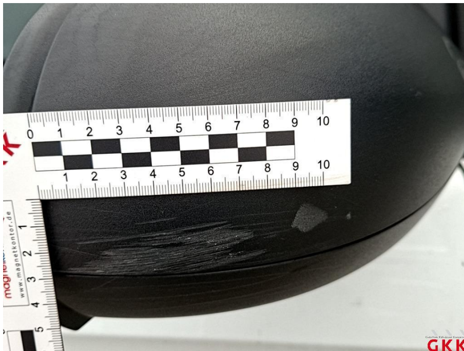
Bild 38 Spiegelgehäuse rechts, Kappe -unlackiert-, verkratzt, ersetzen
