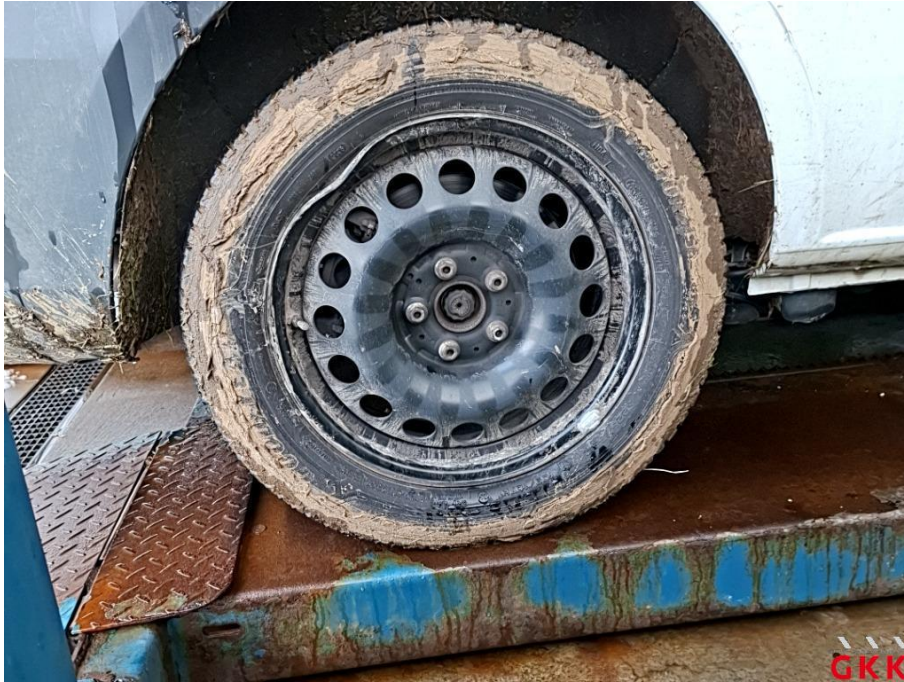
Bild 15 Stahlrad, hinten rechts, beschädigt, ersetzen
