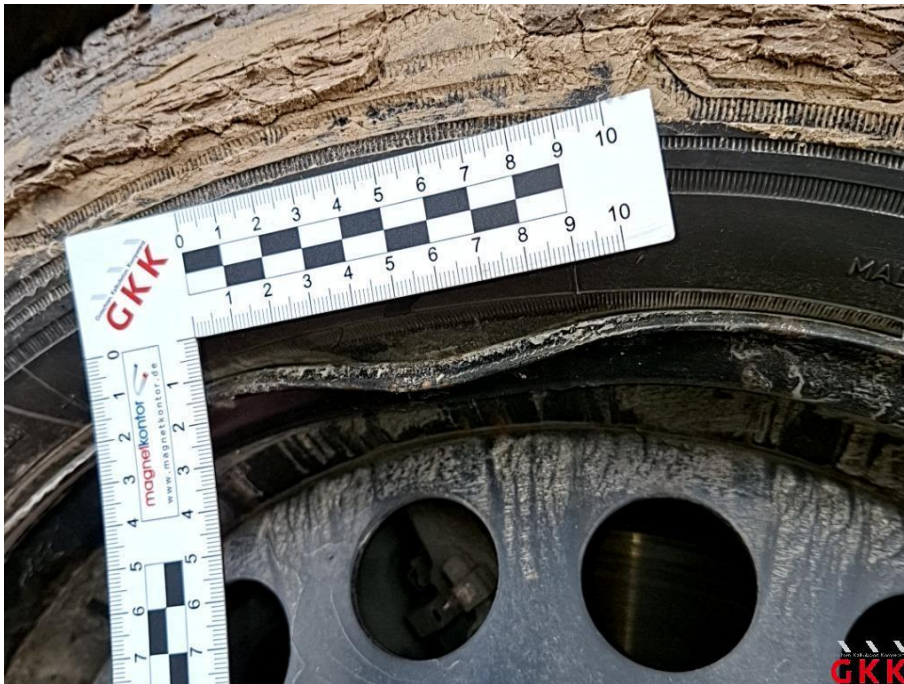
Bild 16 Stahlrad, hinten rechts, beschädigt, ersetzen
