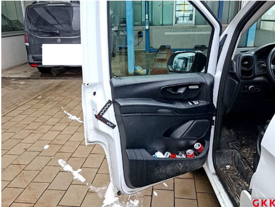
Bild 29 Tür vorne links, innen, beschädigt, instand setzen - lackieren
