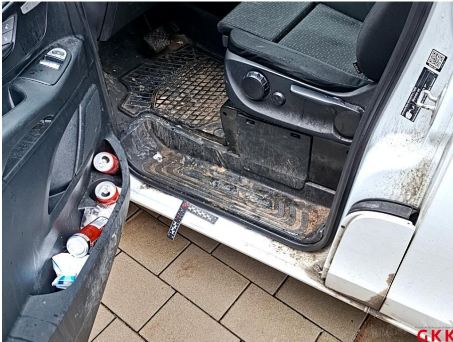
Bild 33 Tür vorne links, Einstieg, verkratzt, lackieren
