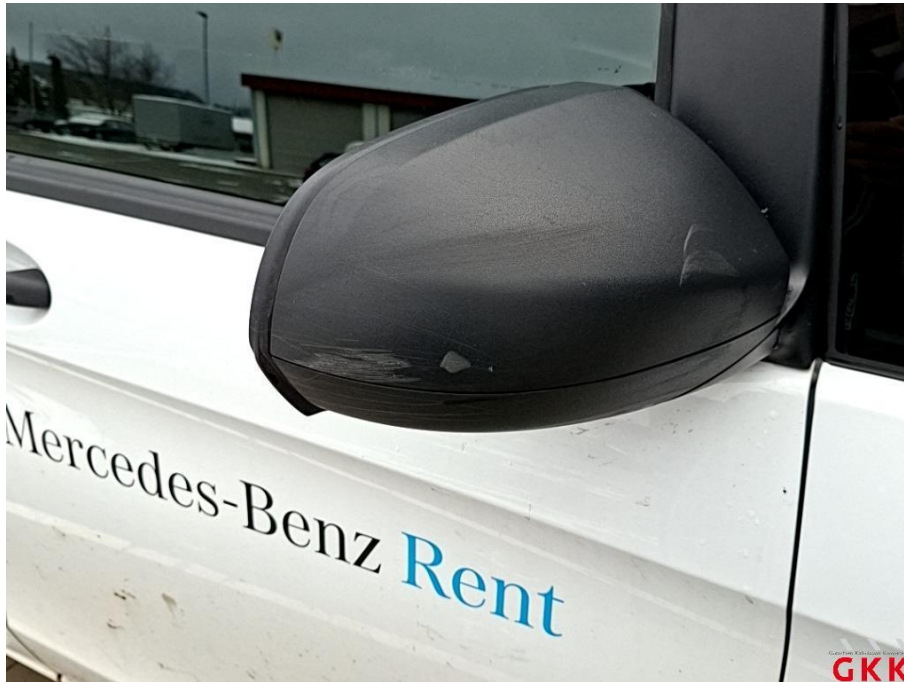
Bild 37 Spiegelgehäuse rechts, Kappe -unlackiert-, verkratzt, ersetzen
