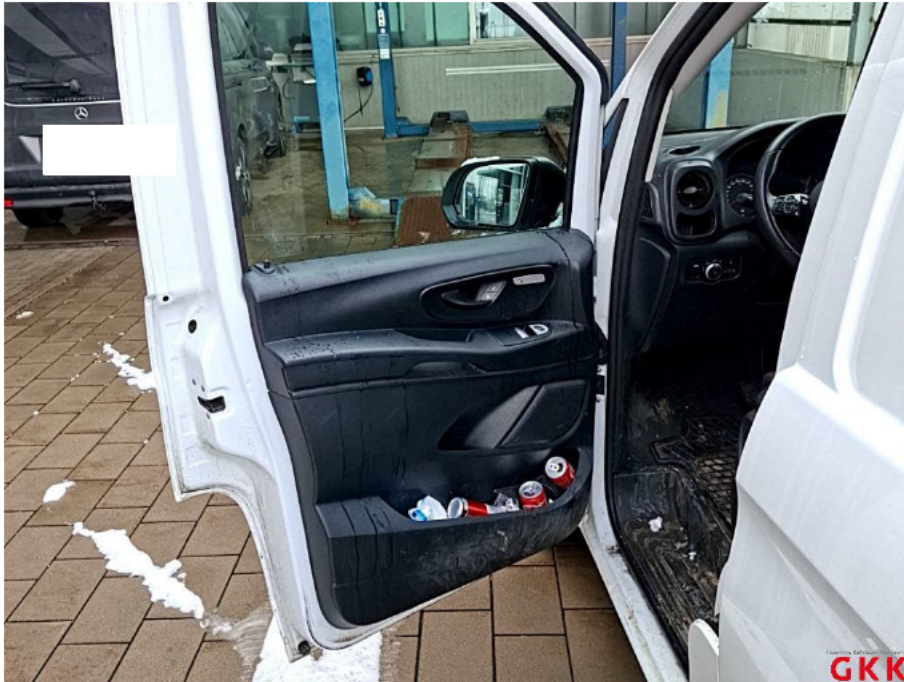
Bild 19 Tür vorne links, Fangband / Feststeller, untypische Geräusche, ersetzen
