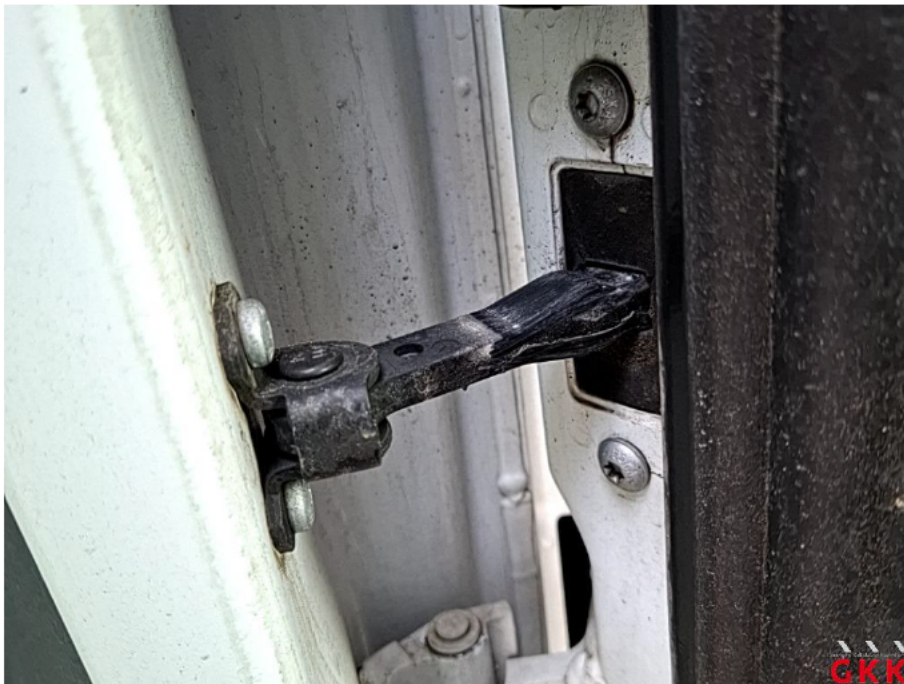
Bild 20 Tür vorne links, Fangband / Feststeller, untypische Geräusche, ersetzen
