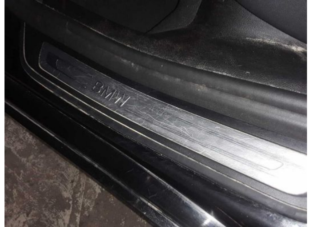
Beschädigung #2: Seitenwand links: Einstieg (Leiste) - verkratzt / verschürft - erneuern
