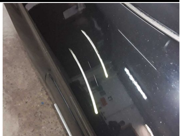
Beschädigung #7: Kotflügel links: Kotflügel links - verkratzt / verschürft - Smart Repair
