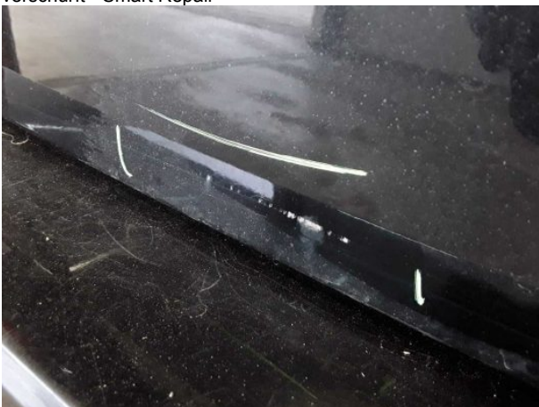
Beschädigung #9: Heckklappe/-tür: Heckklappe - verkratzt / verschürft - Smart Repair
