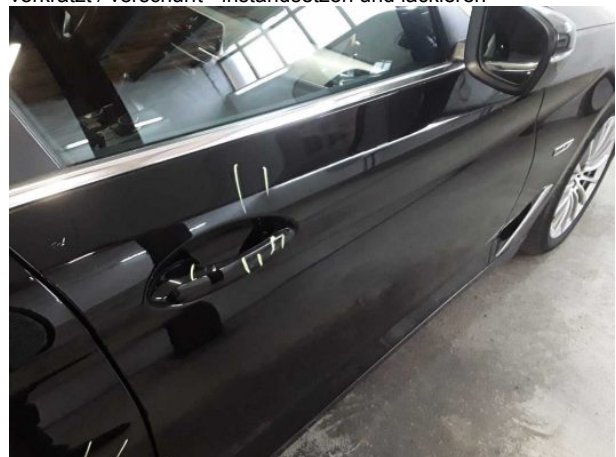
Beschädigung #15: Tür vorn rechts: Tür - verkratzt / verschü... - instandsetzen und lackieren
