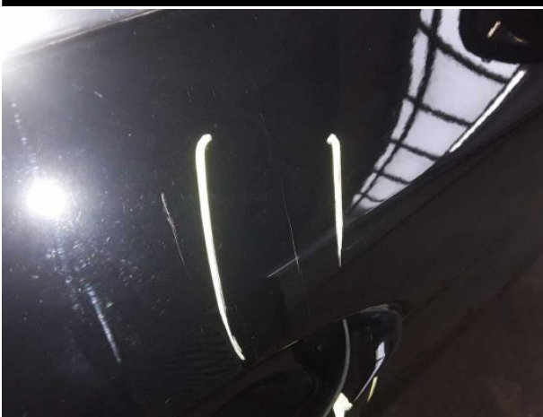
Beschädigung #15: Tür vorn rechts: Tür - verkratzt / verschürft - instandsetzen und lackieren
