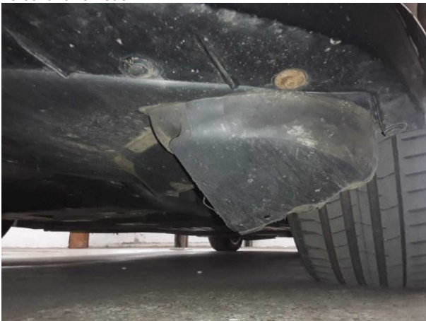
Beschädigung #5: Karosserie: Unterbodenverkleidung - beschädigt - erneuern
