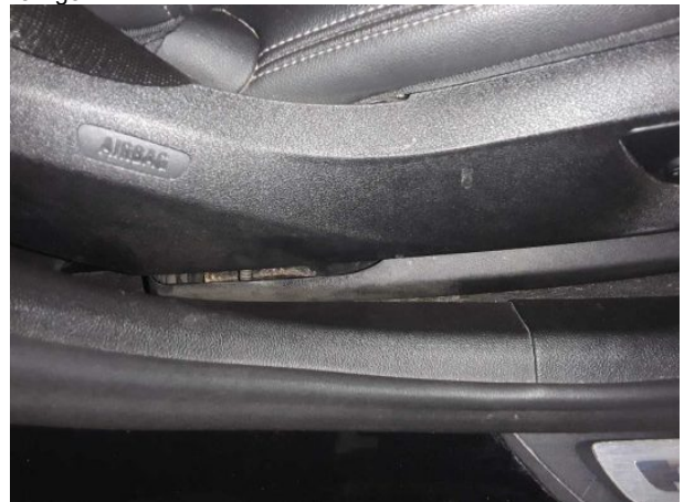
Beschädigung #6: Verkleidungen/Abdeckungen: Verkleidungen/Abdeckungen (Sitz vorne rechts) - lose -
