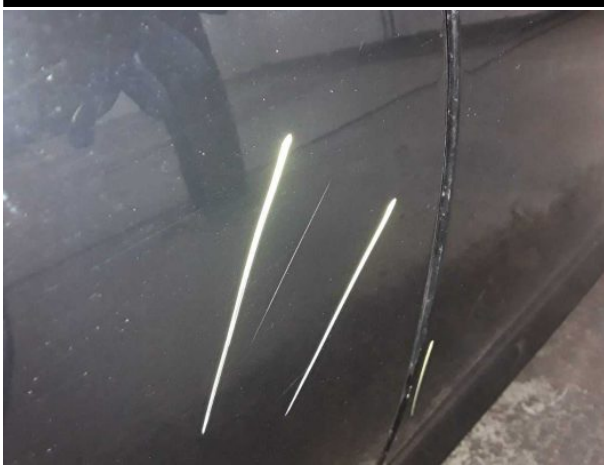
Beschädigung #12: Tür hinten rechts: Tür - verkratzt / verschürft - instandsetzen und lackieren
