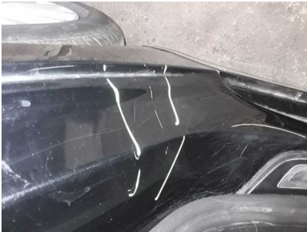
Beschädigung #10: Seitenwand links: Einstieg - verkratzt / verschürft - instandsetzen und lackieren
