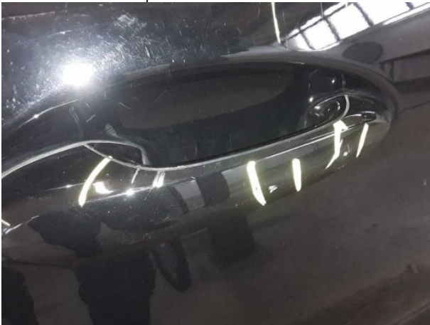
Beschädigung #8: Tür vorn rechts: Griff außen - verkratzt / verschürft - Smart Repair
