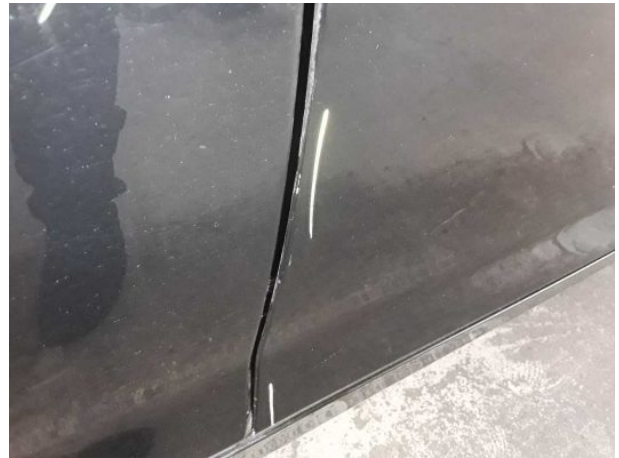
Beschädigung #15: Tür vorn rechts: Tür - verkratzt / verschürft - instandsetzen und lackieren
