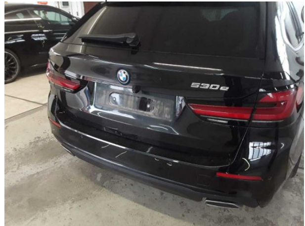
Beschädigung #9: Heckklappe/-tür: Heckklappe - verkratzt / verschürft - Smart Repair
