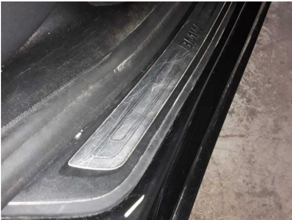
Beschädigung #3: Seitenwand rechts: Einstieg (Leiste) - verkratzt... verschürft - erneuern
