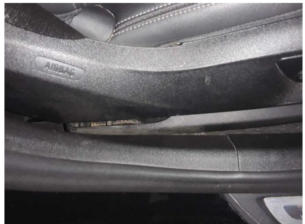
Damage #6: Trim / covers: Trim / covers (Sitz vorne rechts) - Loose - Replace
