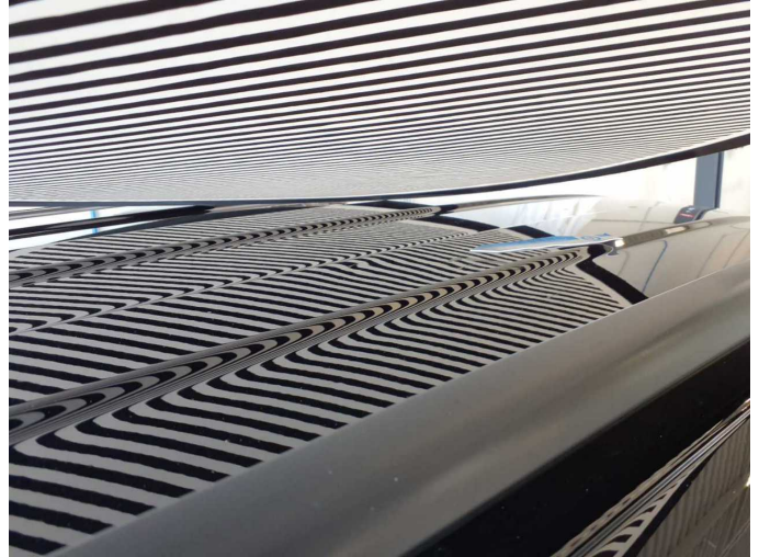
Damage 19: Roof: Roof (Anätzung) - Paint defect - Paint
