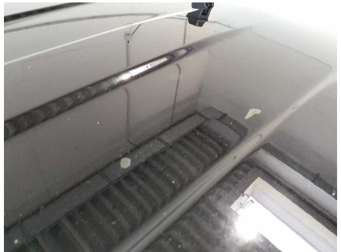
Damage 19: Roof: Roof (Anätzung) - Paint defect - Paint
