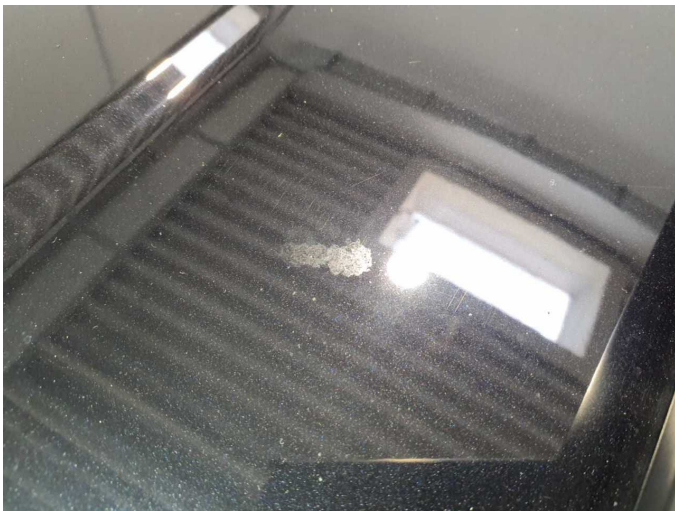
Damage 19: Roof: Roof (Anätzung) - Paint defect - Paint
