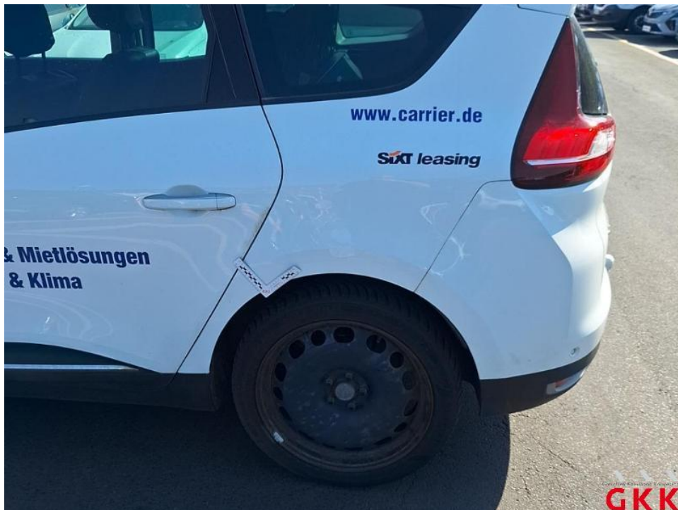
Bild 26. Seitenwand links, beschädigt, instand setzen - lackieren
