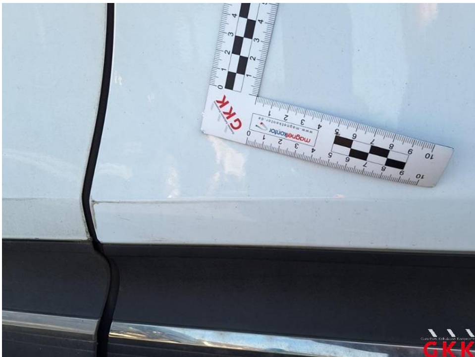
Bild 64. Tür hinten links, beschädigt, instand setzen - lackieren
