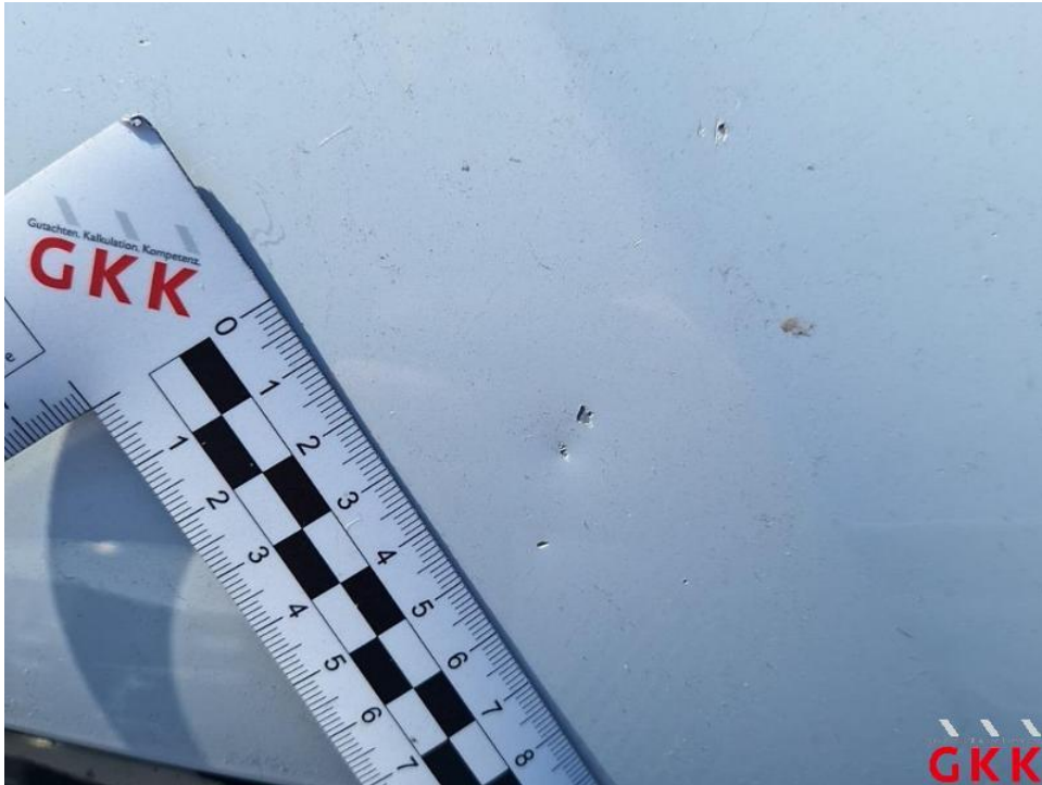
Bild 43. Motorhaube, beschädigt, instand setzen - lackieren
