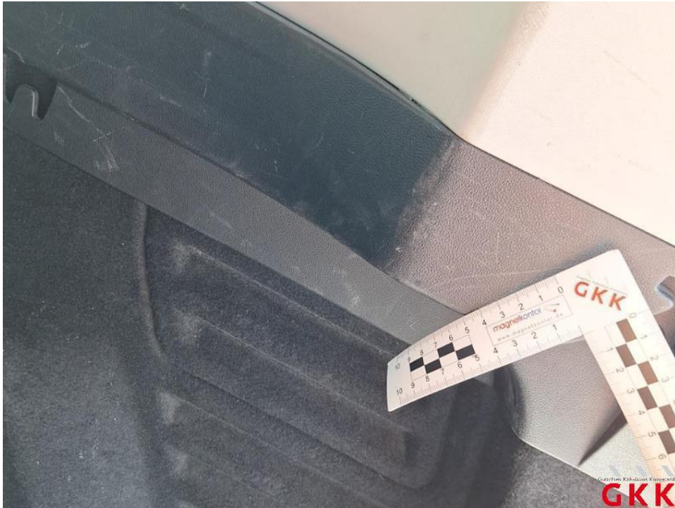
Bild 51. Seitenwand rechts, Innenverkleidung, beschädigt, ersetzen
