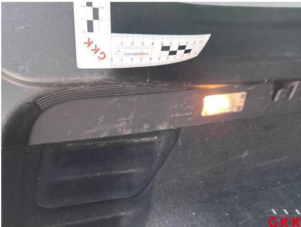
Bild 48. Seitenwand links, Innenverkleidung, beschädigt, ersetzen
