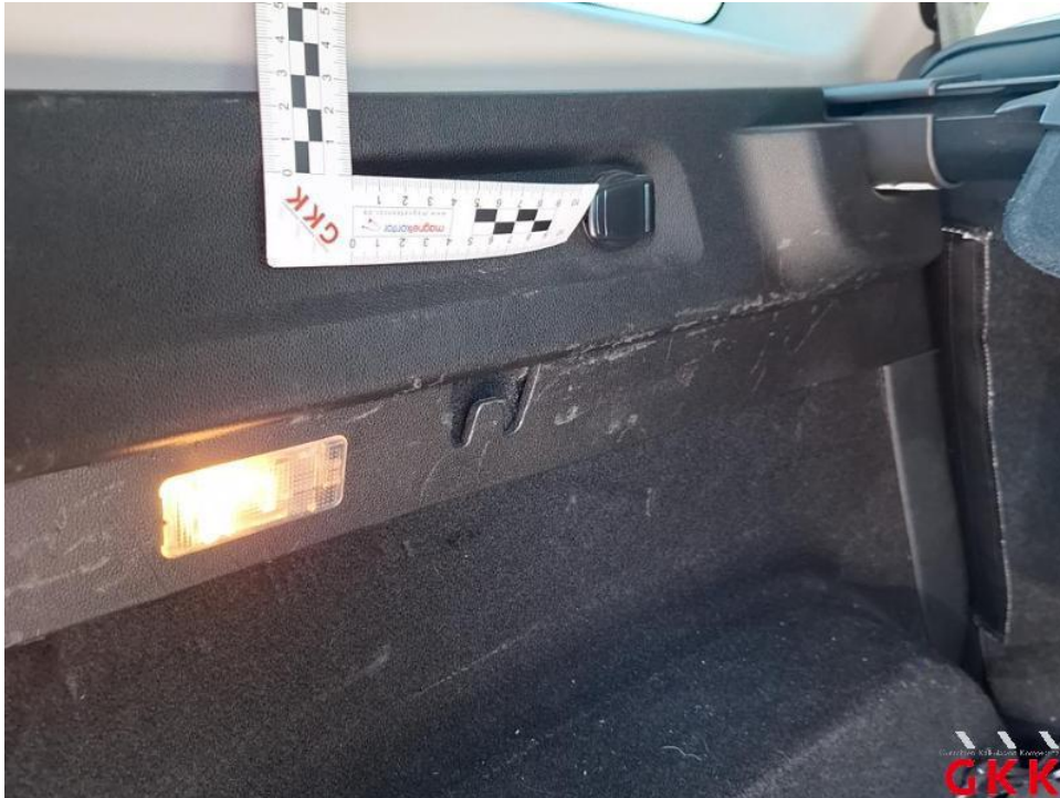
Bild 49. Seitenwand links, Innenverkleidung, beschädigt, ersetzen
