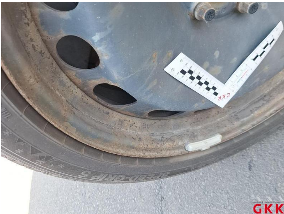
Bild 24. Stahlrad, vorne links, korrodiert, ersetzen
