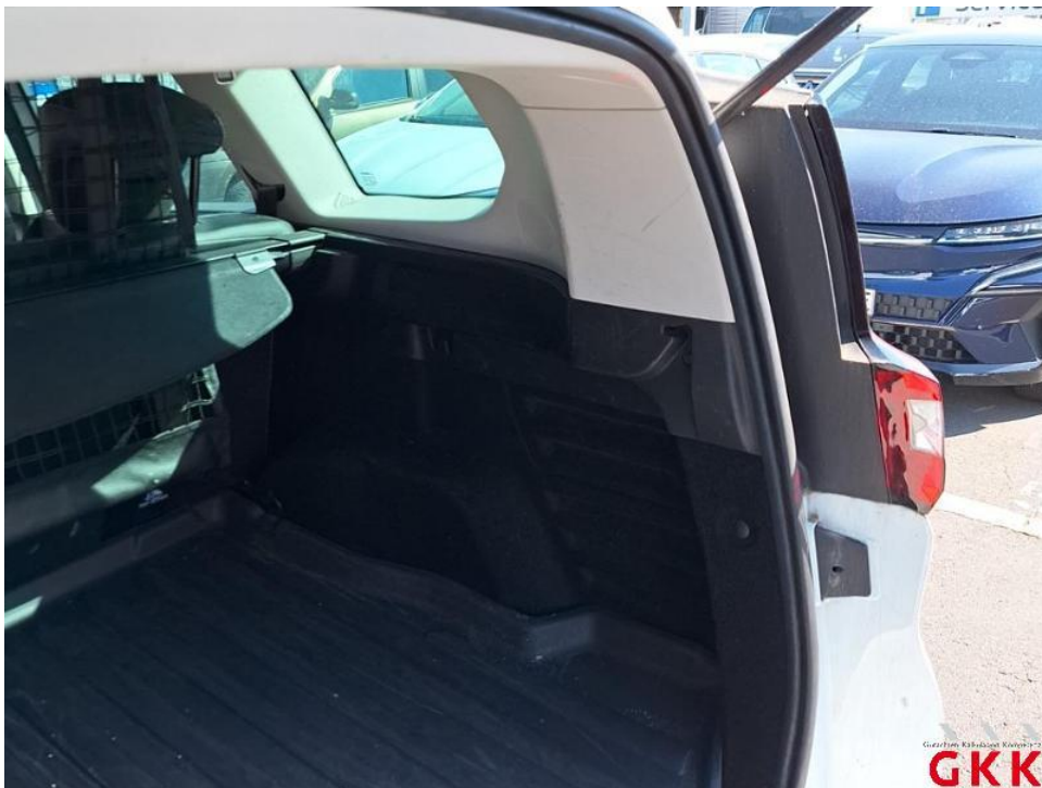
Bild 50. Seitenwand rechts, Innenverkleidung, beschädigt, ersetzen
