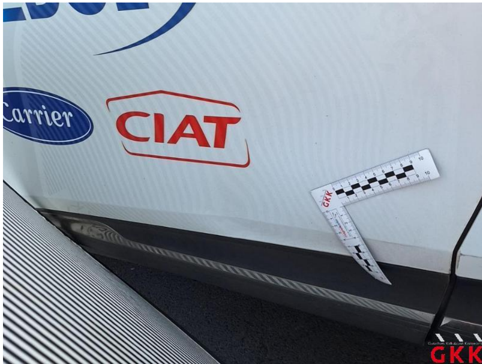
Bild 61. Tür vorne links, beschädigt, instand setzen - lackieren
