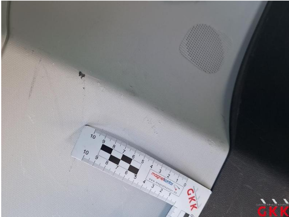
Bild 57. D- Säule links, Innenverkleidung, beschädigt, ersetzen
