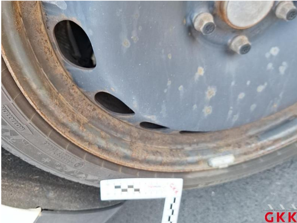
Bild 21. Stahlrad, hinten links, korrodiert, ersetzen
