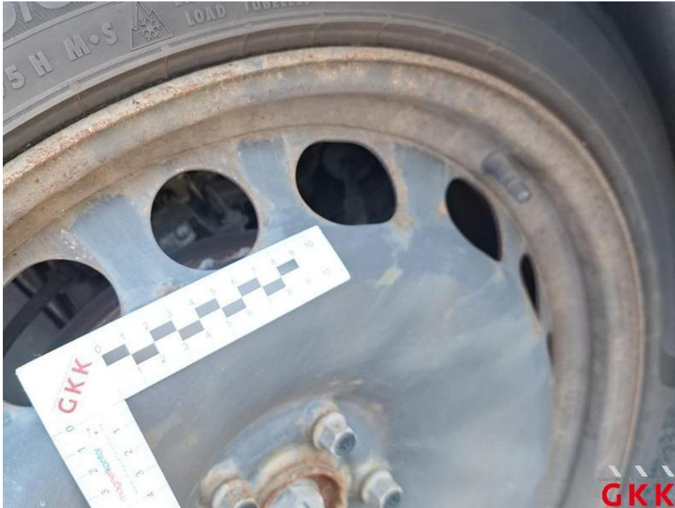
Bild 25. Stahlrad, vorne links, korrodiert, ersetzen
