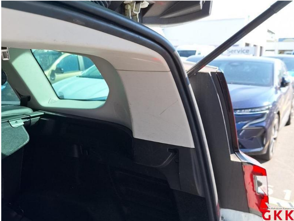
Bild 53. D- Säule rechts, Innenverkleidung, beschädigt, ersetzen
