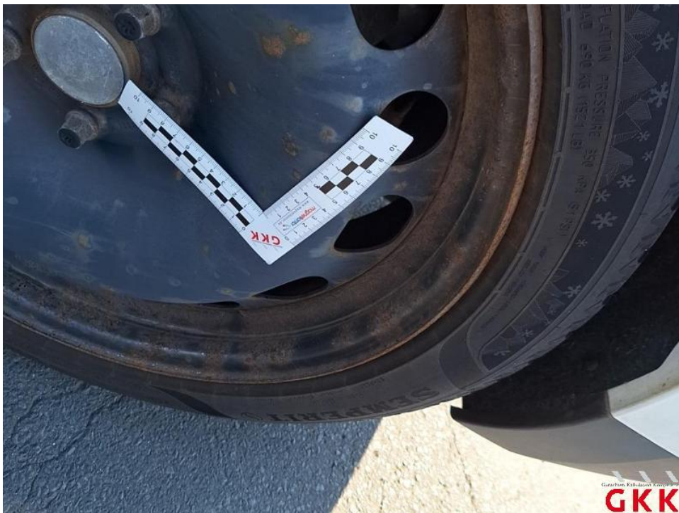
Bild 22. Stahlrad, hinten links, korrodiert, ersetzen
