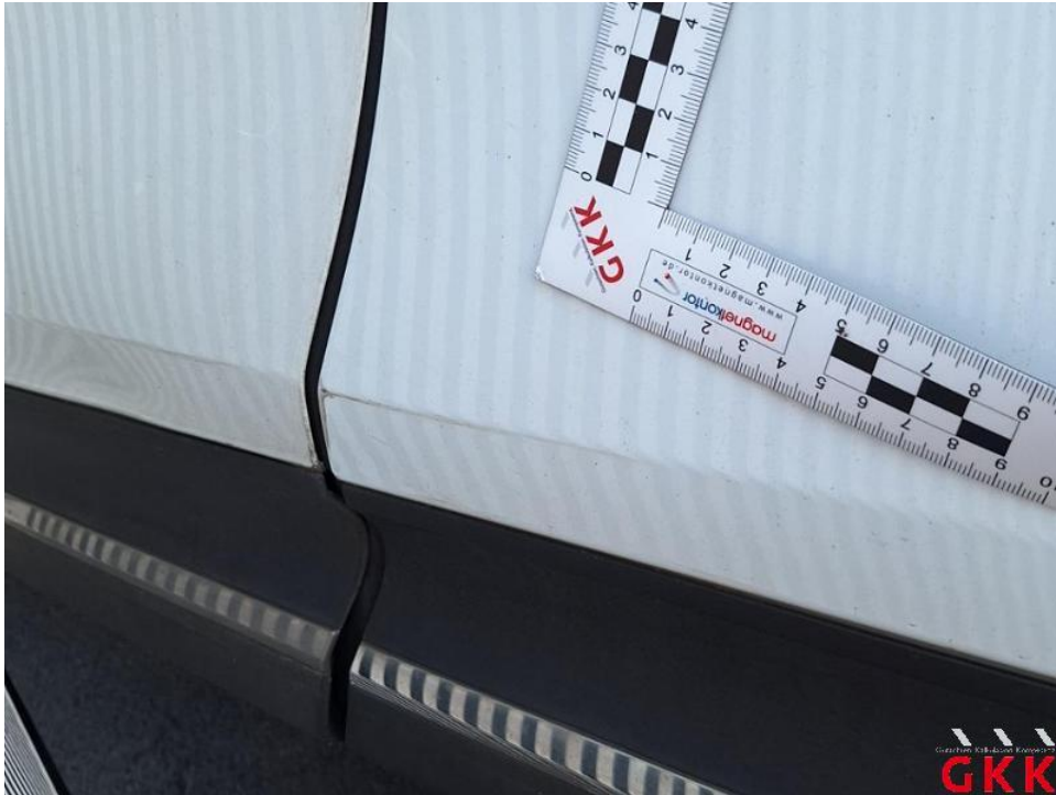
Bild 63. Tür hinten links, beschädigt, instand setzen - lackieren
