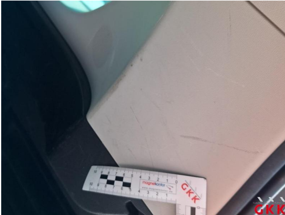
Bild 55. D- Säule rechts, Innenverkleidung, beschädigt, ersetzen
