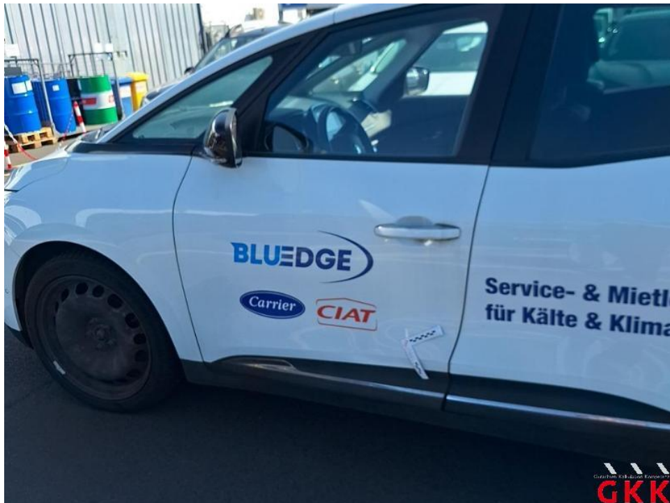
Bild 59. Tür vorne links, beschädigt, instand setzen - lackieren
