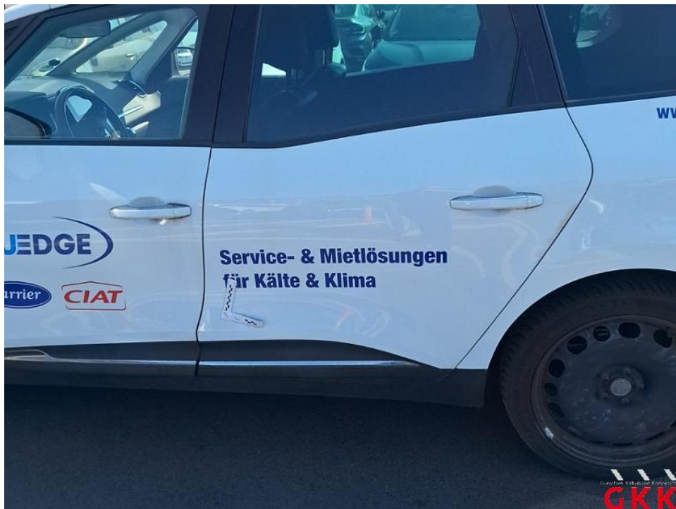
Bild 62. Tür hinten links, beschädigt, instand setzen - lackieren
