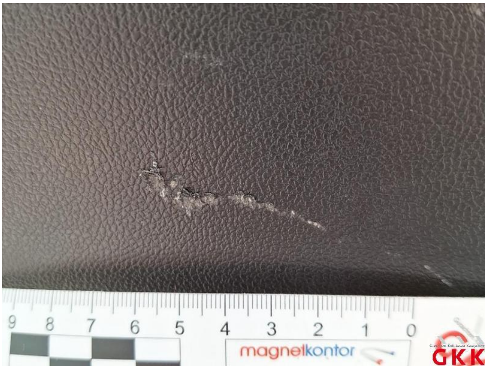
Bild 52. Seitenwand rechts, Innenverkleidung, beschädigt, ersetzen
