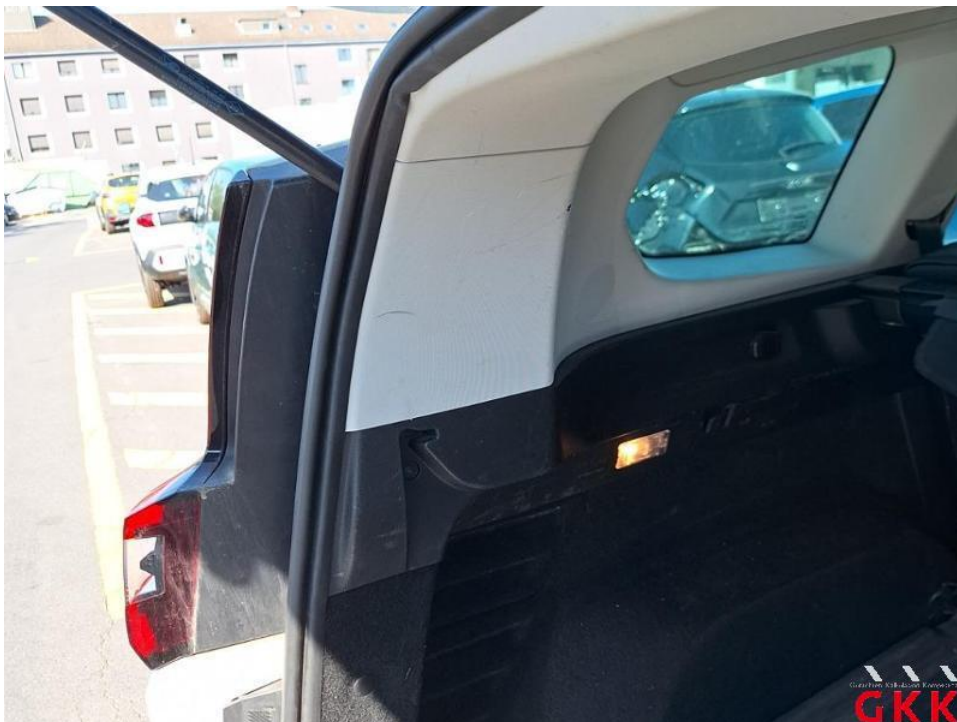
Bild 56. D- Säule links, Innenverkleidung, beschädigt, ersetzen
