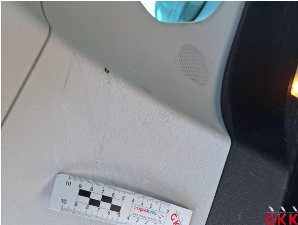
Bild 58. D- Säule links, Innenverkleidung, beschädigt, ersetzen
