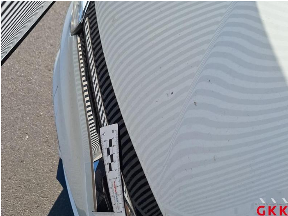
Bild 42. Motorhaube, beschädigt, instand setzen - lackieren
