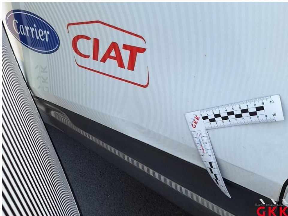
Bild 60. Tür vorne links, beschädigt, instand setzen - lackieren
