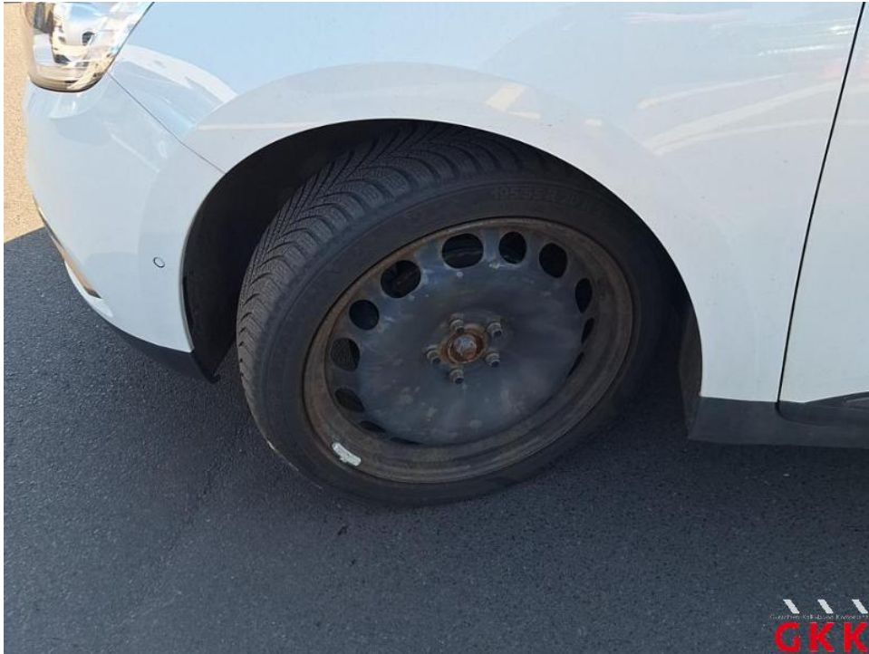
Bild 23. Stahlrad, vorne links, korrodiert, ersetzen
