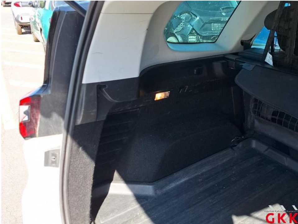
Bild 47. Seitenwand links, Innenverkleidung, beschädigt, ersetzen
