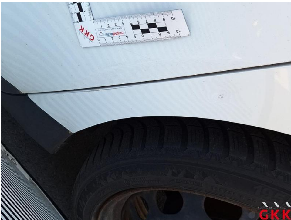
Bild 28. Seitenwand links, beschädigt, instand setzen - lackieren
