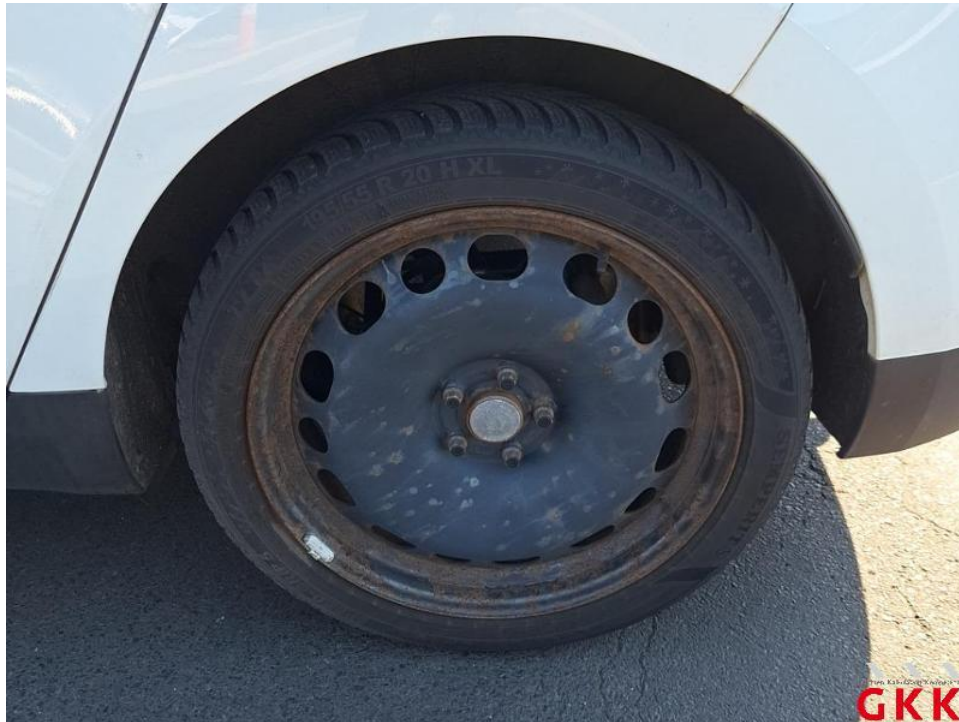
Bild 20. Stahlrad, hinten links, korrodiert, ersetzen
