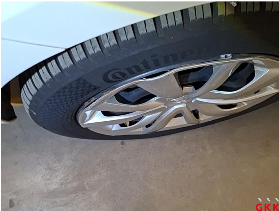
Bild 24 Radkappe(n), vorne links, beschädigt, ersetzen
