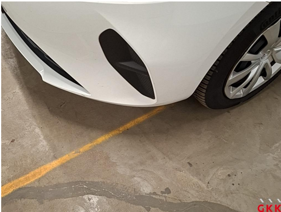
Bild 38 Stoßfänger vorne, Verkleidung -lackiert-, verkratzt, lackieren
