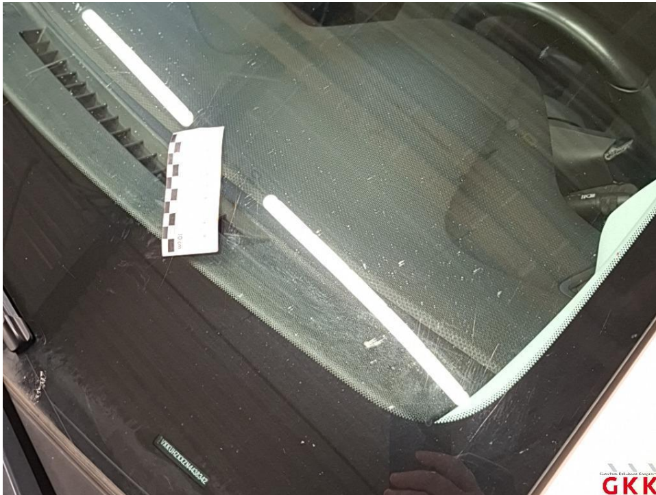
Bild 25 Frontscheibe, mit Regensensor und Frontkamera, verkratzt, ersetzen
