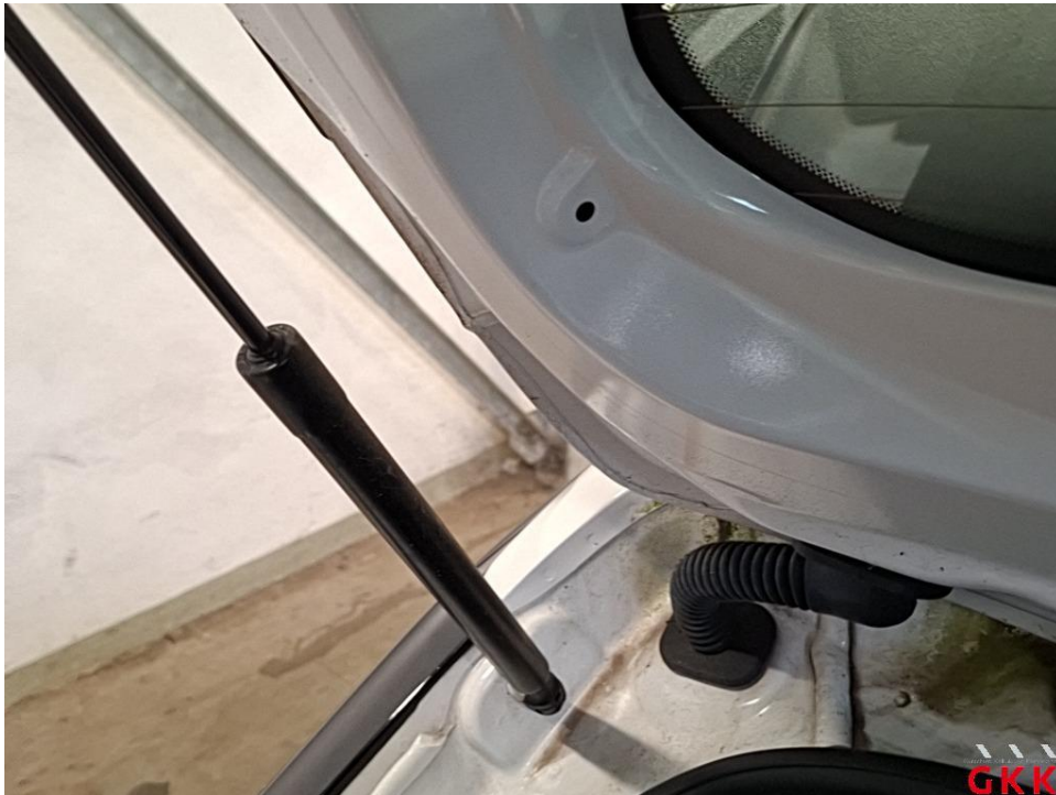
Bild 35 Halterung Seil Laderaumabdeckung links, fehlt, ersetzen
