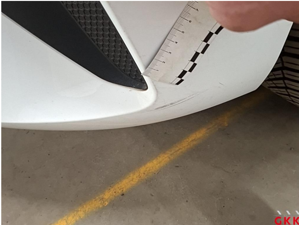
Bild 39 Stoßfänger vorne, Verkleidung -lackiert-, verkratzt, lackieren
