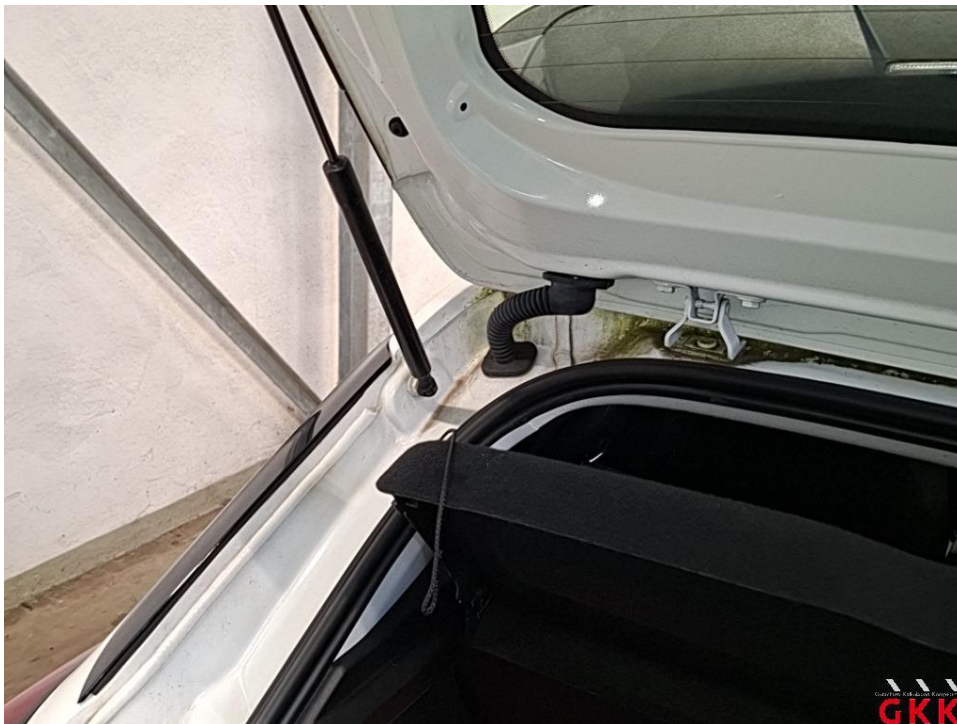
Bild 34 Halterung Seil Laderaumabdeckung links, fehlt, ersetzen
