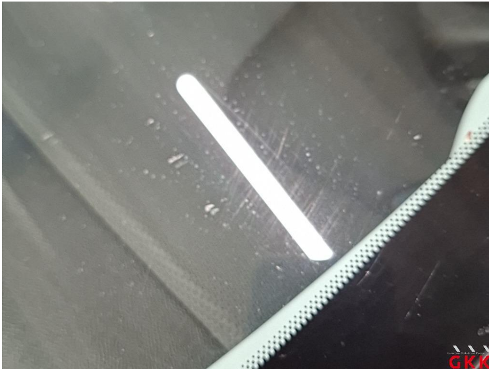
Bild 27 Frontscheibe, mit Regensensor und Frontkamera, verkratzt, ersetzen
