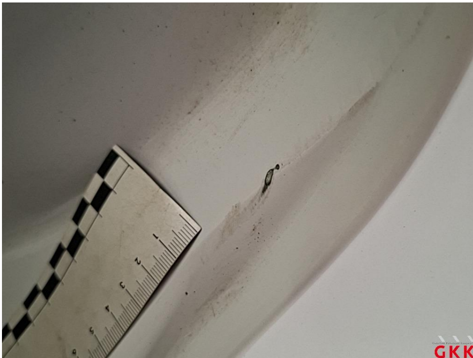
Bild 32 Tür hinten links, Einstieg, verkratzt, Spotlackieren
