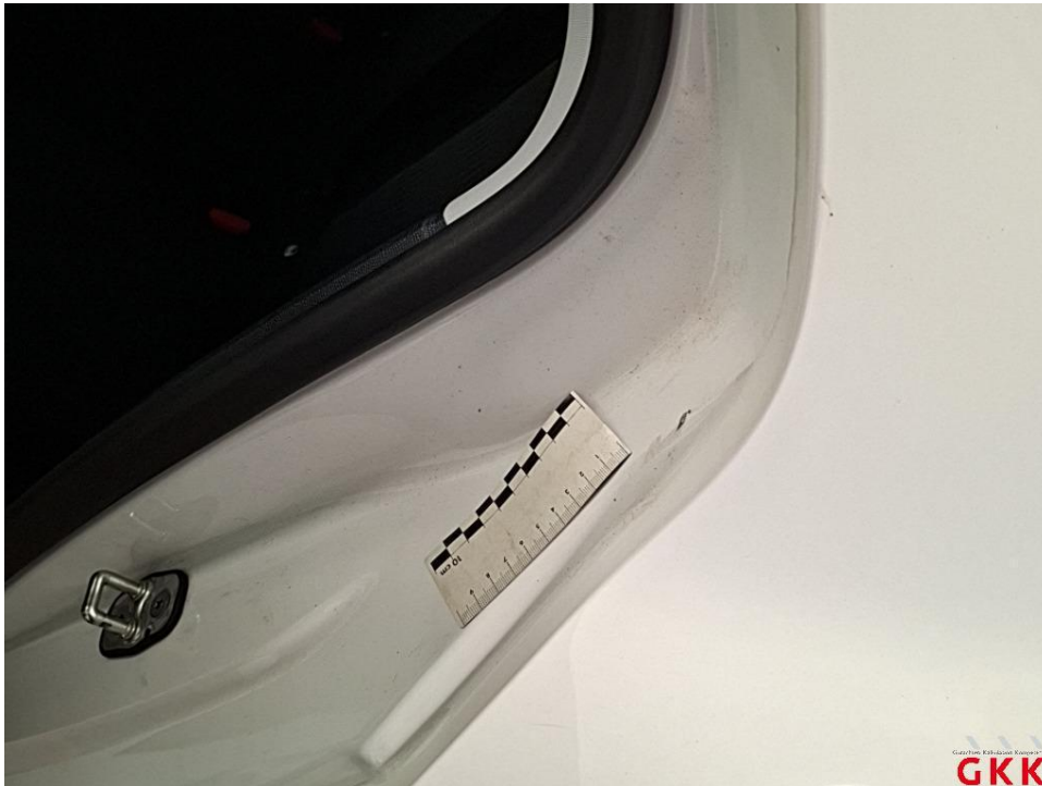
Bild 31 Tür hinten links, Einstieg, verkratzt, Spotlackieren
