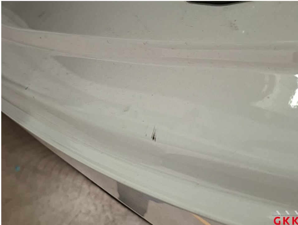
Bild 33 Tür hinten links, Einstieg, verkratzt, Spotlackieren
