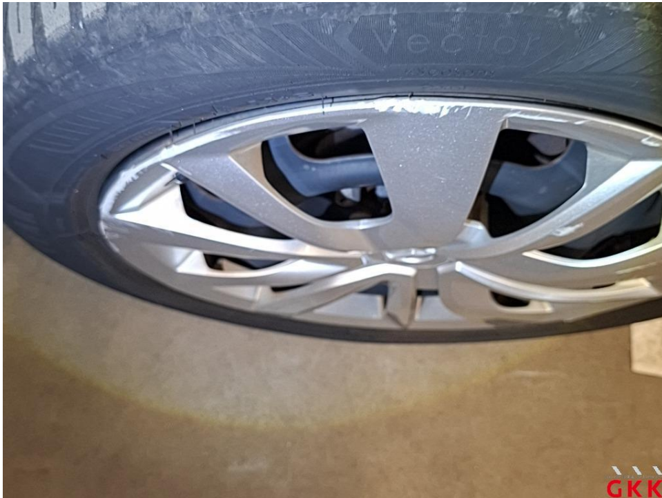
Bild 19 Radkappe(n), vorne rechts, beschädigt, ersetzen
