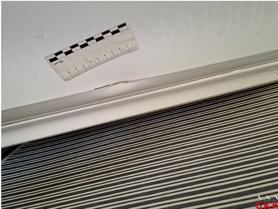
Bild 43 Tür vorne rechts, beschädigt, ersetzen
