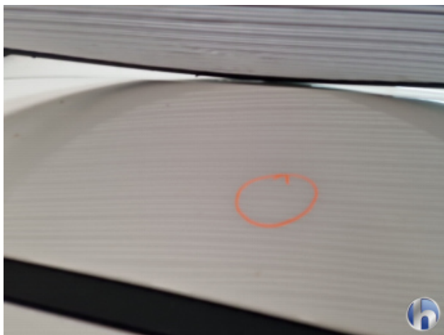
6. Dach Dellen / Beulen - Sanft Instandsetzen
