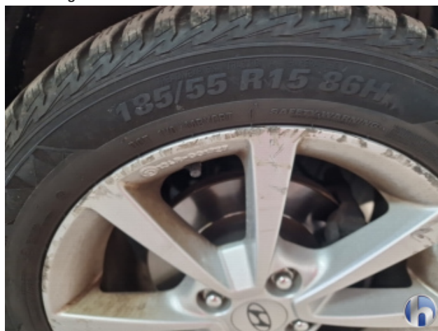
2. Felge Vorne - Rechts Beschädigt - Erneuern
