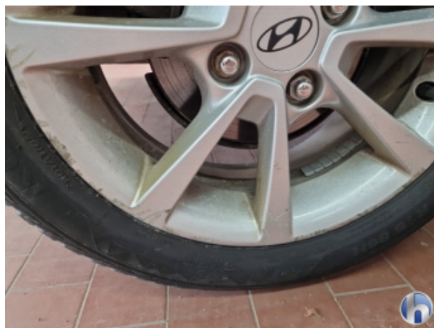
1. Felge Hinten - Rechts Beschädigt - Erneuern
