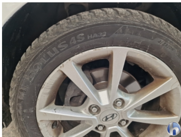
3. Felge Vorne - Links Beschädigt - Erneuern
