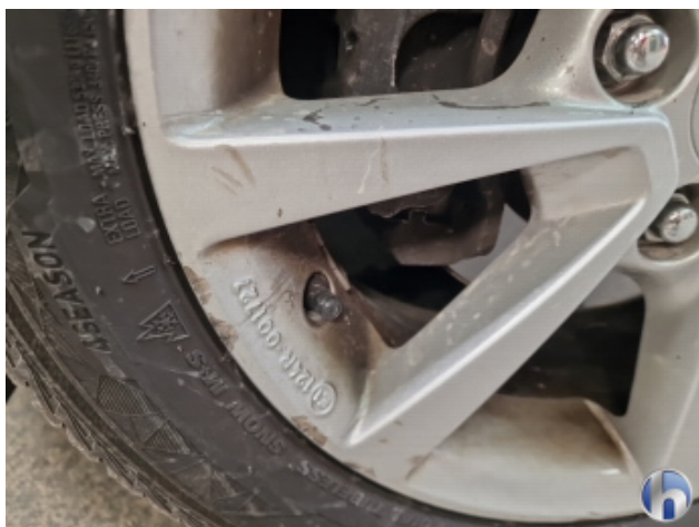
3. Felge Vorne - Links Beschädigt - Erneuern
