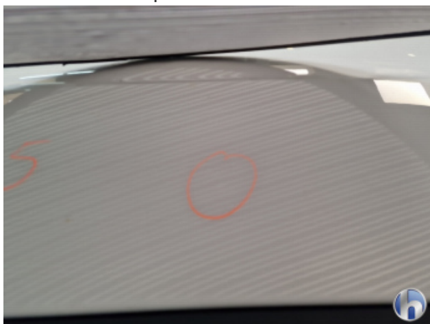
6. Dach Dellen / Beulen - Sanft Instandsetzen
