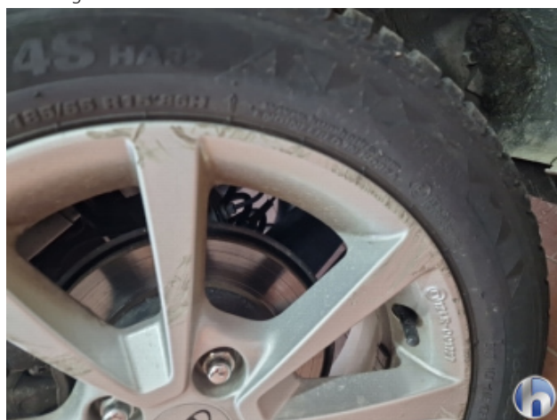
1. Felge Hinten - Rechts Beschädigt - Erneuern
