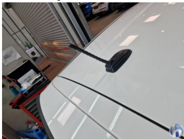
9. Antenne Beschädigt - Erneuern
