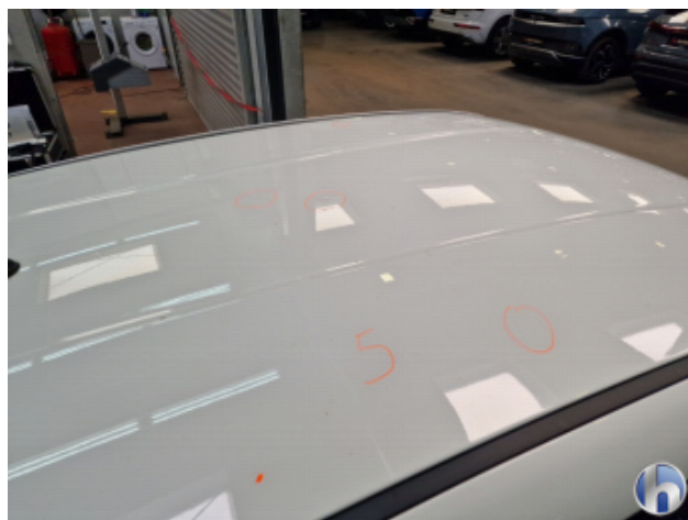
6. Dach Dellen / Beulen - Sanft Instandsetzen
