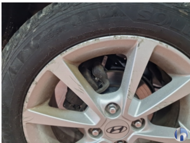
1. Felge Hinten - Rechts Beschädigt - Erneuern
