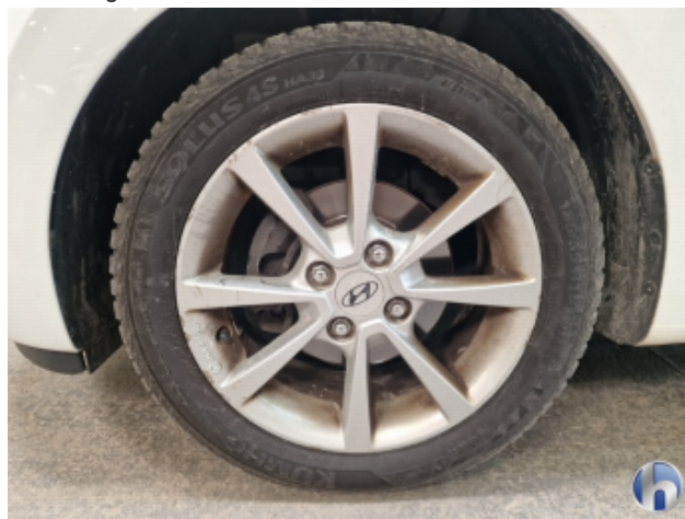
3. Felge Vorne - Links Beschädigt - Erneuern
