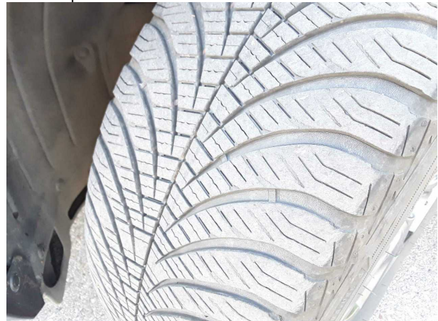
Beschädigung #4: Rad/Reifen: Reifen vorn (2 x Ganzjahresreifen vorne unter 4 mm Profiltiefe) - verschlissen -
