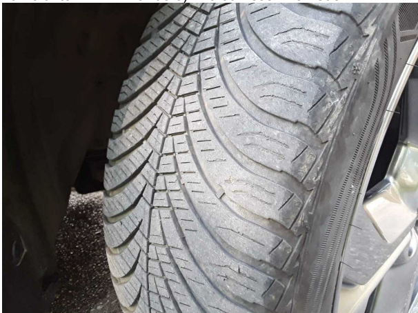
Beschädigung #4: Rad/Reifen: Reifen vorn (2 x Ganzjahresreifen vorne unter 4 mm Profiltiefe) - verschlissen - erneuern
