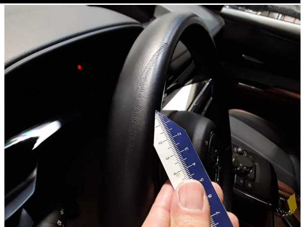
Beschädigung #5: Lenkanlage: Lenkrad (Materialabrieb) - Kratzer - erneuern
