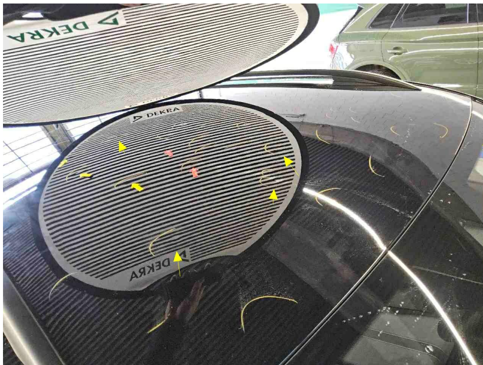
Bild 19 : Hagelschaden, Dach 98, Rahmen rechts 4, Türe hinten rechts 1,
