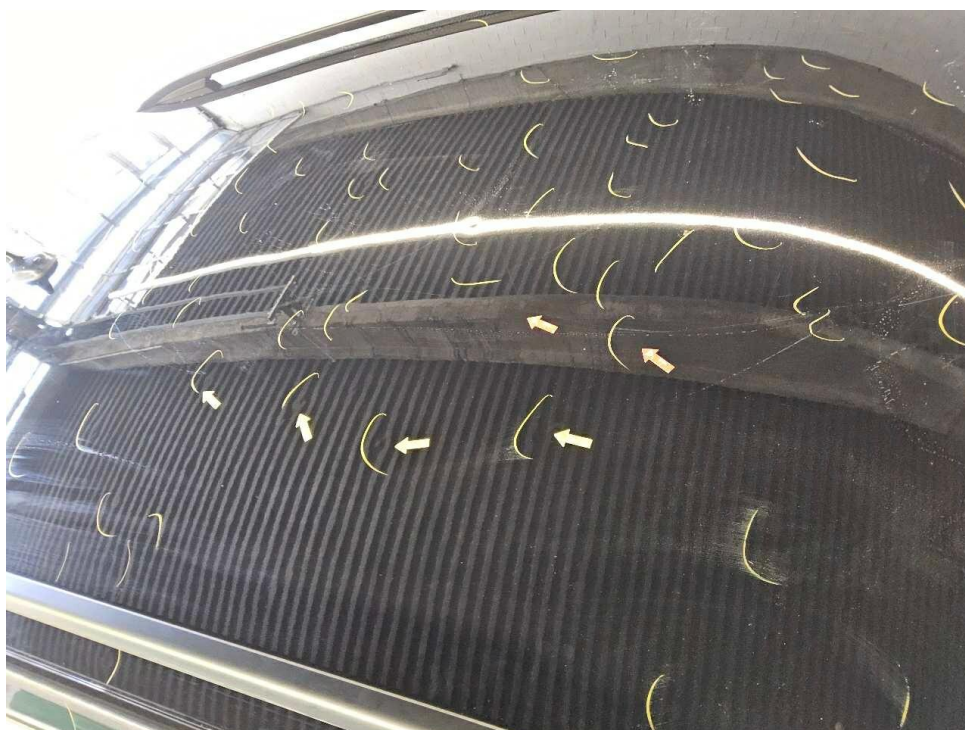
Bild 20 : Hagelschaden, Dach 98, Rahmen rechts 4, Türe hinten rechts 1,
