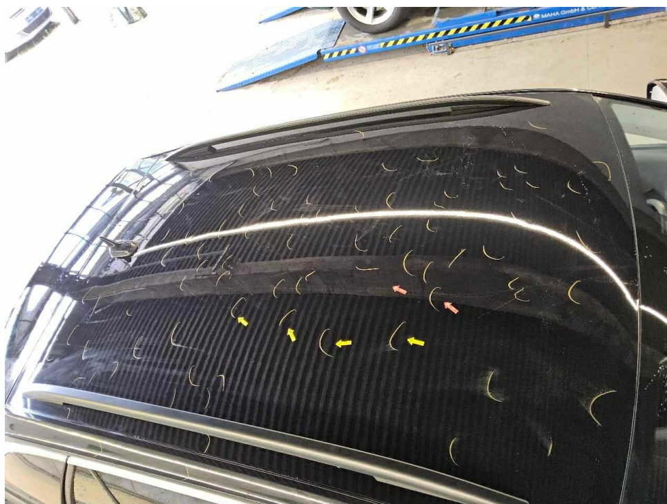
Bild 18 : Hagelschaden, Dach 98, Rahmen rechts 4, Türe hinten rechts 1,
