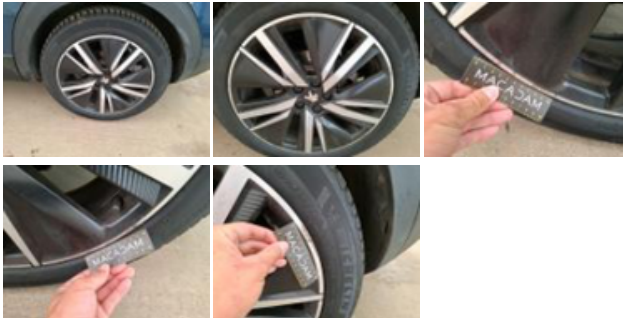
Pneu ARG, Déchirure, E - Remplacer
