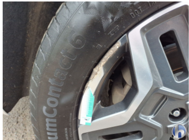
6. Felge Hinten - Rechts Beschädigt - Smart Repair
