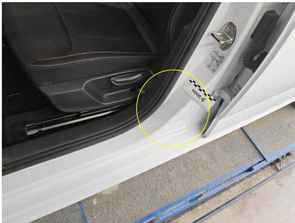
Bild 20 : Tür vorne links Einstieg, eingedellt, smart repair
