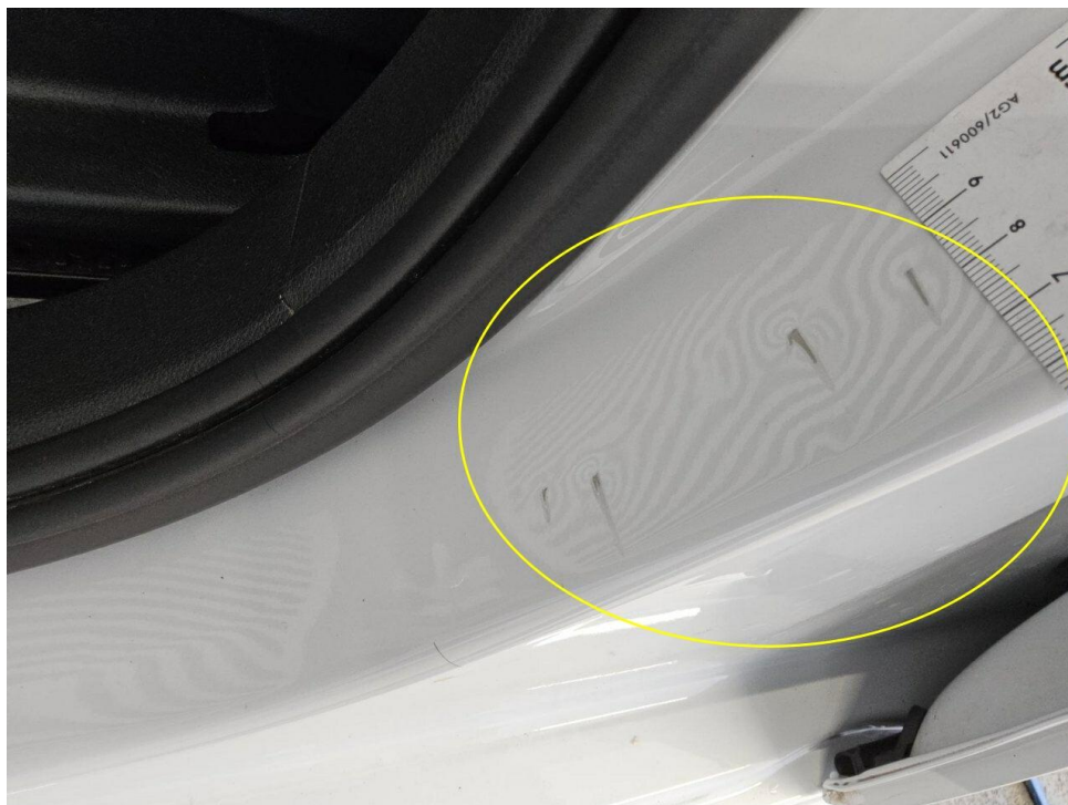
Bild 21 : Tür vorne links Einstieg, eingedellt, smart repair
