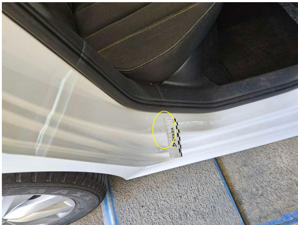
Bild 16 : Tür hinten rechts Einstieg, zerkratzt, smart repair
