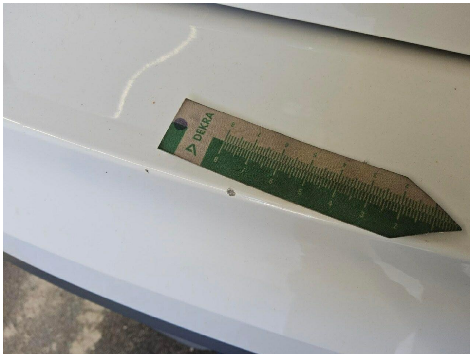
Bild 19 : Stoßfänger hinten Lackierung, zerkratzt, Gebrauchsspur
