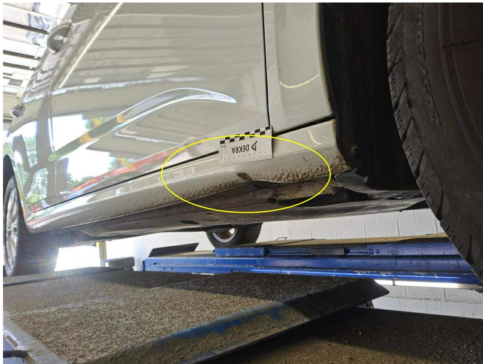
Bild 14 : Seitenschweller rechts, eingedellt, instandsetzen und lackieren mit Lackaufbau
