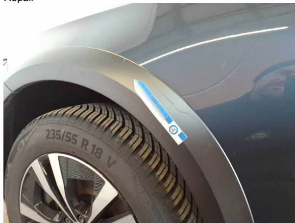
Beschädigung #6: Kotflügel links: Radhausverbreiterung - Kratzer - erneuern
