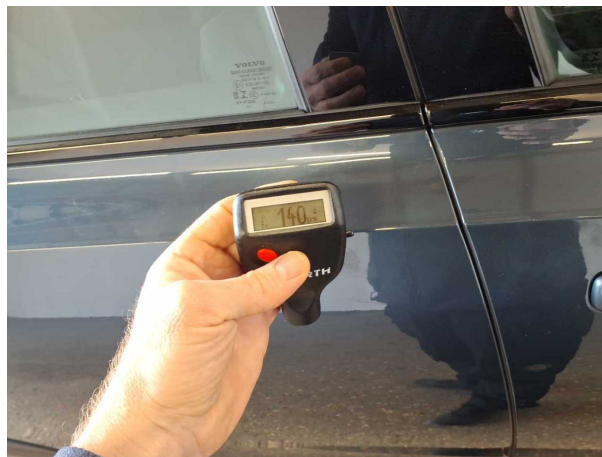
Nachlackierung 2: Tür hinten rechts
