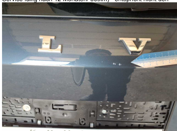
Beschädigung #11: Heckklappe/-tür: Heckklappe - Kratzer - lackieren
