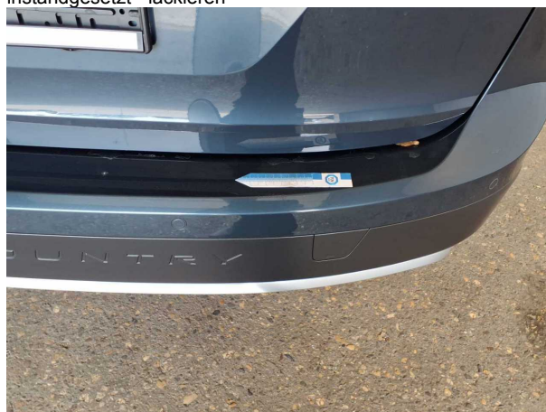
Beschädigung #9: Stossfänger hinten: Stossfänger hinten - Kratzer - lackieren
