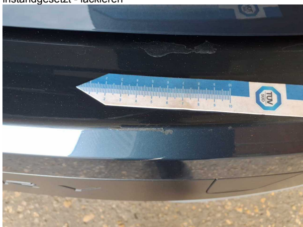
Beschädigung #9: Stossfänger hinten: Stossfänger hinten - Kratzer - lackieren
