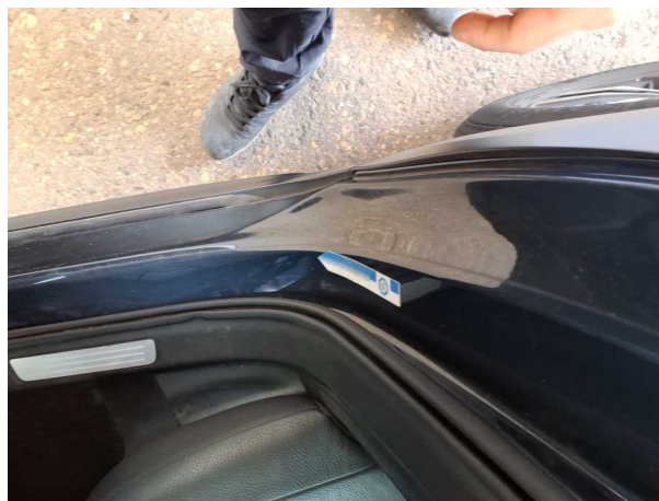
Beschädigung #5: Seitenwand rechts: Einstieg - Kratzer - Smart Repair
