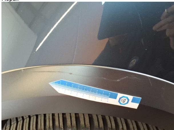
Beschädigung #6: Kotflügel links: Radhausverbreiterung - Kratzer - erneuern
