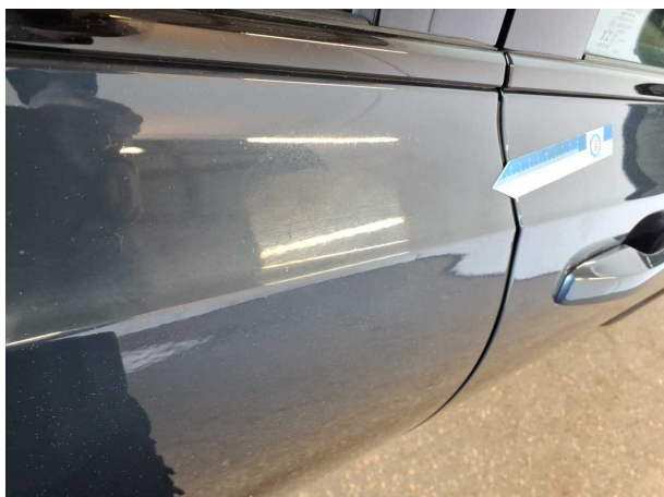
Beschädigung #8: Tür hinten rechts: Tür - nicht fachgerecht instandgesetzt - lackieren
