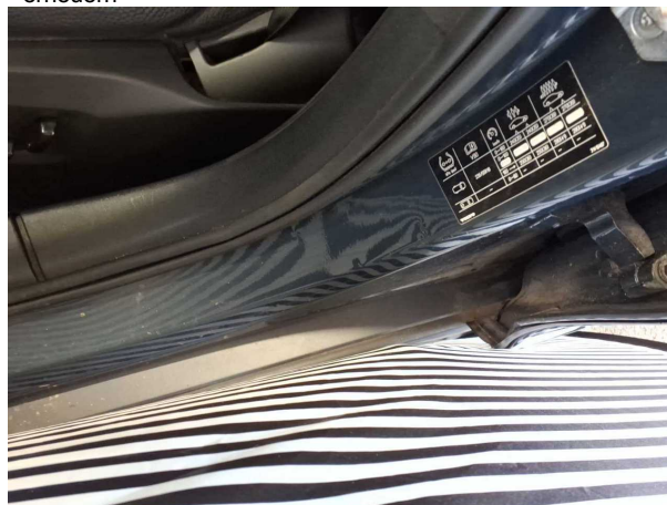
Beschädigung #7: Schweller links: Einstieg - Delle(n) - Smart Repair
