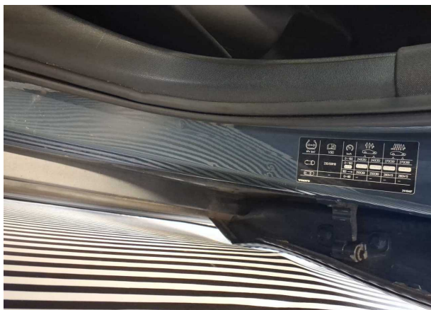
Beschädigung #7: Schweller links: Einstieg - Delle(n) - Smart Repair
