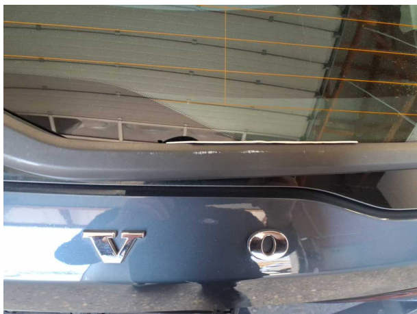
Beschädigung #4: Scheibenreinigung: Scheibenwischerarm hinten - Kratzer - erneuern
